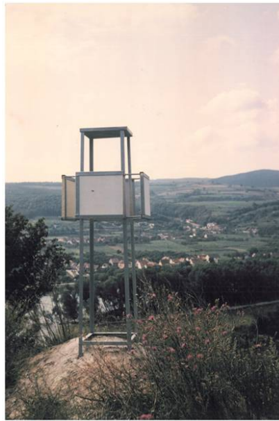
Abbildung 3.5: Hageltestplatte im Raum Gleisdorf-Weiz, vier nach den Himmelsrichtungen ausgerichtete vertikal befestigte Platten und eine Deckplatte. Foto von Otto Svabik.
