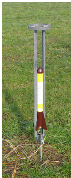
Abbildung 2.9: Hagelabwehrrakete der Hamberger Hans AG. Steighöhe ca. 1500 m, Silberjodid 15 g, Länge 520 mm, Gesamtgewicht 890 g.
