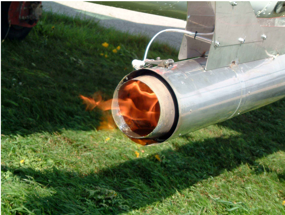
Abbildung 2.11: AgJ-Azeton-Brenner in Betrieb. Foto zur Verfügung gestellt von F. Gruber.
