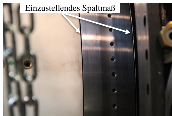
Abbildung 4-71: Spalt zwischen der Innenkontur, dem Laufrad und der Halbkugel bei waagrechter Maschinenachse
