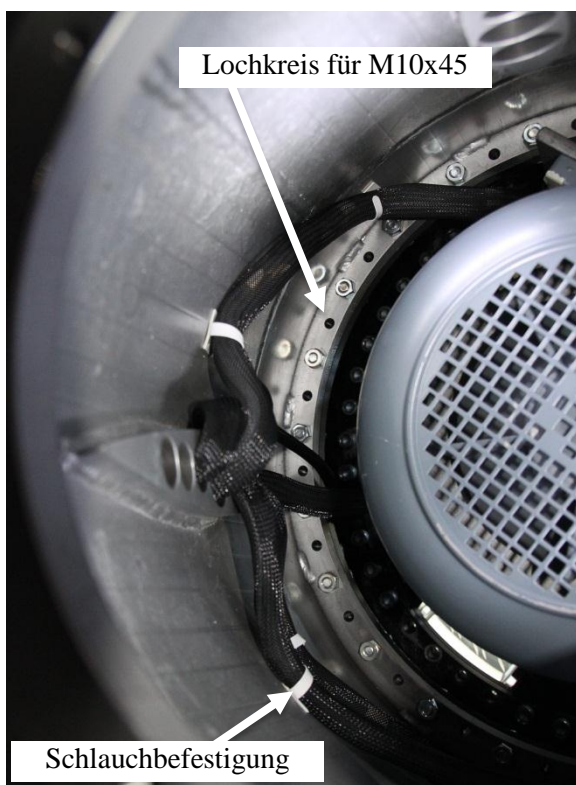
Abbildung 4-36: Druckschläuche und Verschraubung von Innenkontur und Diffusor in der Ansicht von innen
