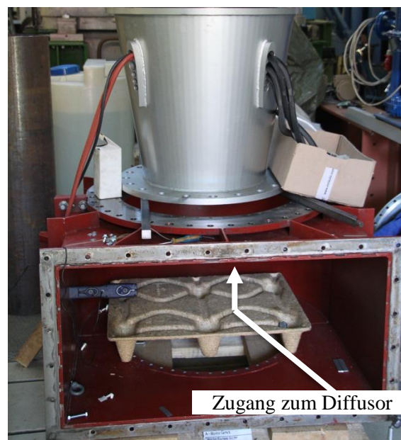
Abbildung 4-7: Aufstellen des Diffusors auf das Abluftgehäuse
