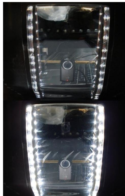
Abbildung 4-30: Helligkeitsunterschied zwischen 6 V und 12 V
