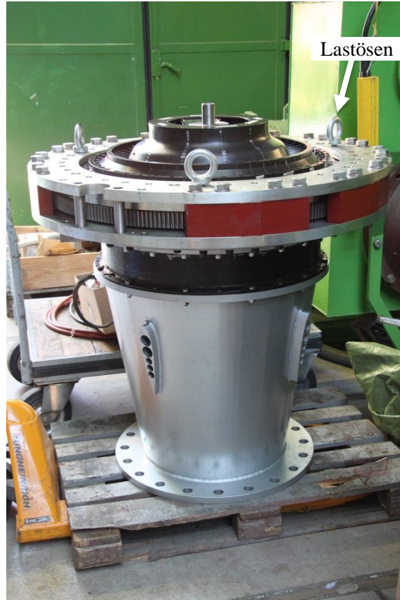
Abbildung 4-53: Darstellung der fertig aufgebauten Drehvorrichtung mit den eingesetzten Lastösen zum Anheben
