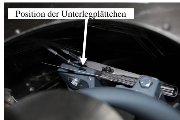
Abbildung 4-39: Position der Unterlegplättchen zur Einrichtung des Motors
