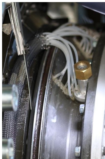
Abbildung 4-68: Distanzmessung zwischen Drehvorrichtung und Einlauf
