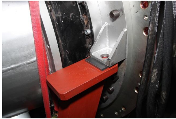
Abbildung 4-85: Unterlegscheiben für die Höheneinstellung am \lambda -Träger
