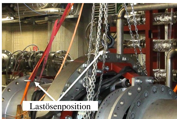
Abbildung 4-82: Position des Lasthaken und des Zurrgurtes
