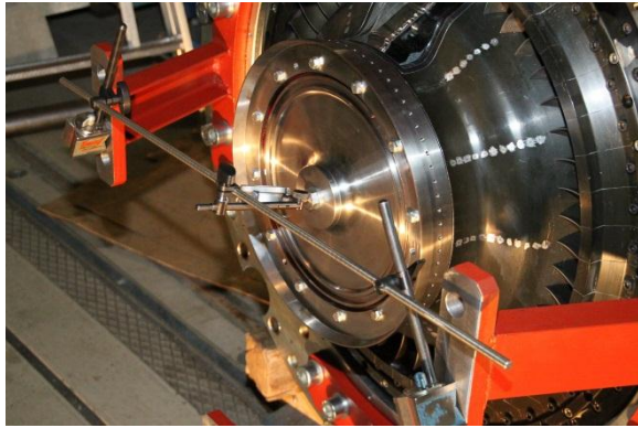
Abbildung 4-72: Messuhrensetup für Motorachsversetzung im Betrieb
