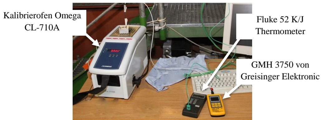
Abbildung 4-17: Darstellung der Temperaturkalibrierung
