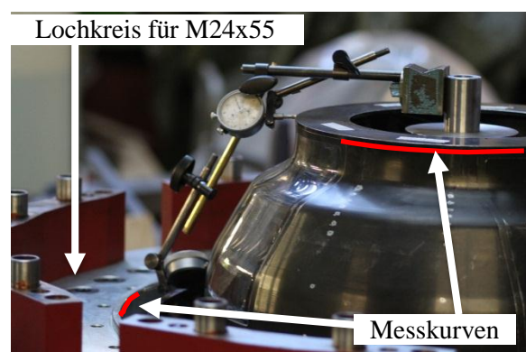
Abbildung 4-44: Zentrierung der hinteren Befestigungsplatte gegenüber dem Motor
