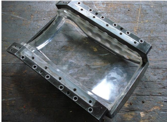
Abbildung 4-22: Einbau der Plexiglasscheibe
