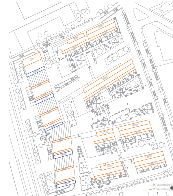
Draufsicht mit Darstellung der Photovoltaik und Solarmodule
