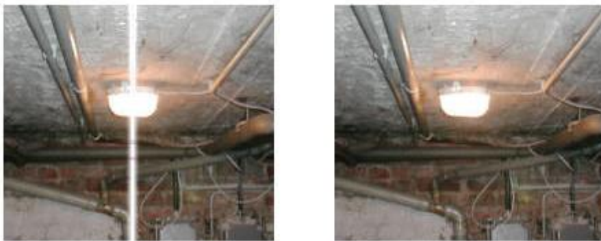
Abbildung 4.3: Beispiel zum Smear Effekt 4
