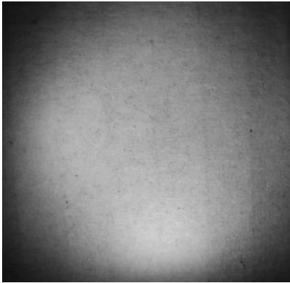
Abbildung 6.17: Ausleuchtung mit einer Leuchtdiode je Seite
