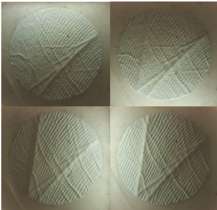
Abbildung 7.7: Hautabdruck mit verschiedenen Beleuchtungsrichtungen
