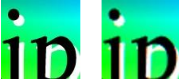
Abbildung 4.12: Nachteil durch die Farbinterpolation 11
