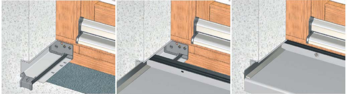
Abbildung 102: Befestigung einer Aluminium-Außenfensterbank 137
