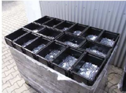
Abbildung 31: Getestete Referenzpalette mit ESD-Behältern [30]
