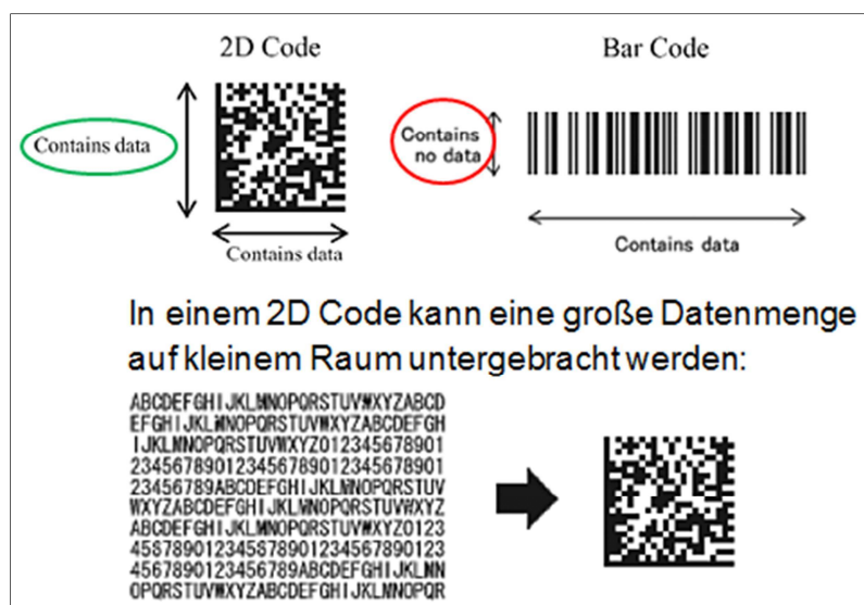
Abbildung 3: Codierbare Datenmengen bei ein- und zweidimensionalen Codes
