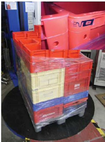
Abbildung 29: Getestete Referenzpalette mit Standardbehältern [30]
