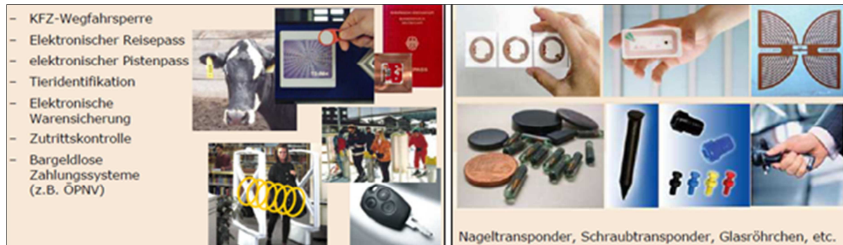
Abbildung 14: Einsatzgebiete und Bauformen von Transpondern [19]
