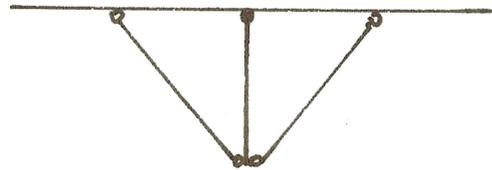
zur Stabilisierung des Hauptgesperres
