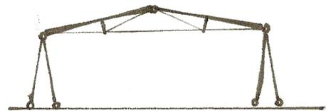
Statisches System - mit Unterspannungen
