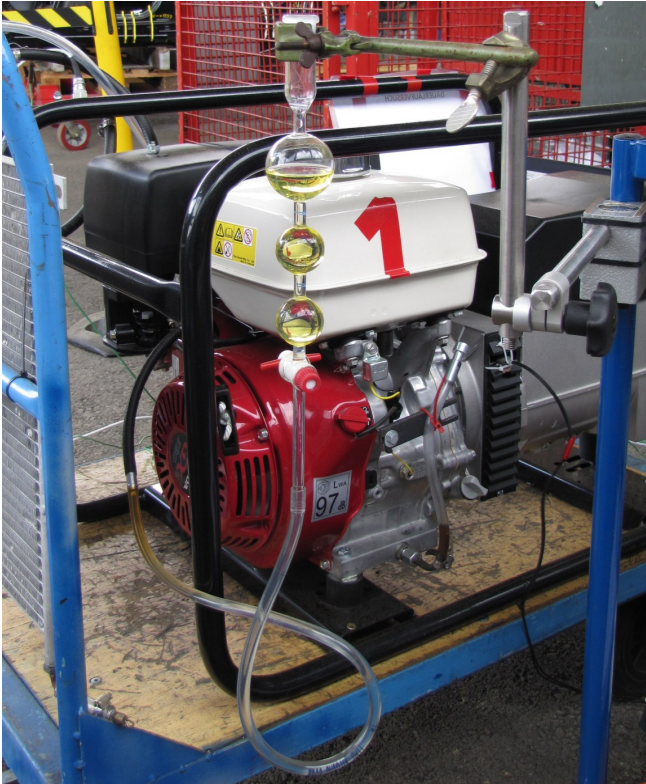
Bild 3.11 Verbrauchsmessung im Betrieb
