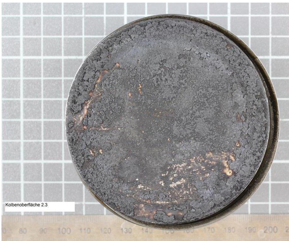
Bild 6.9 Ablagerungen am Kolbenboden
