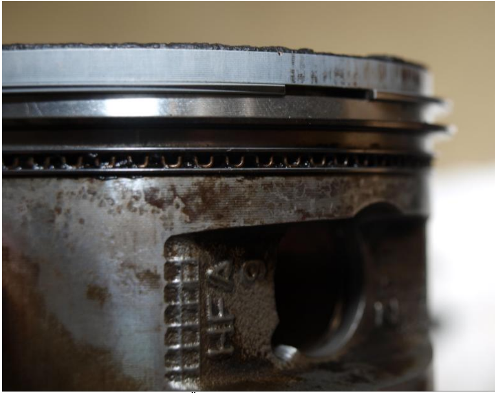
Bild 6.8 Feststeckender Ölabbstreifring am Kolben [16]
