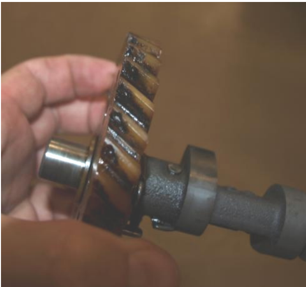
Bild 6.12 Pittings am Kunststoffzahnrad des Ventiltriebs [16]
