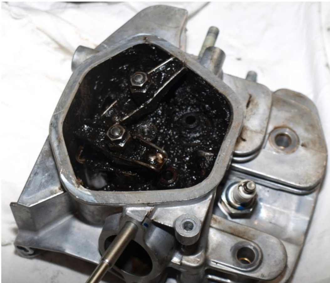
Bild 6.10 Verdicktes Schmiermittel am Ventiltrieb im Zylinderkopf [16]
