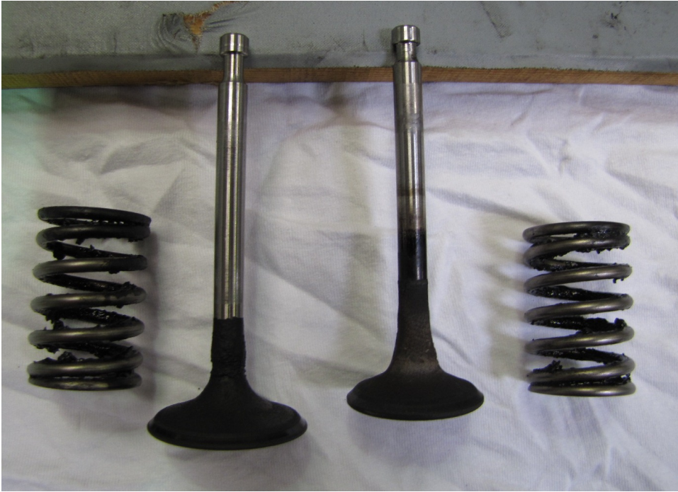
Bild 6.11 Ventile mit Ablagerungen von Verbrennungsrückständen
