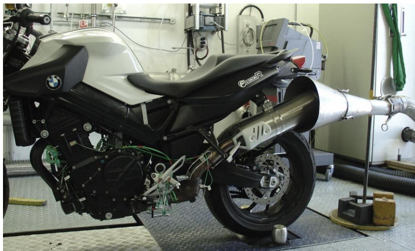
Abbildung 6.45: Abgasabsaugung am 2-Rad-Rollenprüfstand mittels Trichter
