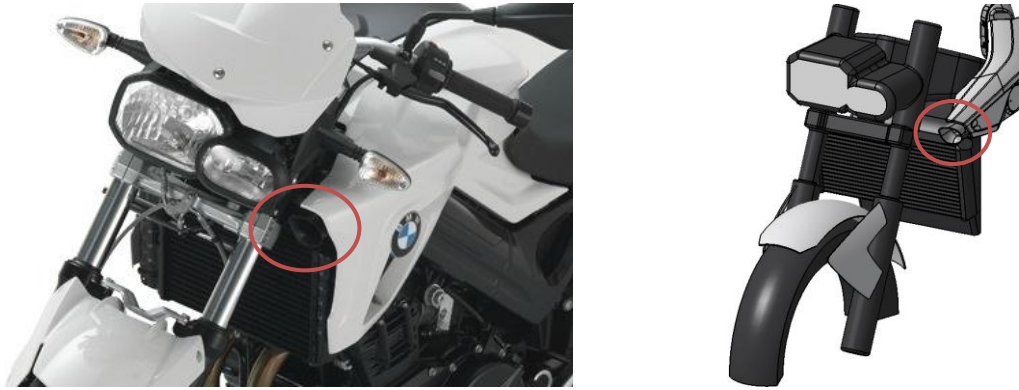
Abbildung 6.35: Ansaugluftöffnung BMW F800R [9] und CAD-Modell
