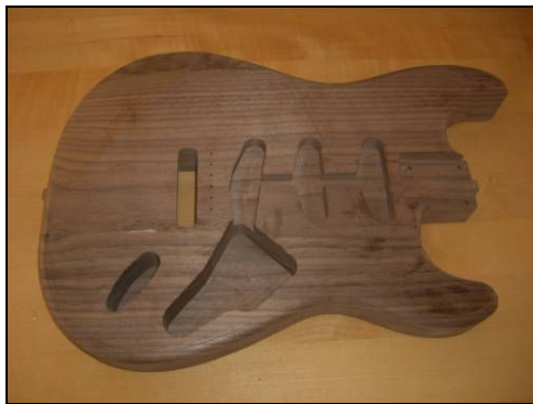
Gitarrenkorpus Material: Schwarznuss Maße [mm]: 480 x 320 x 45
