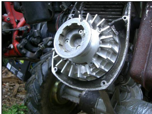
Ventilator Balkenmäher Material: Aluminium Maße [mm]: \varnothing 126 x 37
