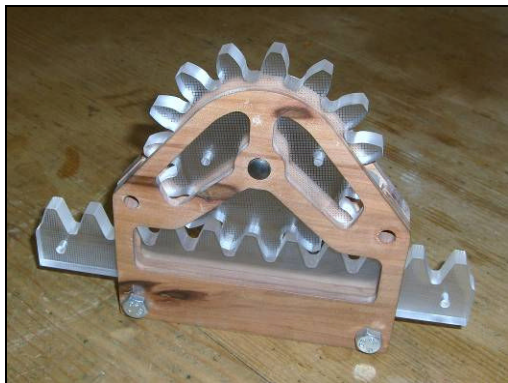
Zahnrad & Zahnstange Material: Birne, Acrylglas Maße [mm]: 180 x 120 x 20
