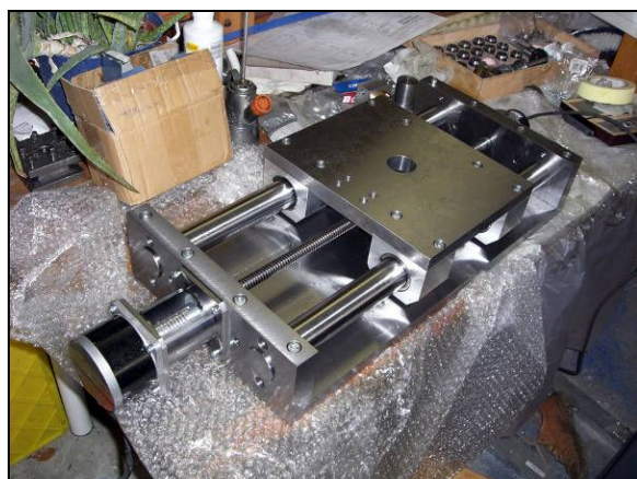
Abb. 23: Grundaufbau der Achsen (im Foto die Z-Achse)
