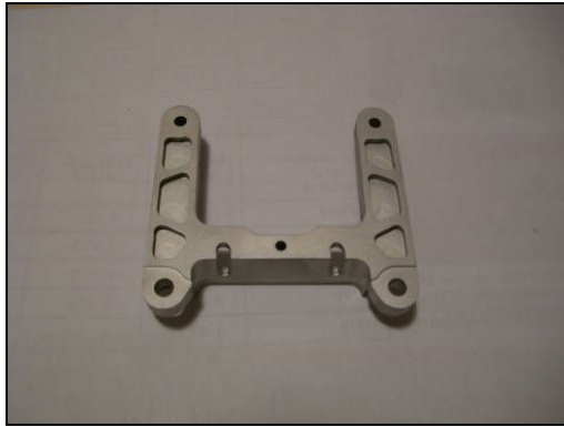
Radaufhängung Modellfahrzeug Material: Aluminium Maße [mm]: 55 x 62 x 12
