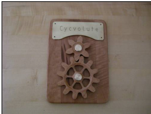
Schautafel Cycvolute (Sonderverzahnung) Material: Birne, Messing Maße [mm]: 300 x 200 x 30
