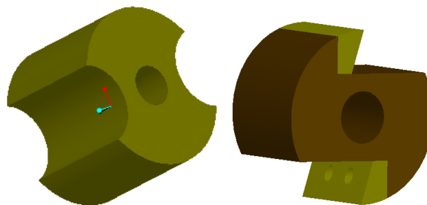
Abbildung 7-6: Zellrad mit runder Kammer (links) und mit dreieckiger Kammer (rechts)
