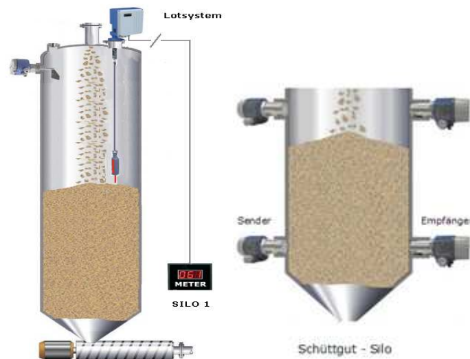
Abbildung 7-11: Messung mit elektromechanischen Lotsystemen (links ) und Messung mit Mikrowellen (rechts) [63]
