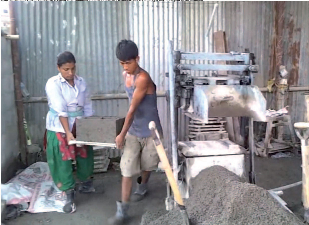
Bild-unten: mit einem einfachen System (Fa. Gandaki-Pokhara) stellen Kleinbetriebe Betonziegel her; Fotograf nicht bekannt
