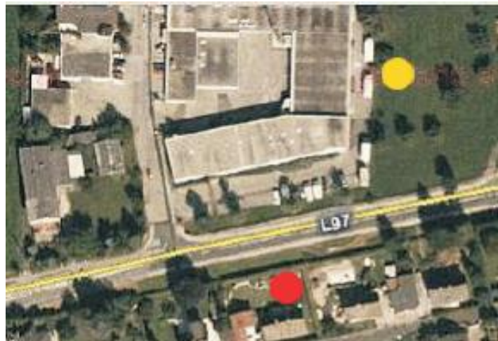
Abbildung 9: Luftbild der Keutschacherstraße mit Hintergrundstation (gelb) und straßennaher Station (rot) (33)
