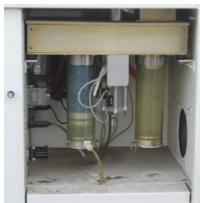
Abbildung 33: Ansicht des Low Volume Samplers von Innen (41)
