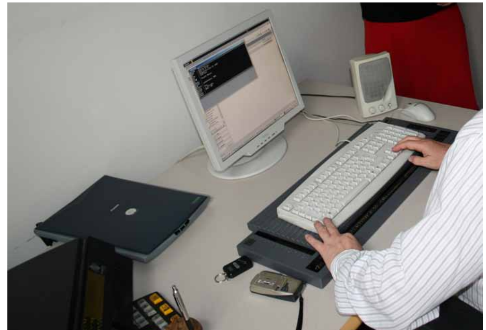
Bild 7: Behindertengerecht adaptierter Blindenarbeitsplatz mit Braillezeile als Ergänzung zur Tastatur
