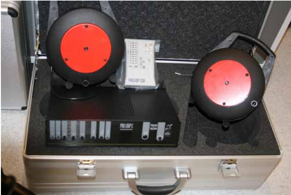
Bild 21: Mobile induktive Höranlage mit 2 Spulen zur Verlegung von den Induktionsschleifen
