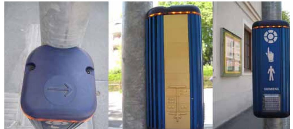
Bild 16: Akustikampel für blinde Menschen gibt zusätzlich taktile Informationen an, z.B. ganz links: Gehrichtung mit Pfeil, mitte: um wie viele Fahrbahnstreifen handelt es sich
