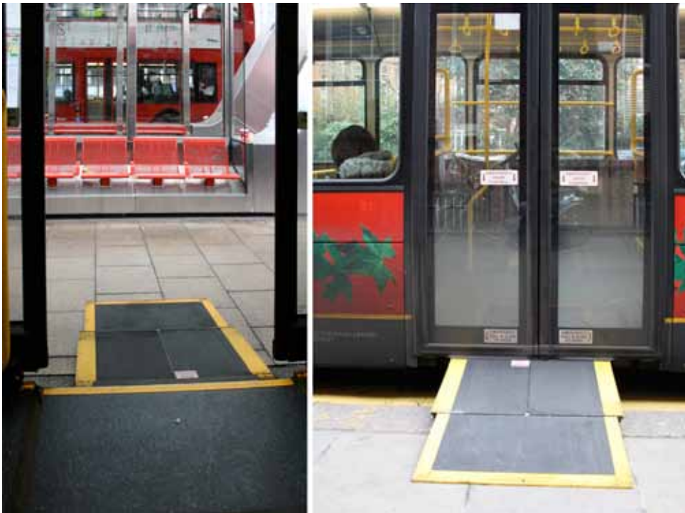
Bild 31: Rampe bei einem Linienbus in London. Leider sind automatische Rampen sehr oft defekt und sollten eher durch mechanische Klapprampen ausgetauscht werden.
