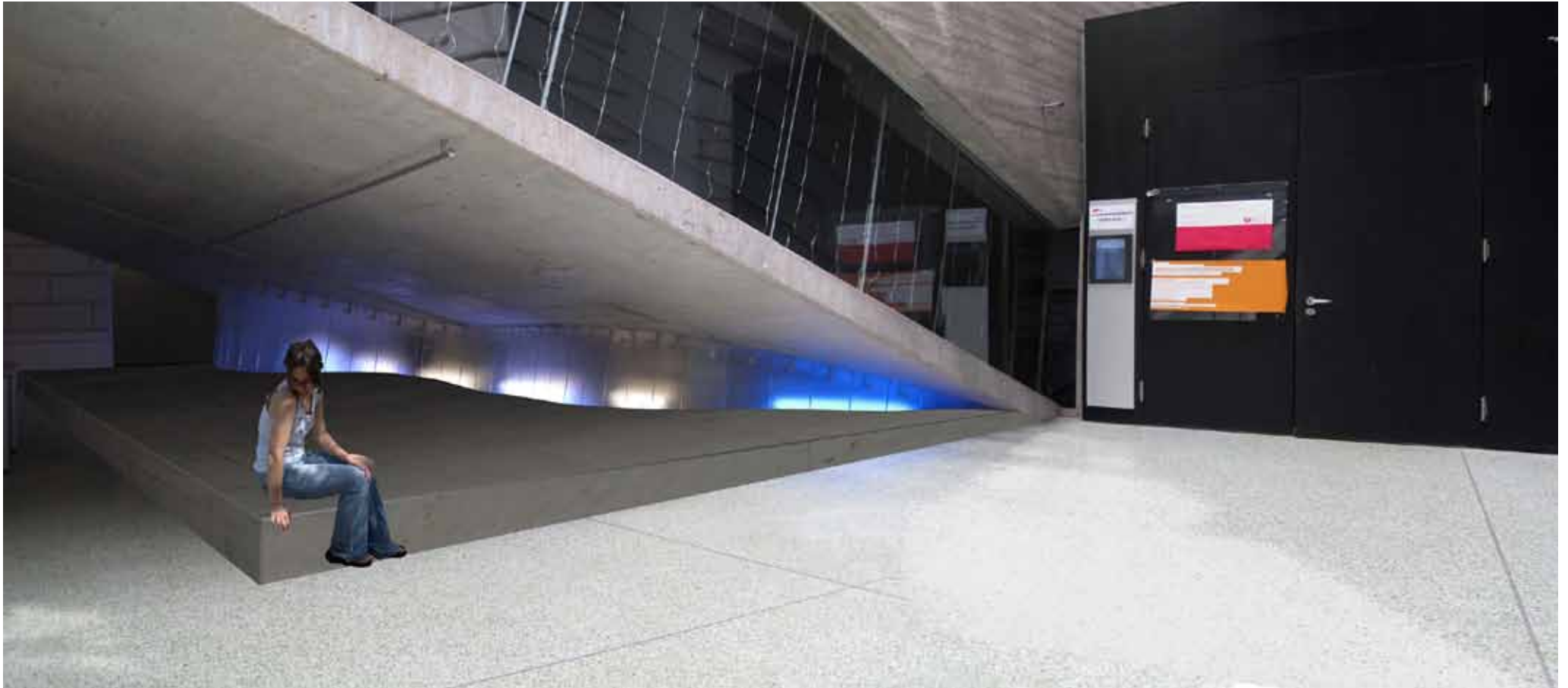
Bild 70: Das Podest ist Tastkante für Menschen mit einem Taststock, Sitzgelegenheit und Podest für Ausstellungen zugleich.
