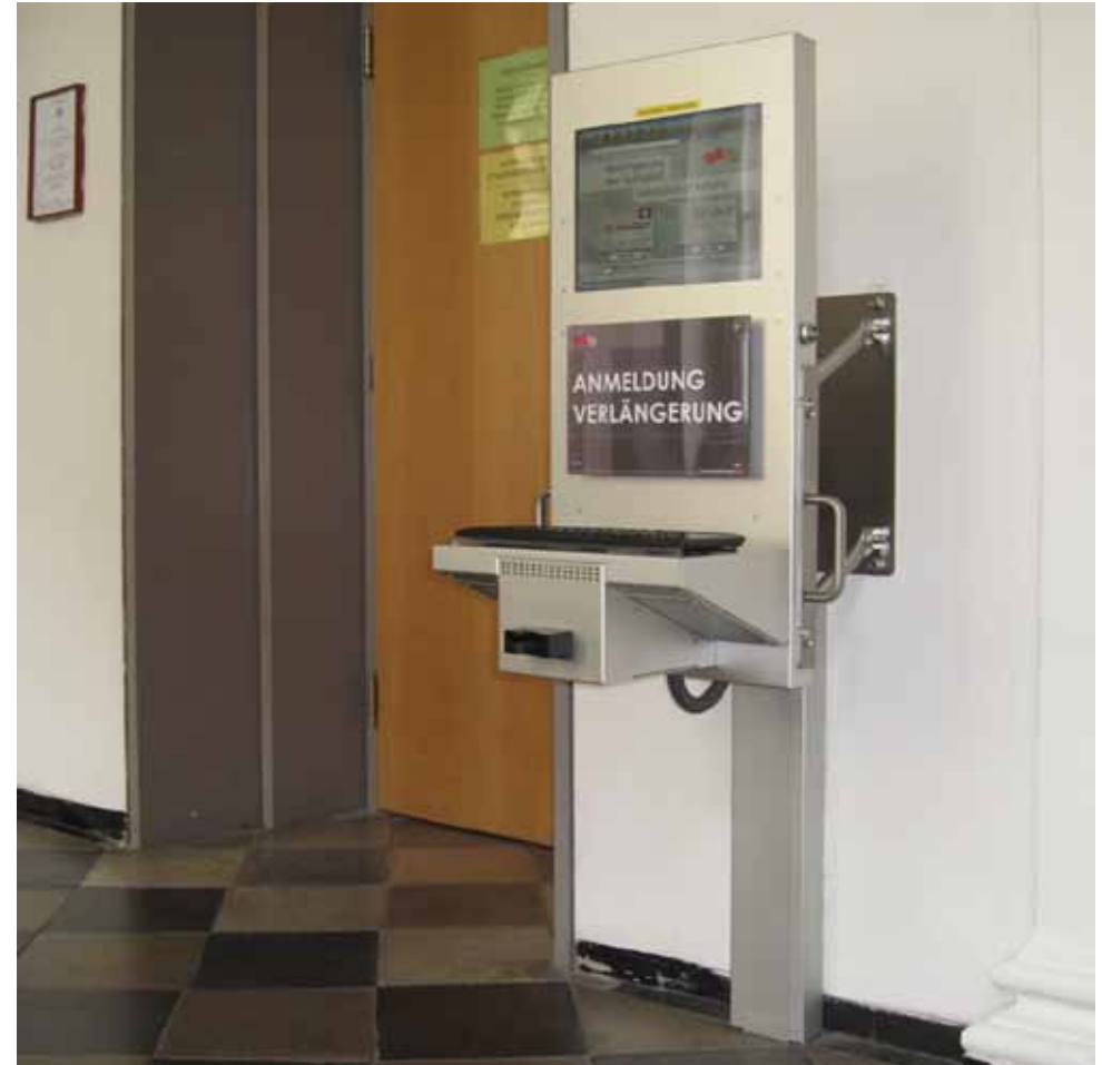
Bild 105: Das „barrierefreie“ PC-Terminal des ZID entspricht nicht der ÖNORM B 1600 und ist nicht barrierefrei bedienbar
