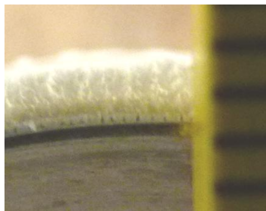
Abbildung 5.37: Detailansicht auf die Depositionsschicht bei der Temperatur T1 am Ring, drei erkennbare Deposchichten Nahaufnahme, mit Millimeterstab.
