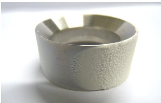
Abbildung 5.32: Depositionsring mit Depositionsschicht, Detailansicht Ring Seitenansicht. Gut erkennbar ist der Übergang von der LUV Seite zur LEE Seite.
