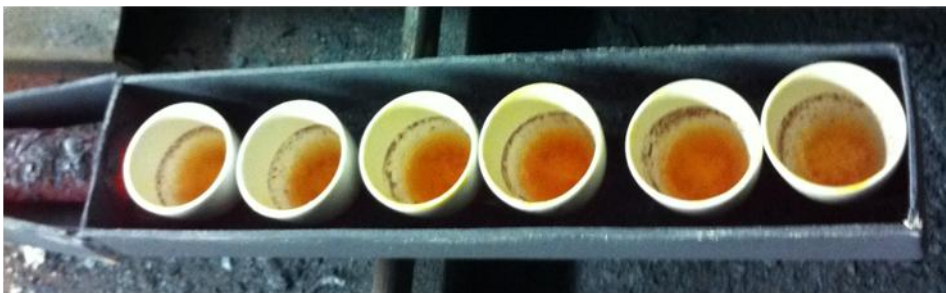
Abbildung 3.16: Neues Stahlgefäß, und größere Tiegel bei der Herausnahme aus der Anlage mit teilweise noch flüssigem Kaliumchlorid.
