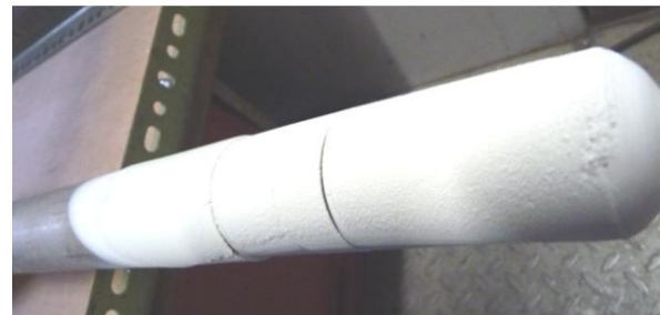
Abbildung 5.31: Depositionssonde mit Depositionsschicht, Ansicht von oben.
