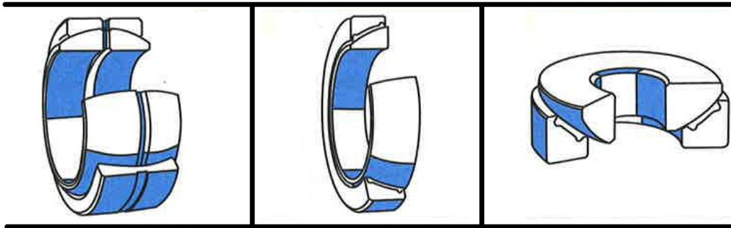
Abbildung 4.3: Gelenklagertypen von links nach rechts: Radialgelenklager, Schräggelenklager und Axialgelenklager, Quelle: [7, Seite 44]
