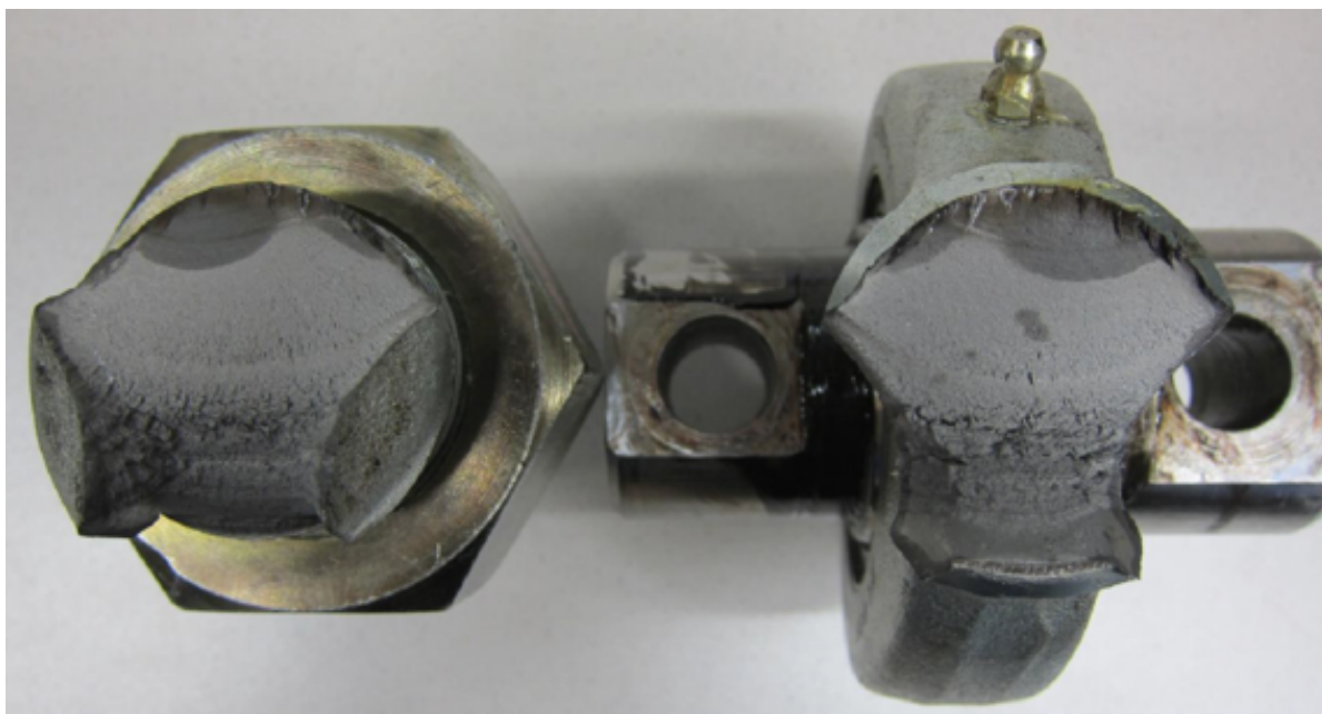
Abbildung 2.1: Bruch eines Radialgelenkkopfes bei nicht bestimmungsgemätem Einsatz in einem Ermüdungsversuch.
