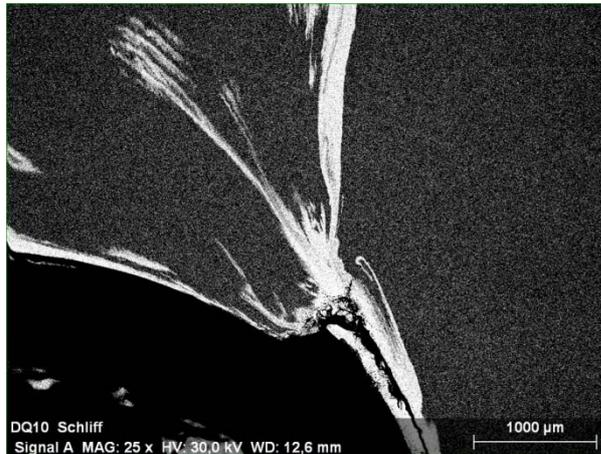
Abbildung 8-41: Wolframabrieb hinter dem Pin Im REM
