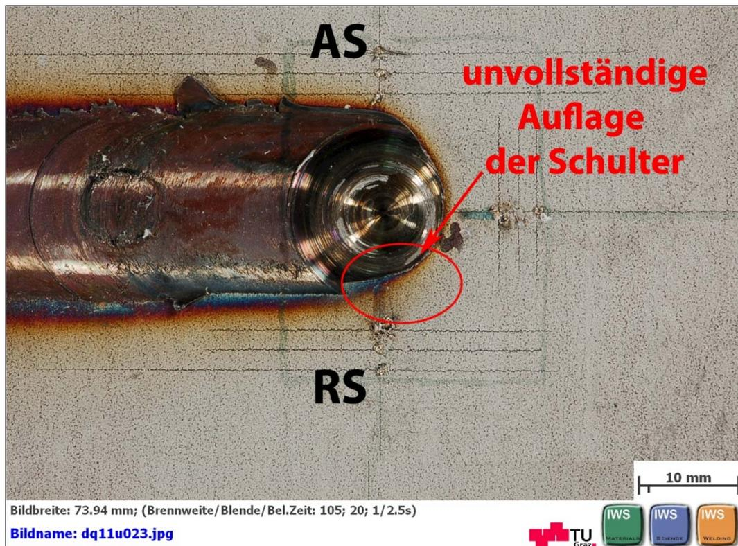
Abbildung 8-10: Unvollständige Auflage der Schulter auf der RS bei der Schweißung S003
