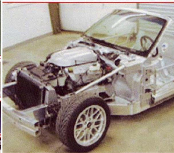
Abbildung 4-11: FSW-geschweißter Alu-Spaceframe bei einem Panoz Esperante [12]
