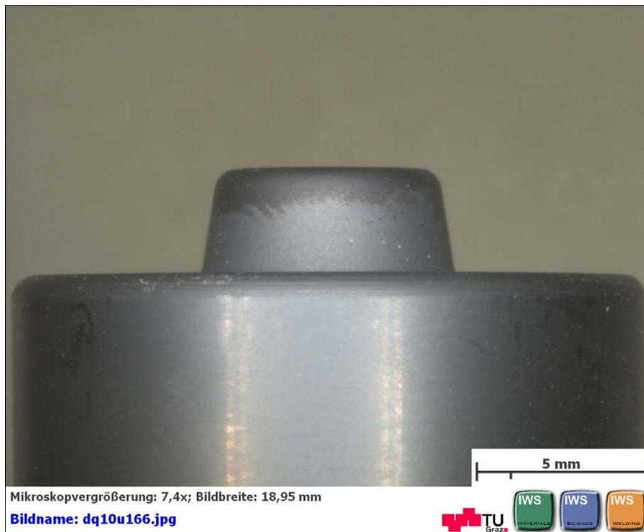
Abbildung 4-6: Werkzeug für Stahlschweißung
