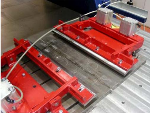
Abbildung 5-2: Pneumatische Spannvorrichtung
