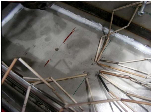
Abbildung 6-2: Probenblech mit Thermoelementen
