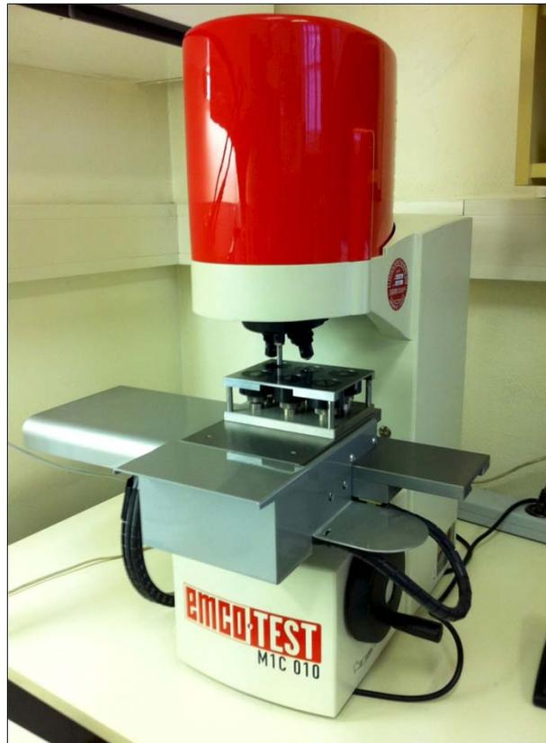
Abbildung 5-11: automatisches Härtemessgerät EMCOTest M1C 010
