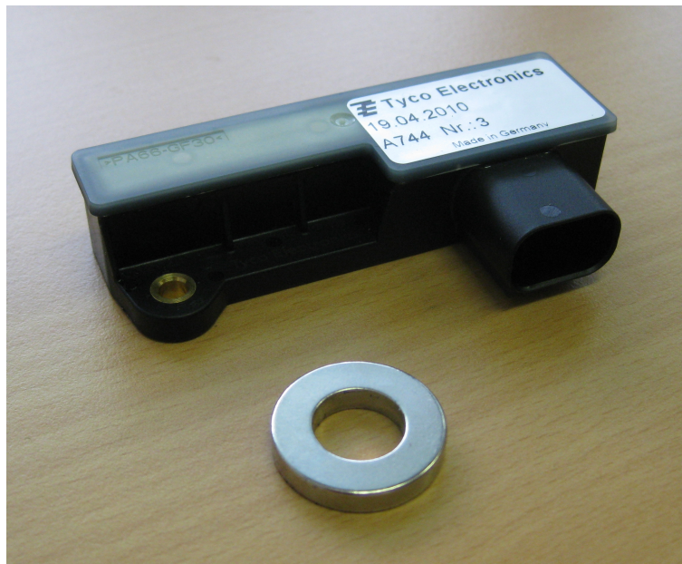
Abbildung 4.14.: Wegsensor Tyco PLCD 50 mit Ringmagnet
