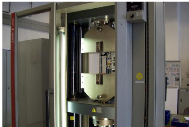
Abbildung 19 : Universalprüfmaschine Zwick Z250 [35]
