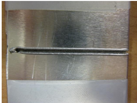
Abbildung 49 : „Schweißnaht“ an einer Al-Al Schweißverbindung bei einem Fügespalt von 0,5 mm
