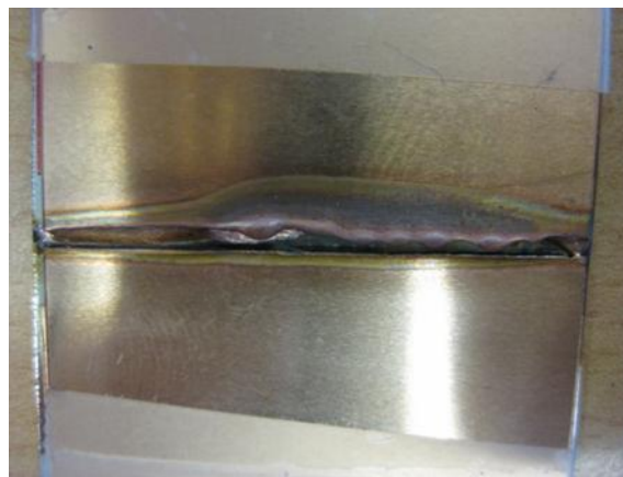
Abbildung 51 : „Schweißnaht“ an einer CuSn6-Cu(Ni) Schweißverbindung bei einem Fügspalt von 0,3 mm
