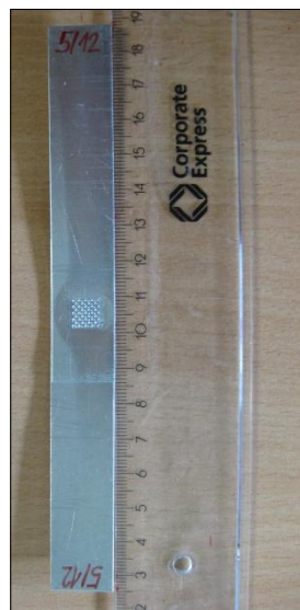
Abbildung 17 : Sichtprüfung an einer ultraschallgeschweißten Al-Al Schweißverbindung
