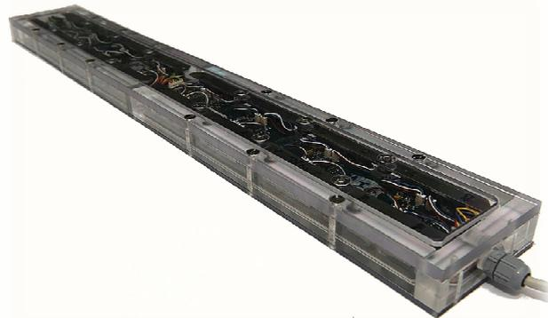
Abb. 22: Sensormodul mit Grund und Abdeckplatte
