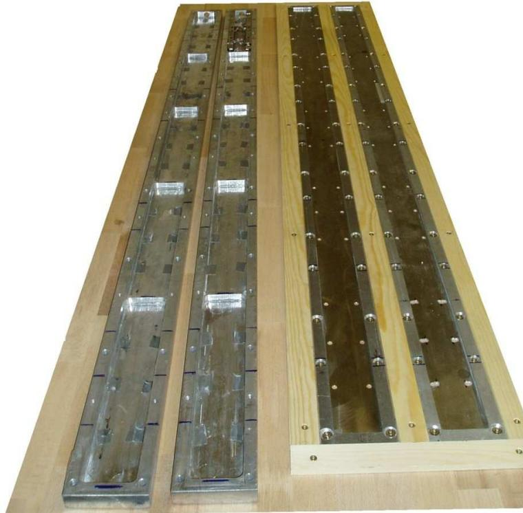
Abb. 17: Zwei Sensorwannen (links) mit Abdeckrahmen (rechts)
