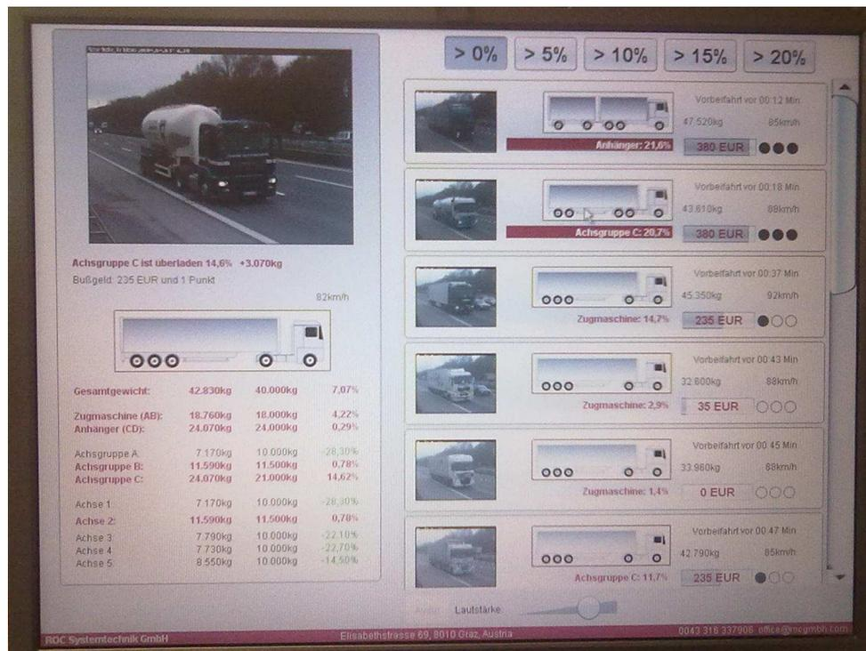
Abb. 85: Vollautomatische Überladungskontrolle
