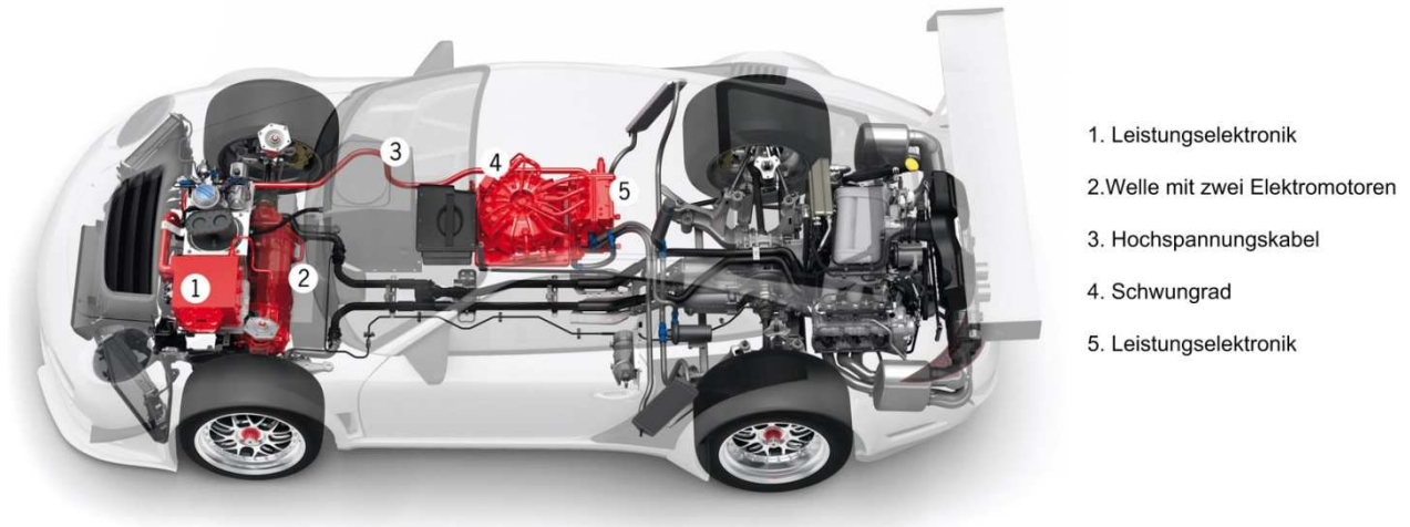
Abbildung 15: Schwungradspeicher im Rennfahrzeug: Schnitt durch den Porsche GT3 Hybrid (20)
