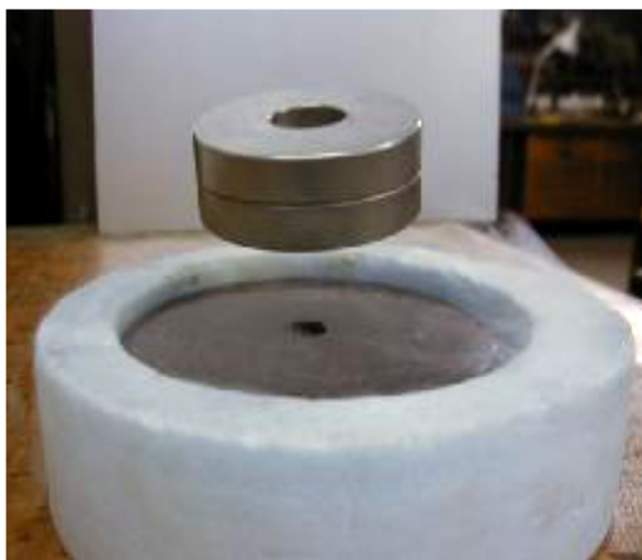
Abbildung 24: Schwebender Magnet über gekühltem Supraleiter (links) und aktives Magnetlager (rechts) (31)
