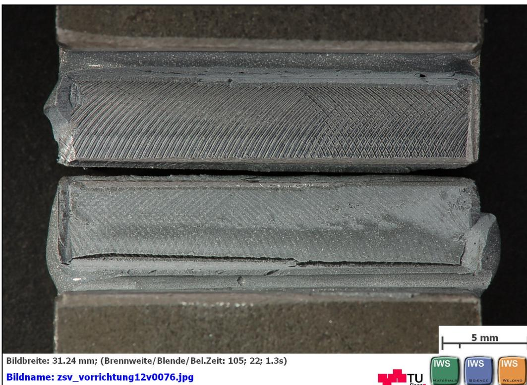
**Abbildung C 84: geklebte Flächen nach dem Zugscherversuch nach EN 14869-2 mit DELO: DELOMONOPOX® 1197 Rautiefe Ra3,2 Probe 2 von 5**
