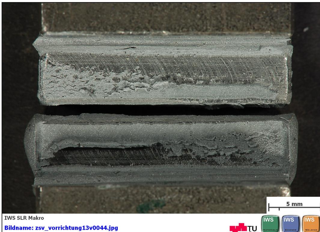
**Abbildung C 28: geklebte Flächen nach dem Zugscherversuch nach EN 14869-2
