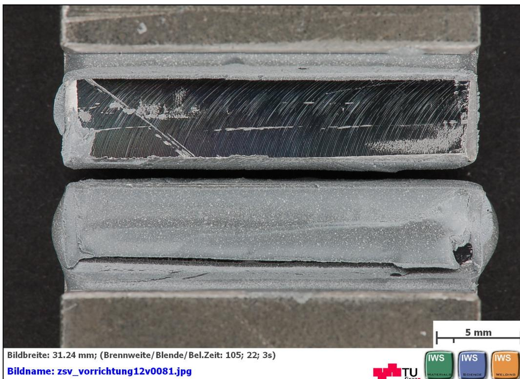
**Abbildung C 94: geklebte Flächen nach dem Zugscherversuch nach EN 14869-2
