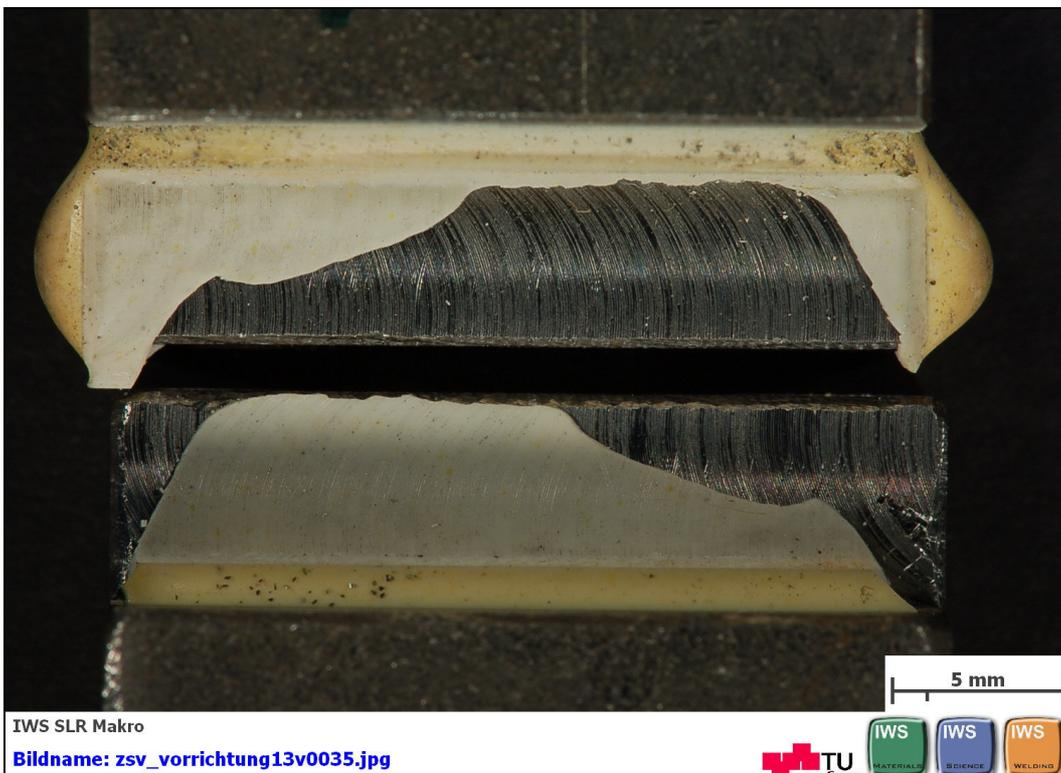
**Abbildung C 10: geklebte Flächen nach dem Zugscherversuch nach EN 14869-2
