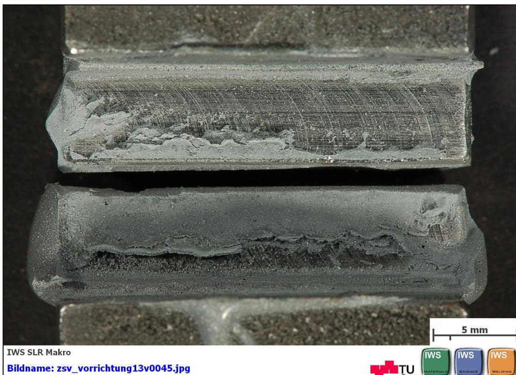
**Abbildung C 30: geklebte Flächen nach dem Zugscherversuch nach EN 14869-2
