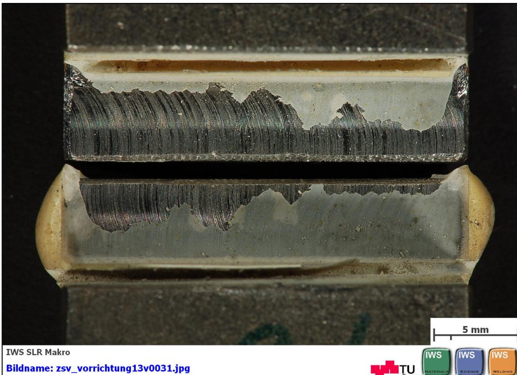
**Abbildung C 2: geklebte Flächen nach dem Zugscherversuch nach EN 14869-2
