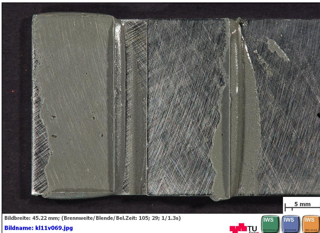
**Abbildung B 38: geklebte Flächen nach dem Zugscherversuch nach EN 1465 mit HENKEL: HYSOL® EA 9394/C-2 Probe 4 von 5**
