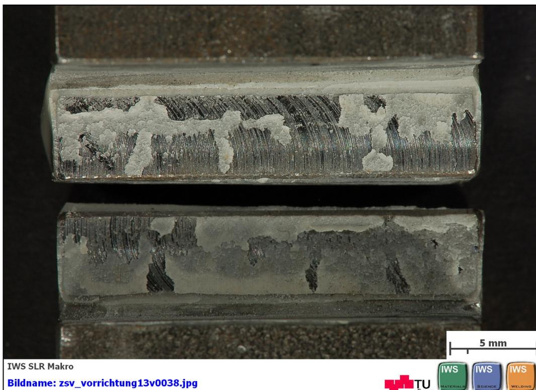
**Abbildung C 16: geklebte Flächen nach dem Zugscherversuch nach EN 14869-2
