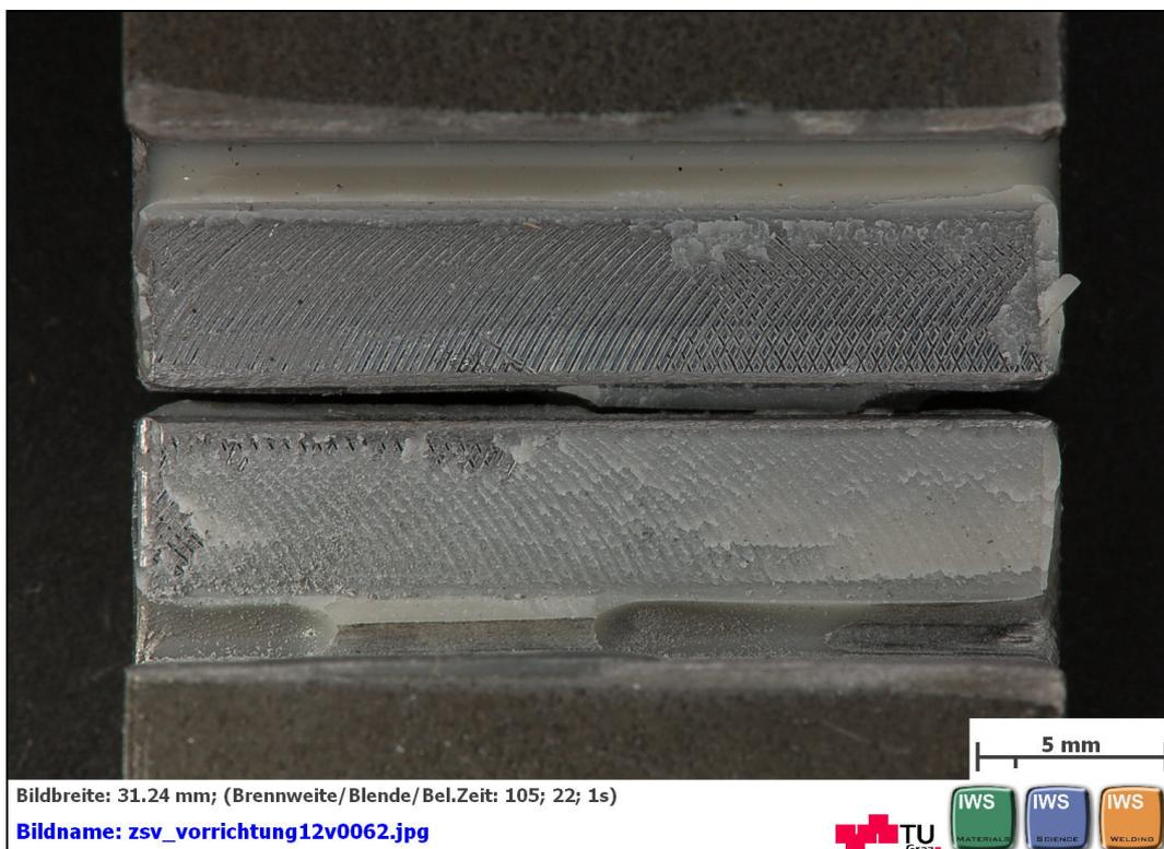
**Abbildung C 56: geklebte Flächen nach dem Zugscherversuch nach EN 14869-2 mit DELO: DELOMONOPOX® AD295 Rautiefe Ra3,2 Probe 3 von 5**
