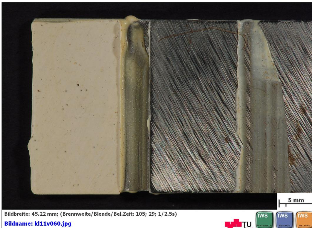
**Abbildung B 20: geklebte Flächen nach dem Zugscherversuch nach EN 1465 mit 3M: SCOTCH-WELD™ DP760 Probe 5 von 5**
