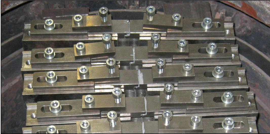
**Abbildung 61: Angefertigte Vorrichtung für Überlappungsklebungen für Dickblechscherversuche**
