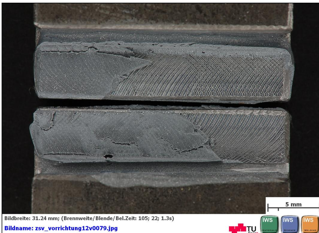
**Abbildung C 90: geklebte Flächen nach dem Zugscherversuch nach EN 14869-2 mit DELO: DELOMONOPOX® 1197 Rautiefe Ra3,2 Probe 5 von 5**
