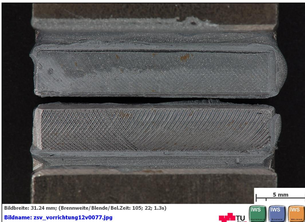
**Abbildung C 86: geklebte Flächen nach dem Zugscherversuch nach EN 14869-2
