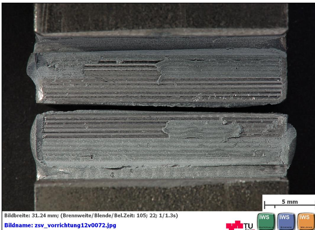
**Abbildung C 76: geklebte Flächen nach dem Zugscherversuch nach EN 14869-2 mit DELO: DELOMONOPOX® 1197 Rautiefe Ra6,3 Probe 3 von 5**
