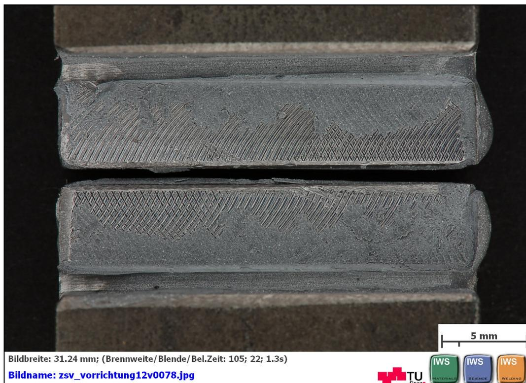
**Abbildung C 88: geklebte Flächen nach dem Zugscherversuch nach EN 14869-2
