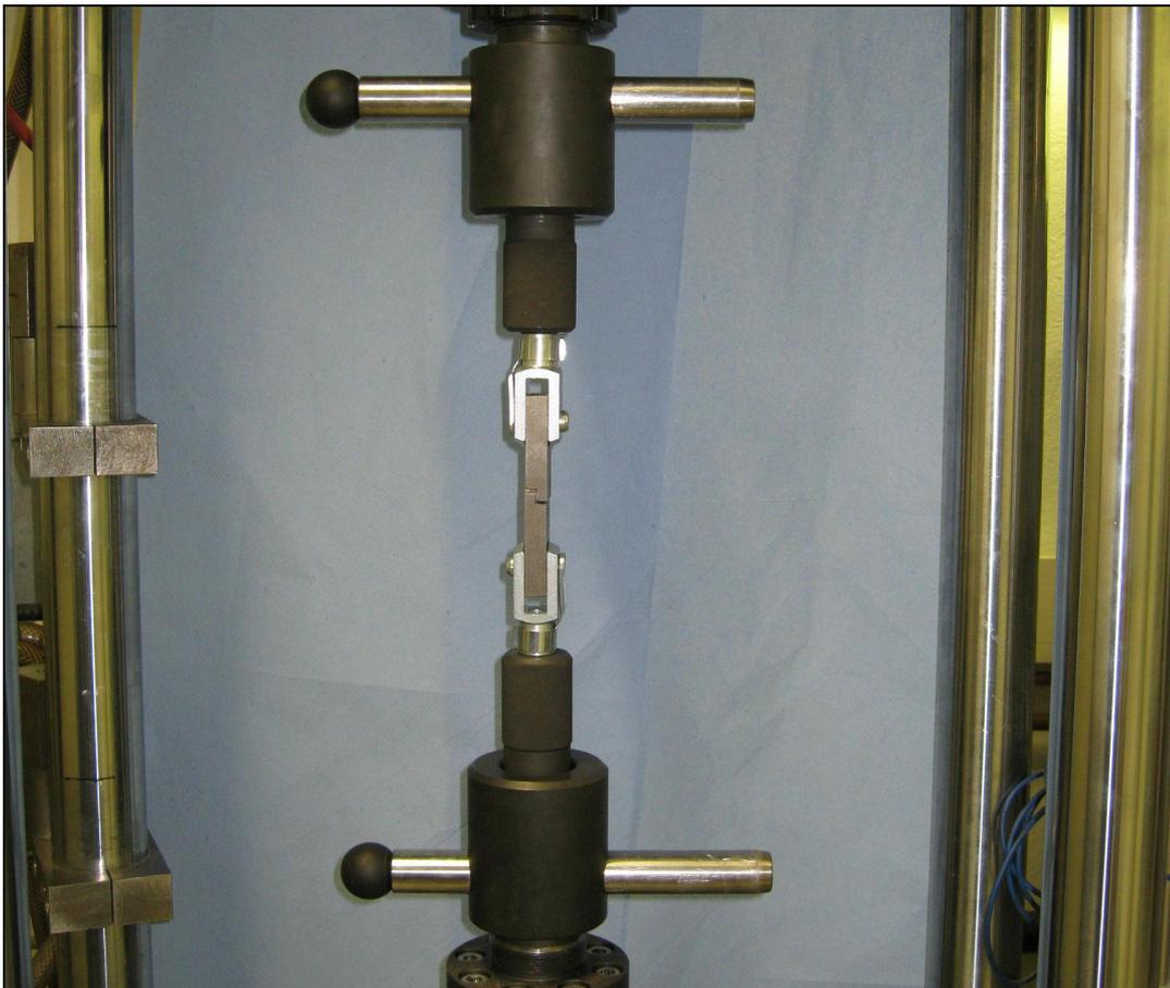
**Abbildung 62: Einlegen der Dickblech-Zugscherproben in die Vorrichtung der Zugprüfmaschine ZWICK/ROELL am IWS TU Graz**
