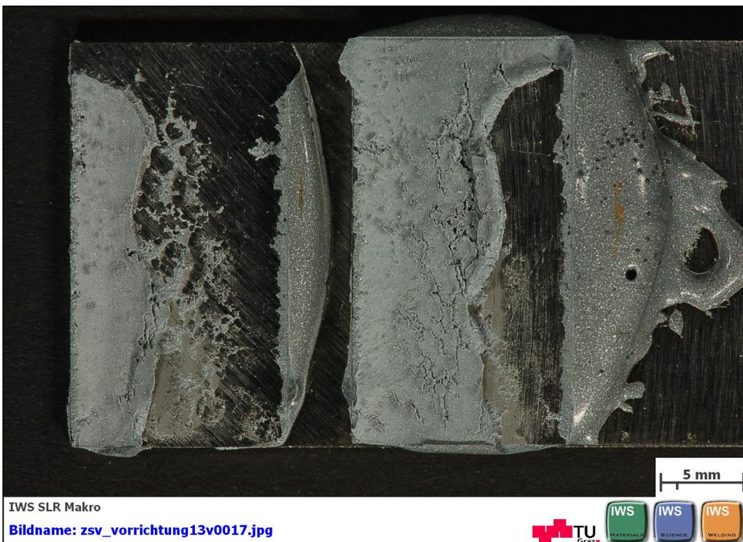
**Abbildung B 84: geklebte Flächen nach dem Zugscherversuch nach EN 1465 mit DELO: DELOMONOPOX® 1197 mit Glaskugeln zur Einhaltung des Klebespaltes Probe 2 von 5**
