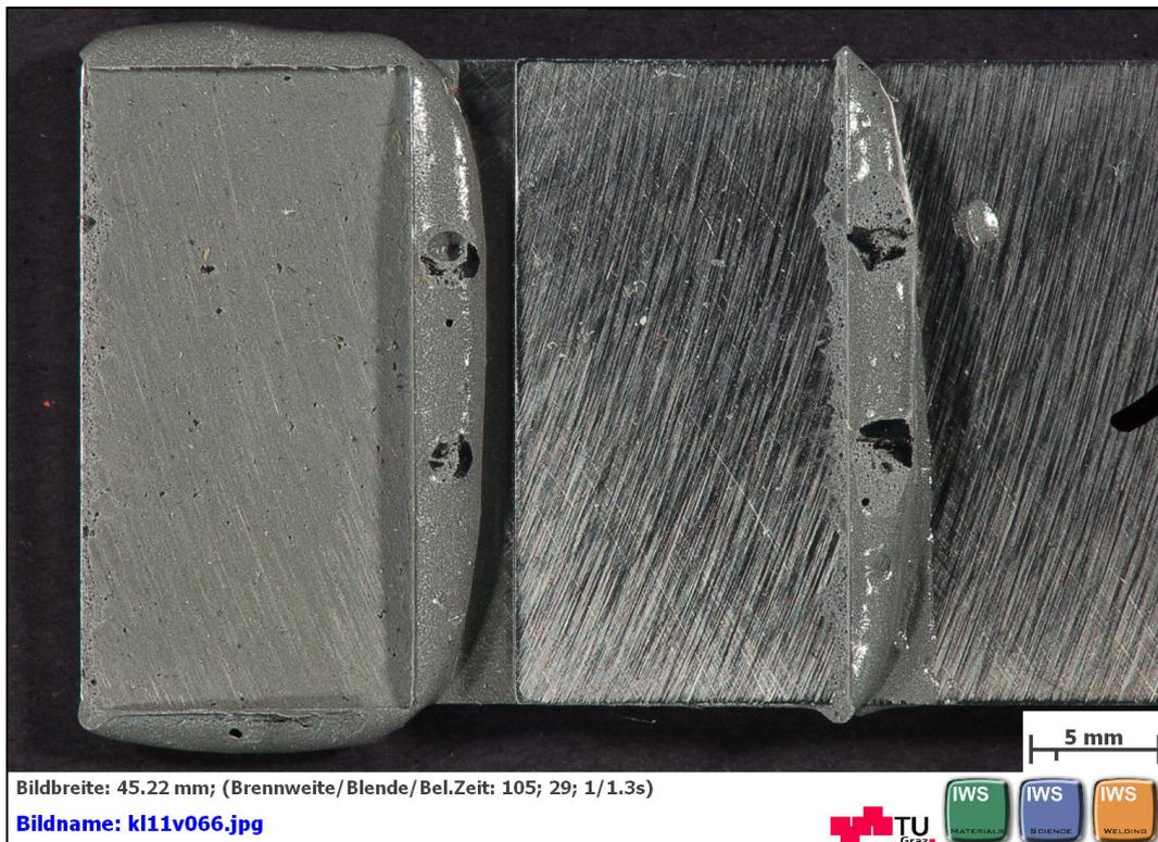
**Abbildung B 32: geklebte Flächen nach dem Zugscherversuch nach EN 1465 mit HENKEL: HYSOL® EA 9394/C-2 Probe 1 von 5**
