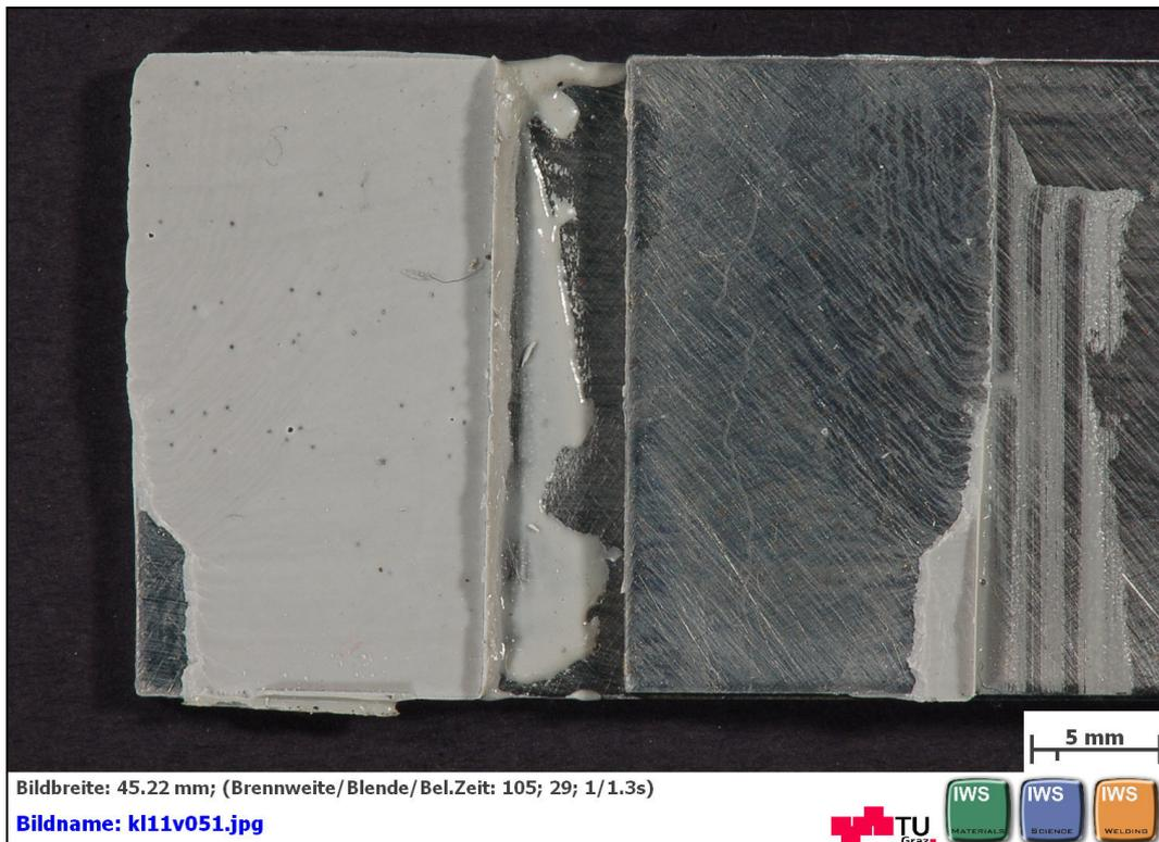
Abbildung B 2: geklebte Flächen nach dem Zugscherversuch nach EN 1465 mit HENKEL: HYSOL® 9497™ Probe 1 von 5
