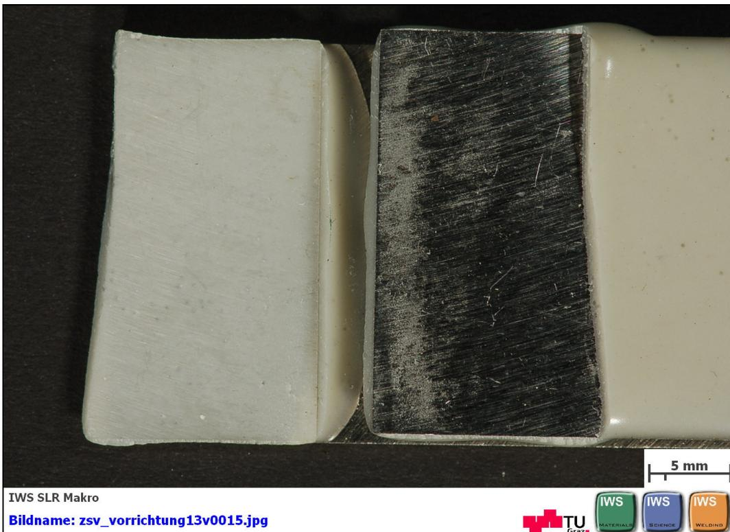
**Abbildung B 80: geklebte Flächen nach dem Zugscherversuch nach EN 1465 mit DELO: DELOMONOPOX® AD295 mit Glaskugeln zur Einhaltung des Klebespaltes Probe 5 von 5**
