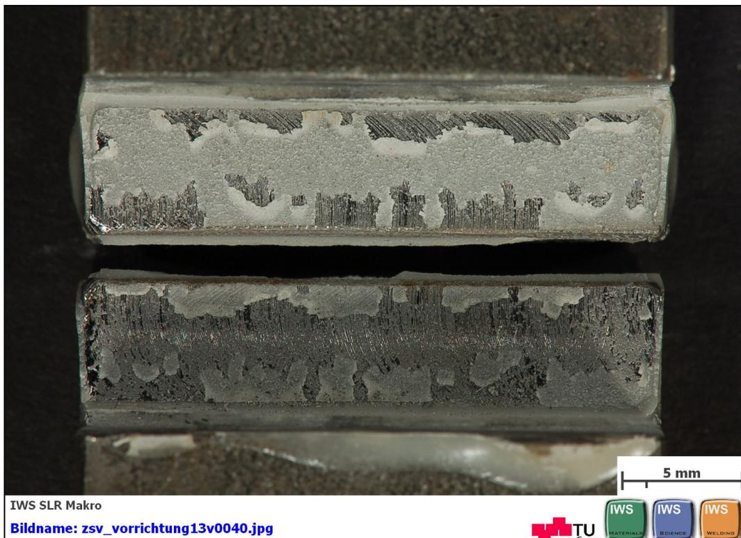
**Abbildung C 20: geklebte Flächen nach dem Zugscherversuch nach EN 14869-2 mit DELO: DELOMONOPOX® AD295 Probe 5 von 5**
