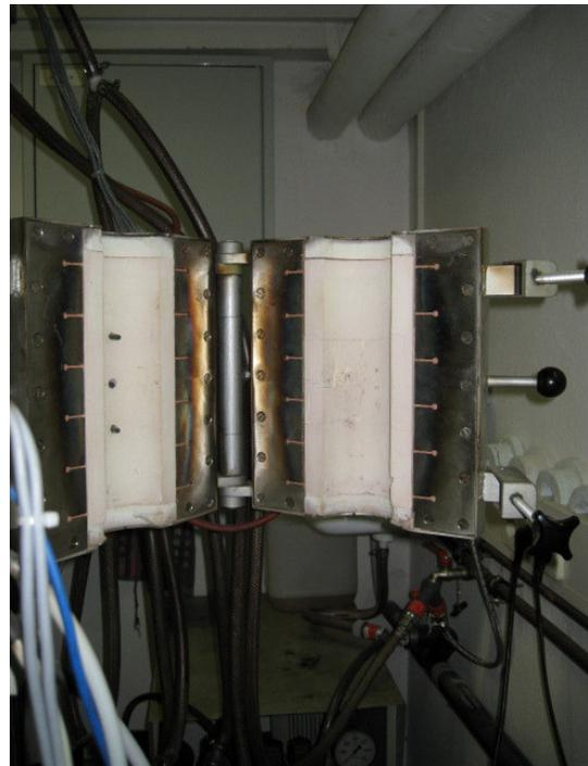
Abbildung 32: Einschwenkbarer Ofen für Temperaturversuche
