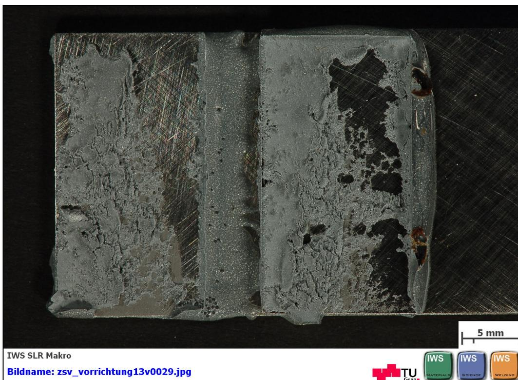
**Abbildung B 108: geklebte Flächen nach dem Zugscherversuch nach EN 1465 mit DELO: DELOMONOPOX® 1197 mit Glaskugeln und Stahlscheiben zur Einhaltung des Klebspaltes Probe 4 von 5**
