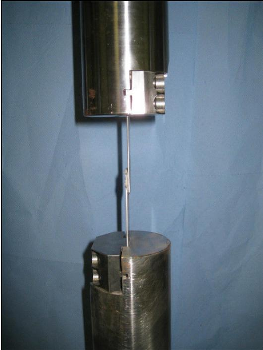
**Abbildung 57: Einlegen der Dünnschleib-Zugscherprobe in die Vorrichtung der Zugprüfmaschine Zwick/Roell**
