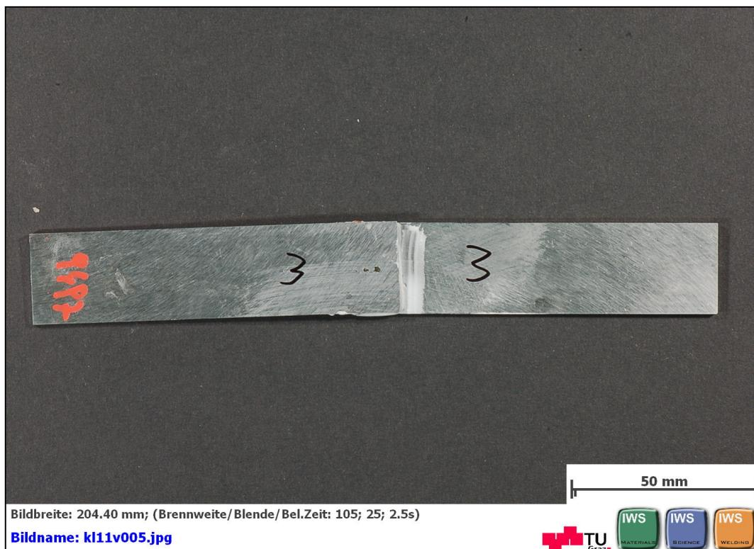
Abbildung 55: nicht optimal erfolgte Klebung mit HYSOL® 9497™, Probe 3 von 5, geklebt bei Magna Steyr Fahrzeugtechnik
