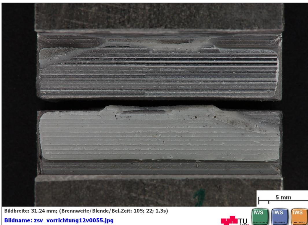
**Abbildung C 42: geblebte Flächen nach dem Zugscherversuch nach EN 14869-2
