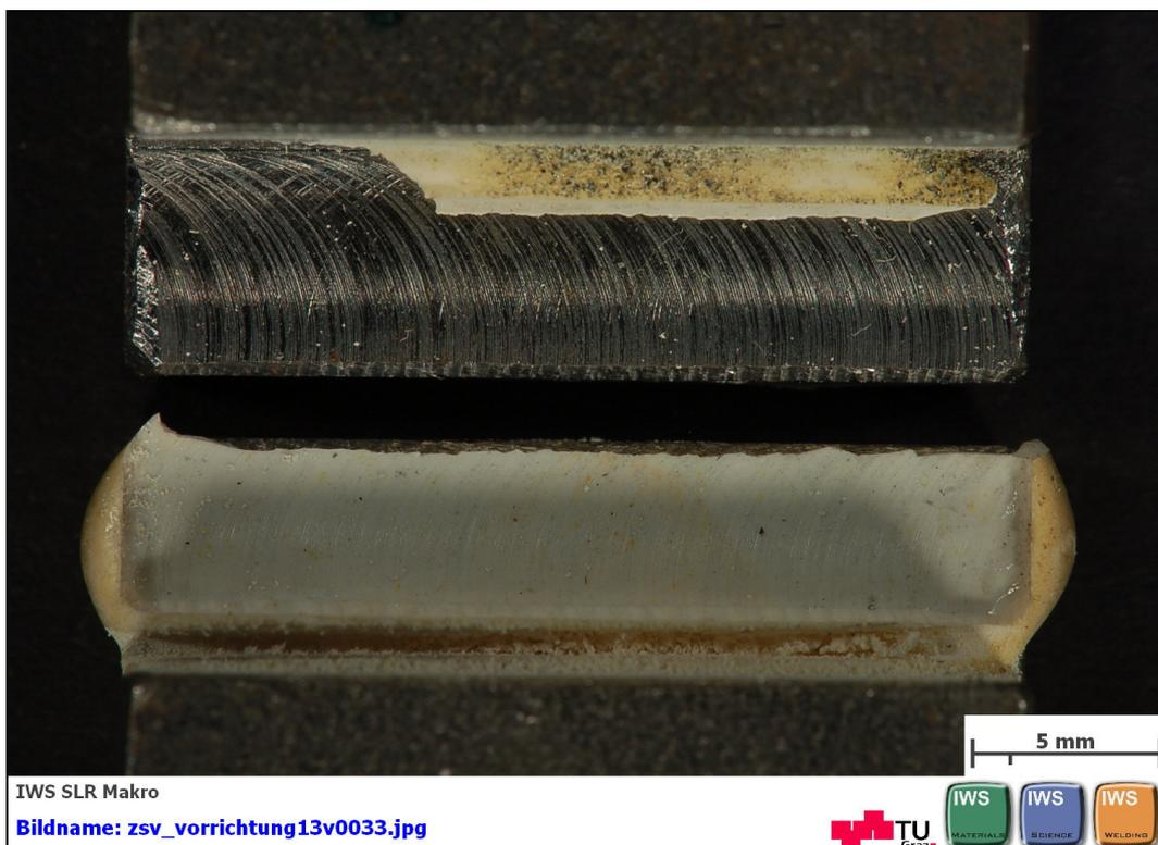
**Abbildung C 6: geklebte Flächen nach dem Zugscherversuch nach EN 14869-2 mit 3M: SCOTCH-WELD™ DP760 Probe 3 von 5**
