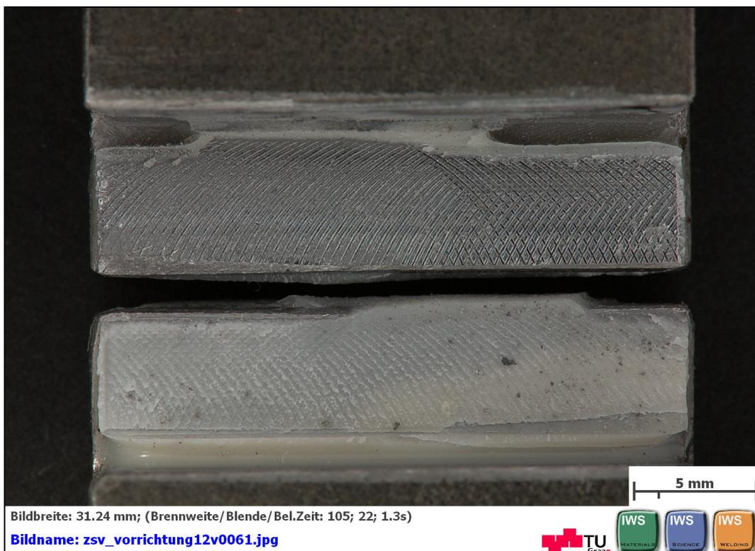
**Abbildung C 54: geklebte Flächen nach dem Zugscherversuch nach EN 14869-2
