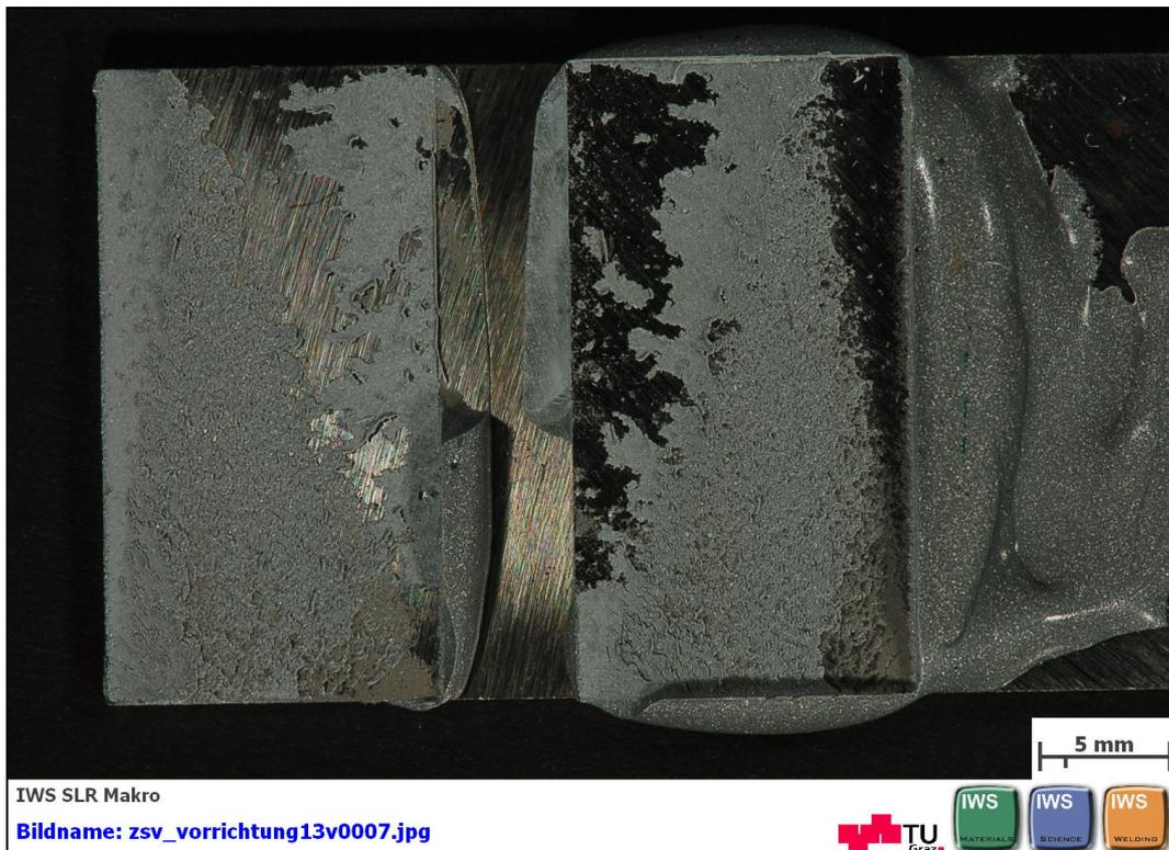
**Abbildung B 64: geklebte Flächen nach dem Zugscherversuch nach EN 1465 mit DELO: DELOMONOPOX® 1197 Probe 2 von 5**
