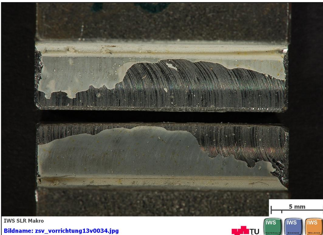
**Abbildung C 8: geklebte Flächen nach dem Zugscherversuch nach EN 14869-2
