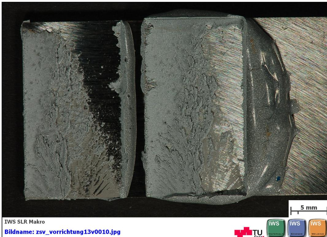
**Abbildung B 70: geklebte Flächen nach dem Zugscherversuch nach EN 1465 mit DELO: DELOMONOPOX® 1197 Probe 5 von 5**
