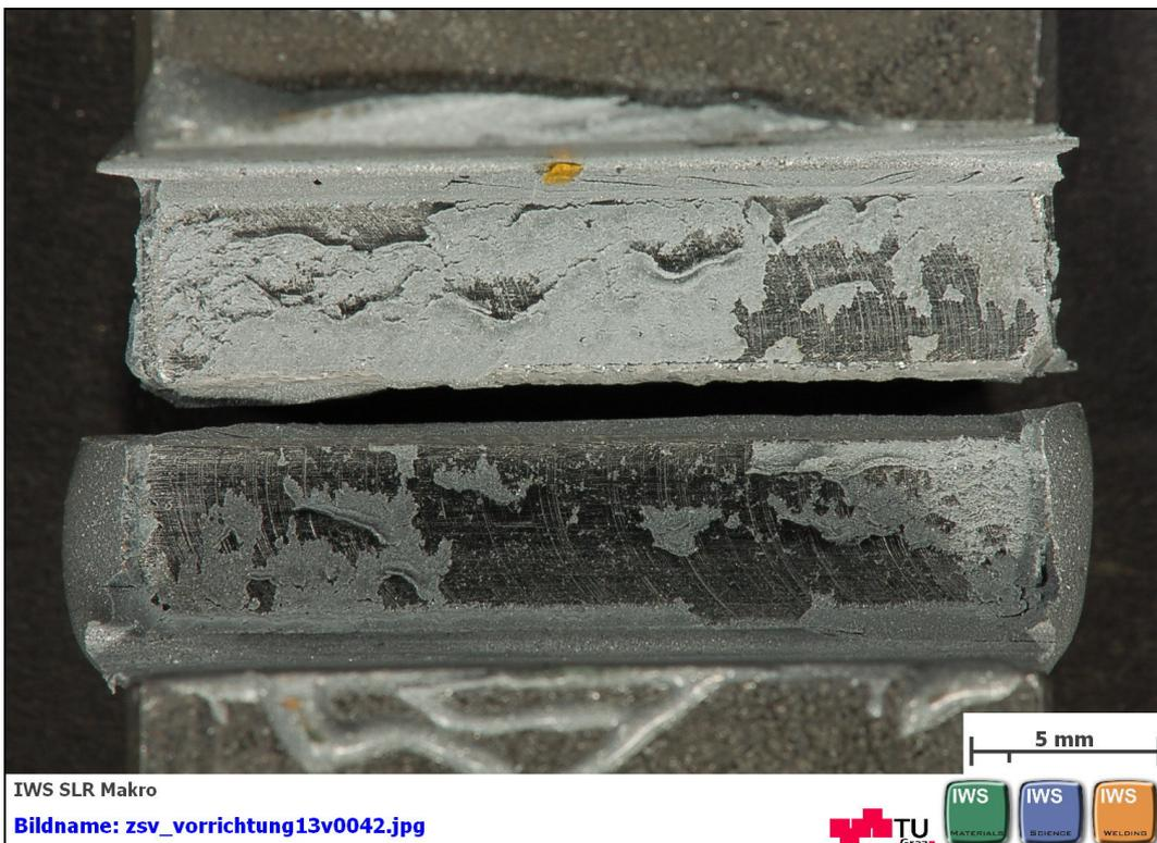
**Abbildung C 24: geklebte Flächen nach dem Zugscherversuch nach EN 14869-2 mit DELO: DELOMONOPOX® 1197 Probe 2 von 5**
