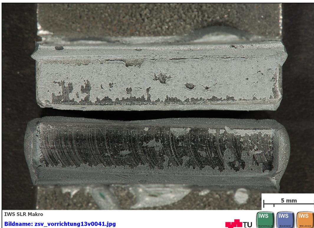
**Abbildung C 22: geklebte Flächen nach dem Zugscherversuch nach EN 14869-2
