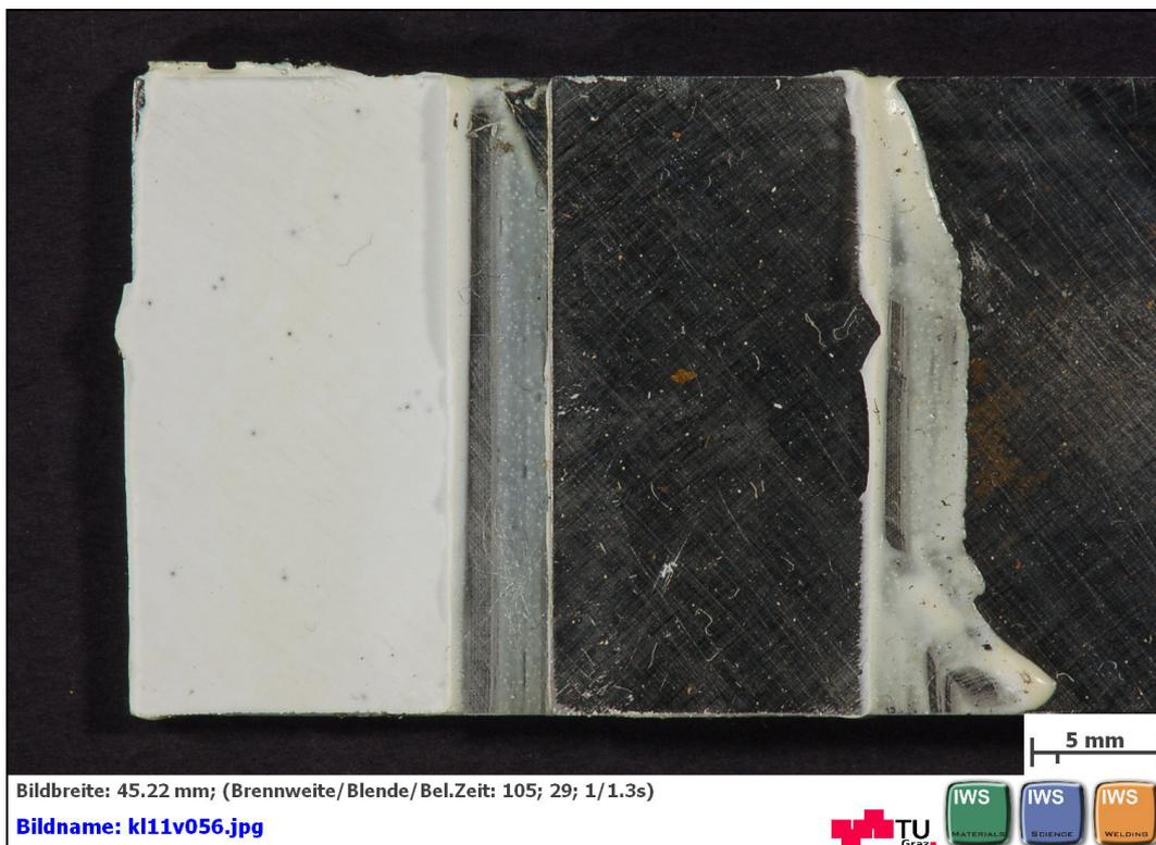
**Abbildung B 12: geklebte Flächen nach dem Zugscherversuch nach EN 1465 mit 3M: SCOTCH-WELD™ DP760 Probe 1 von 5**
