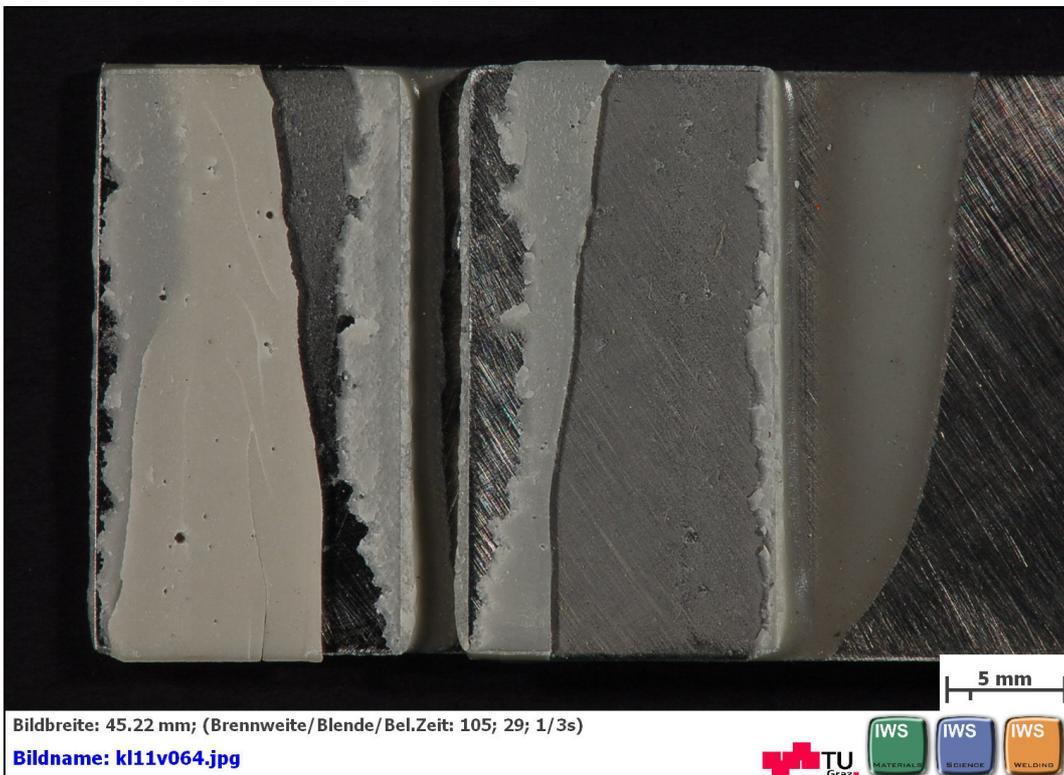
**Abbildung B 28: geklebte Flächen nach dem Zugscherversuch nach EN 1465 mit DELO: DELOMONOPOX® AD295 Probe 4 von 5**
