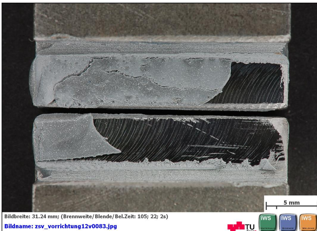
**Abbildung C 98: geklebte Flächen nach dem Zugscherversuch nach EN 14869-2
