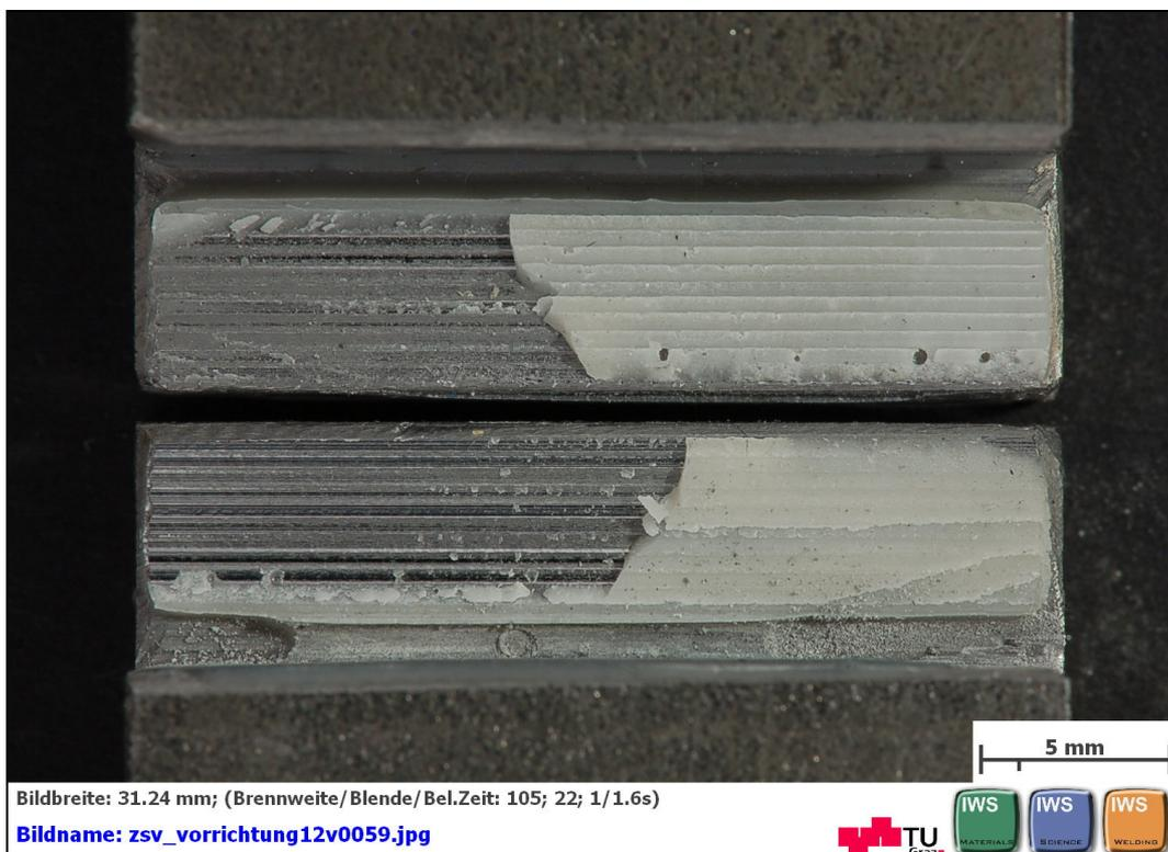
**Abbildung C 50: geklebte Flächen nach dem Zugscherversuch nach EN 14869-2 mit DELO: DELOMONOPOX® AD295 Rautiefe Ra6,3 Probe 5 von 5**
