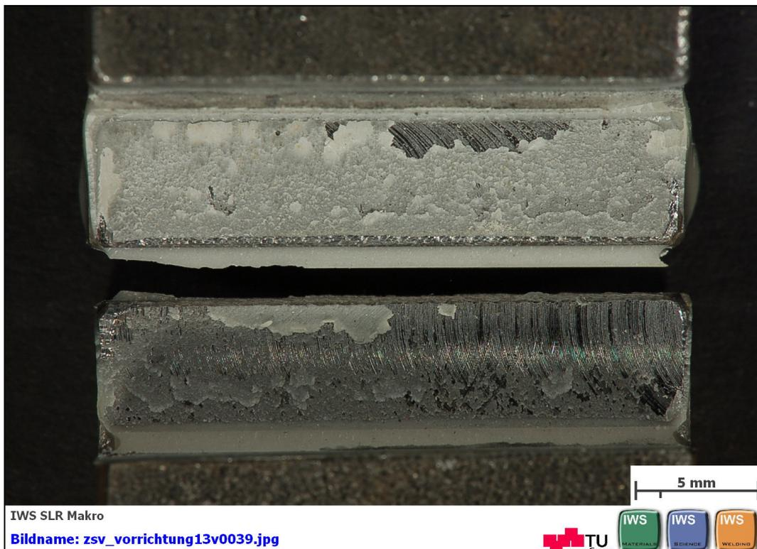
**Abbildung C 18: geklebte Flächen nach dem Zugscherversuch nach EN 14869-2
