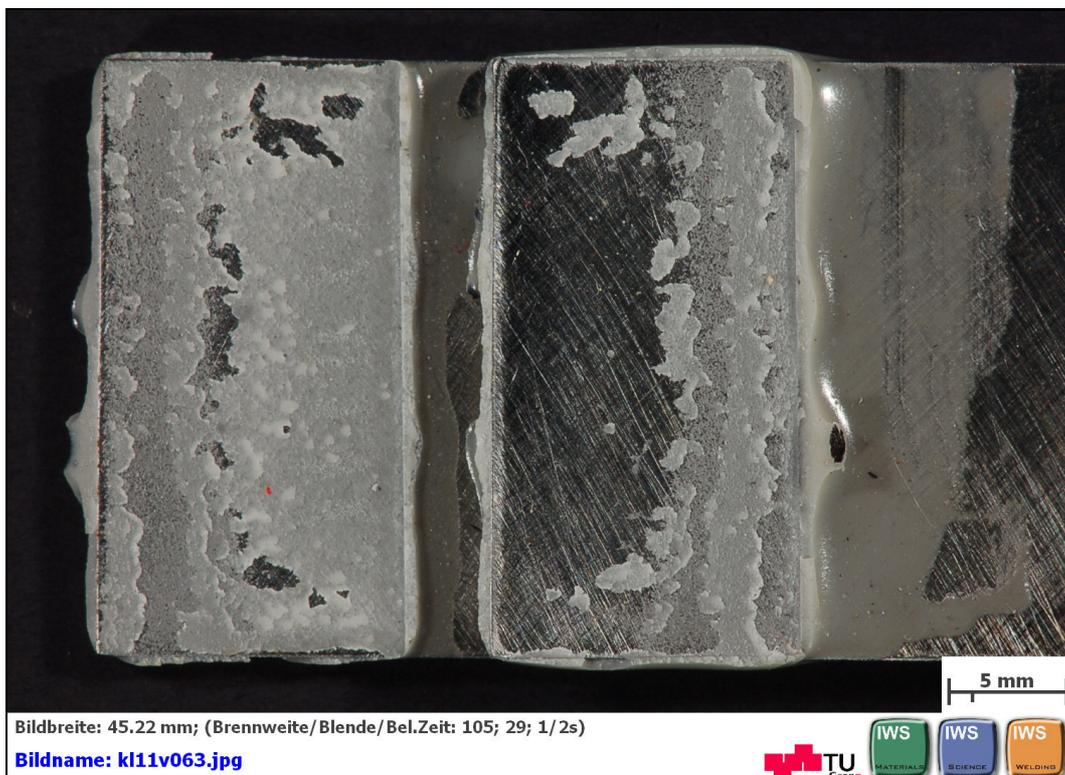
**Abbildung B 26: geklebte Flächen nach dem Zugscherversuch nach EN 1465
