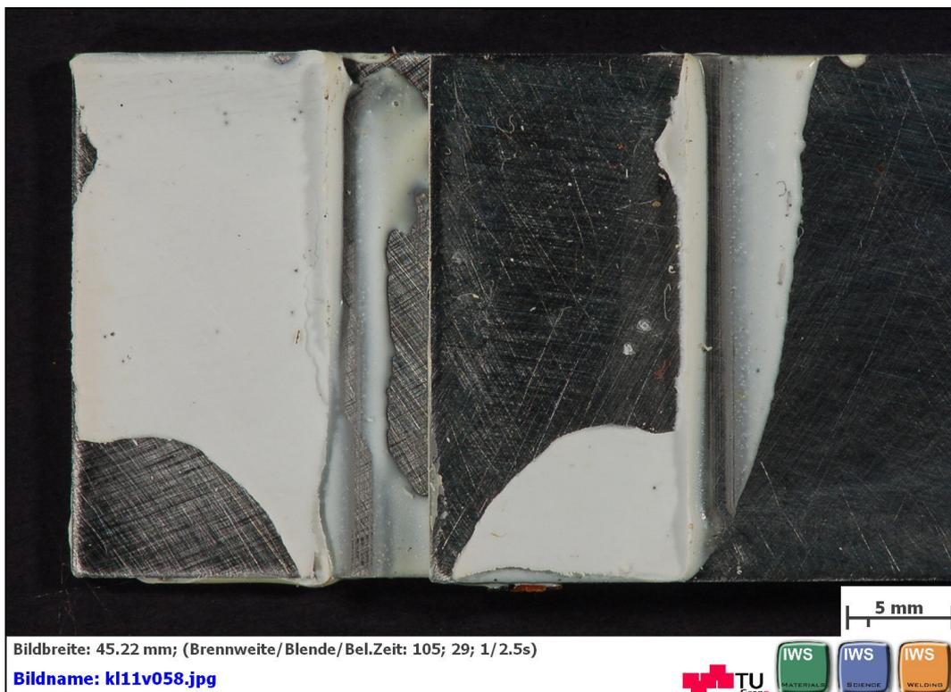
**Abbildung B 16: geklebte Flächen nach dem Zugscherversuch nach EN 1465 mit 3M: SCOTCH-WELD™ DP760 Probe 3 von 5**
