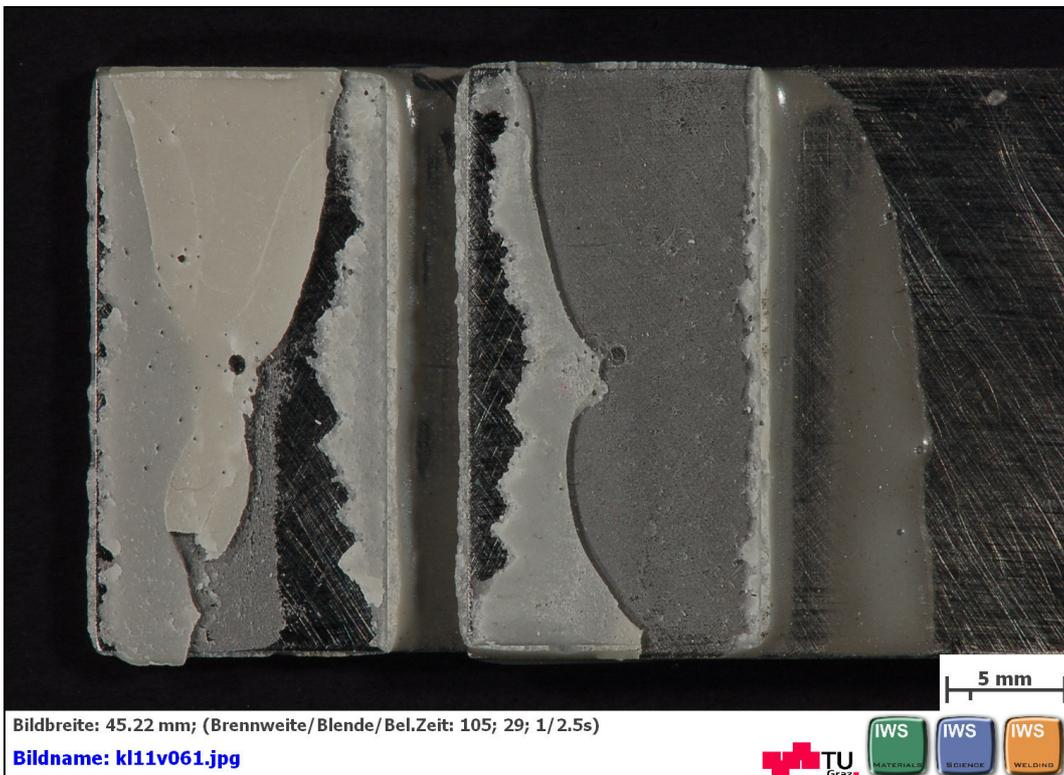
**Abbildung B 22: geklebte Flächen nach dem Zugscherversuch nach EN 1465 mit DELO: DELOMONOPOX® AD295 Probe 1 von 5**
