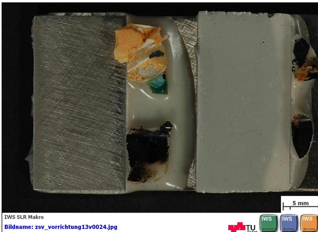
**Abbildung B 98: geklebte Flächen nach dem Zugscherversuch nach EN 1465
