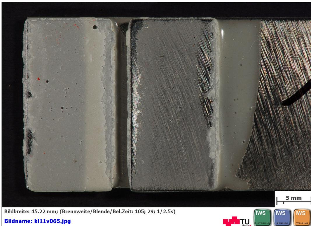
**Abbildung B 30: geklebte Flächen nach dem Zugscherversuch nach EN 1465 mit DELO: DELOMONOPOX® AD295 Probe 5 von 5**
