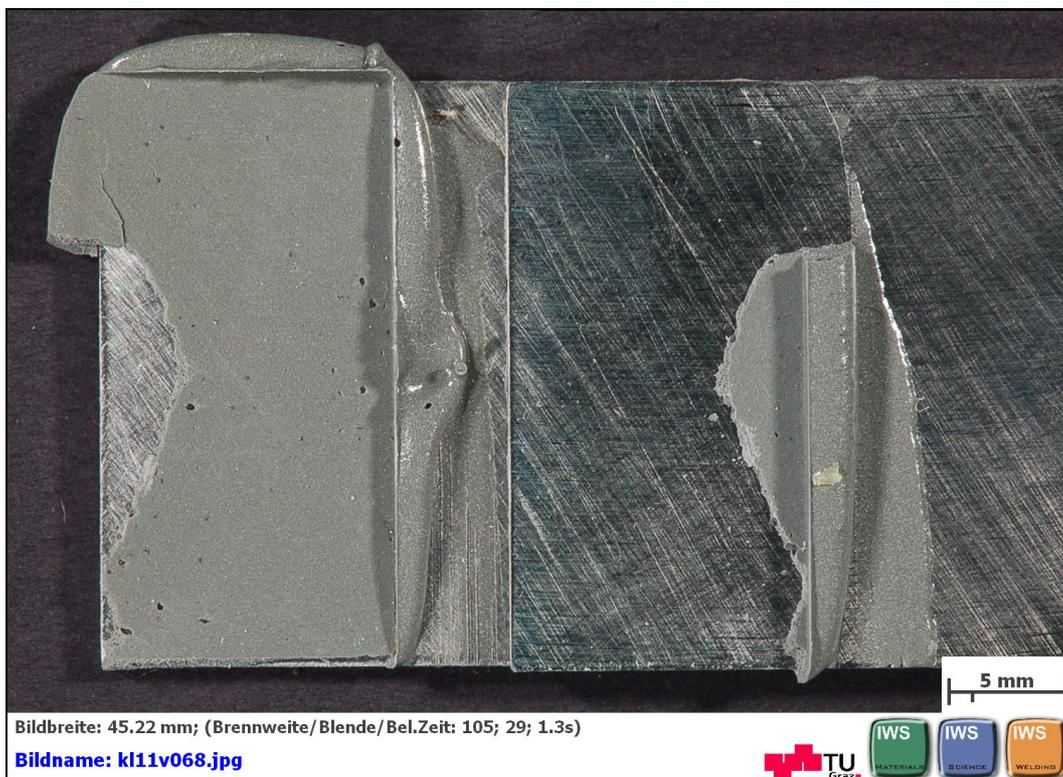
**Abbildung B 36: geklebte Flächen nach dem Zugscherversuch nach EN 1465 mit HENKEL: HYSOL® EA 9394/C-2 Probe 3 von 5**
