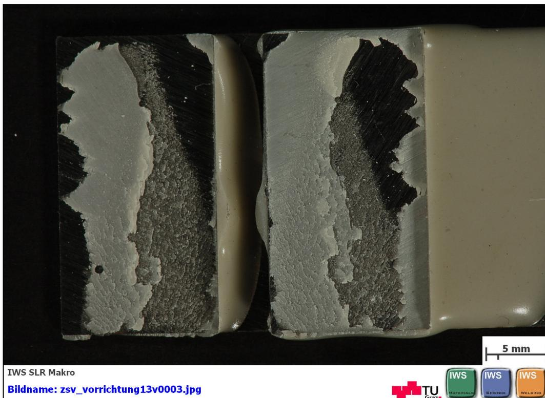
**Abbildung B 56: geklebte Flächen nach dem Zugscherversuch nach EN 1465 mit DELO: DELOMONOPOX® AD295 Probe 3 von 5**
