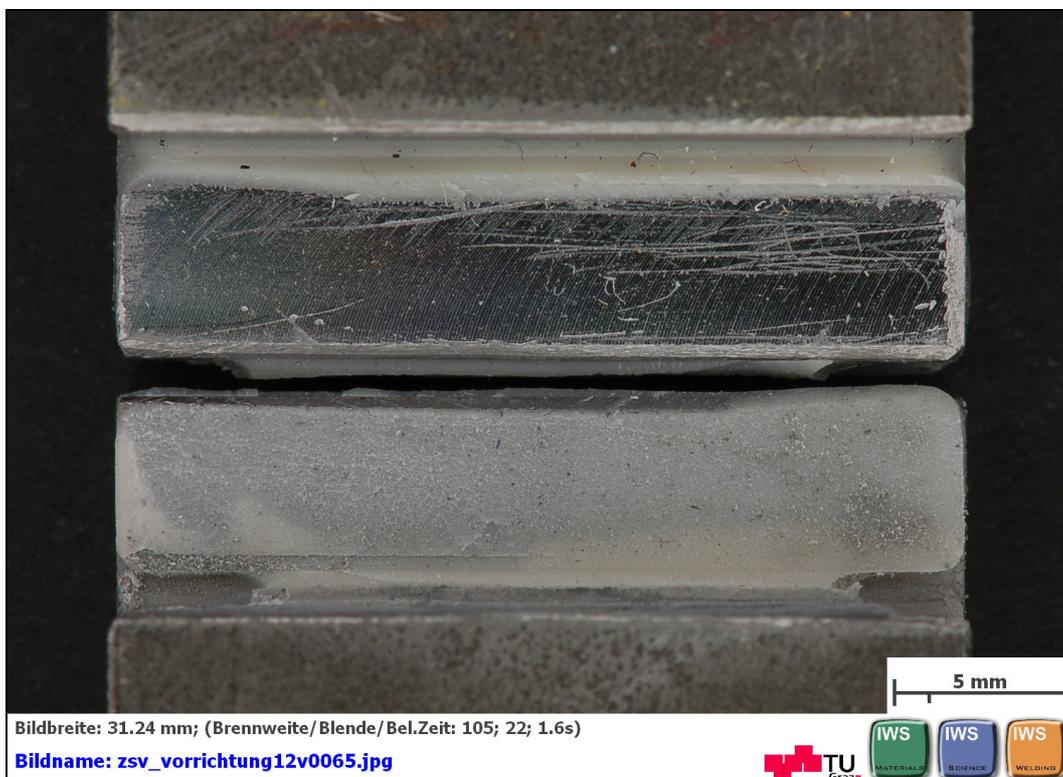
**Abbildung C 62: geklebte Flächen nach dem Zugscherversuch nach EN 14869-2
