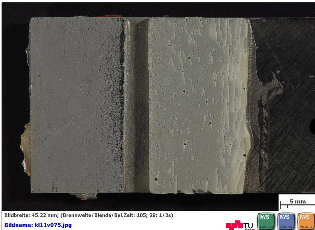
**Abbildung B 50: geklebte Flächen nach dem Zugscherversuch nach EN 1465 mit THREE BOND: 2285D Probe 5 von 5**
