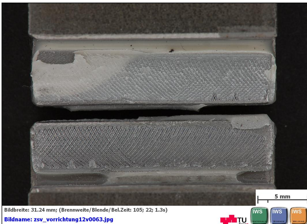
**Abbildung C 58: geklebte Flächen nach dem Zugscherversuch nach EN 14869-2 mit DELO: DELOMONOPOX® AD295 Rautiefe Ra3,2 Probe 4 von 5**
