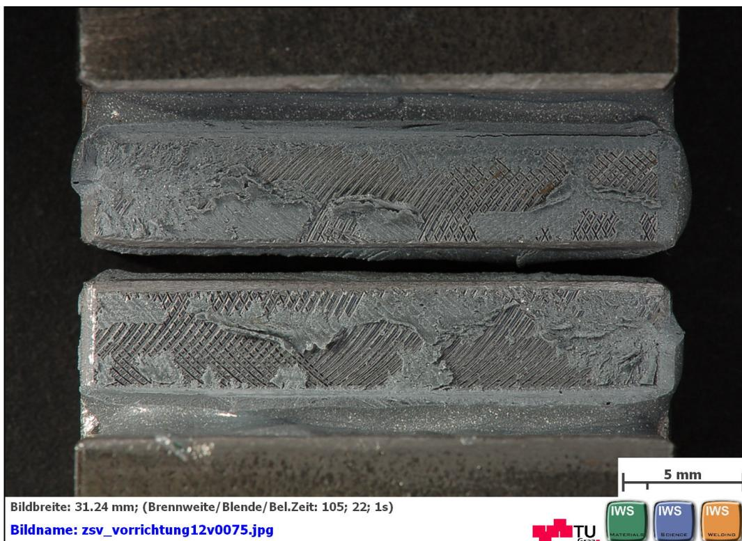
**Abbildung C 82: geklebte Flächen nach dem Zugscherversuch nach EN 14869-2 mit DELO: DELOMONOPOX® 1197 Rautiefe Ra3,2 Probe 1 von 5**
