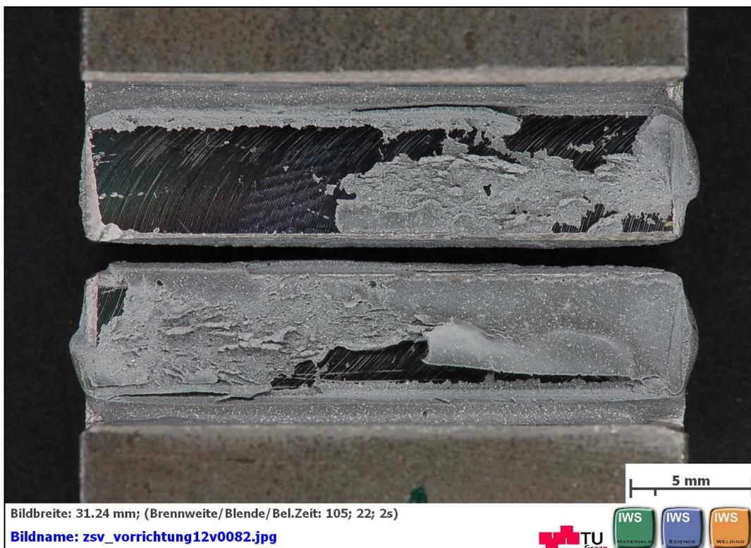
**Abbildung C 96: geklebte Flächen nach dem Zugscherversuch nach EN 14869-2
