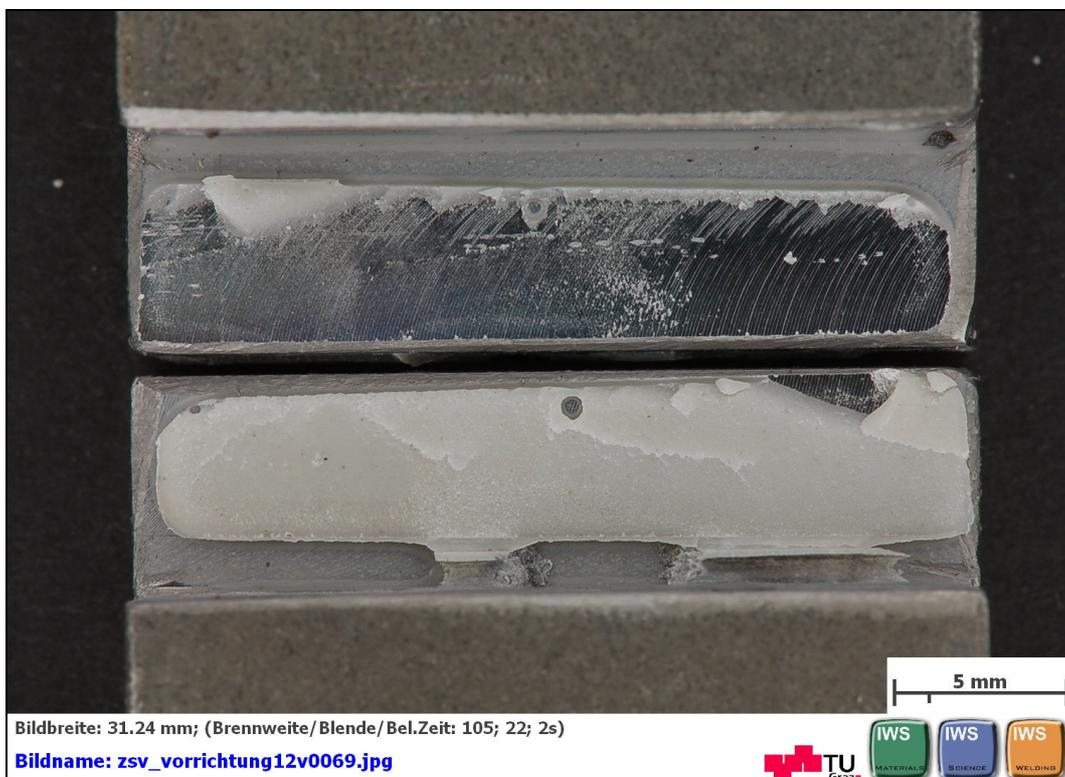
**Abbildung C 70: geklebte Flächen nach dem Zugscherversuch nach EN 14869-2
