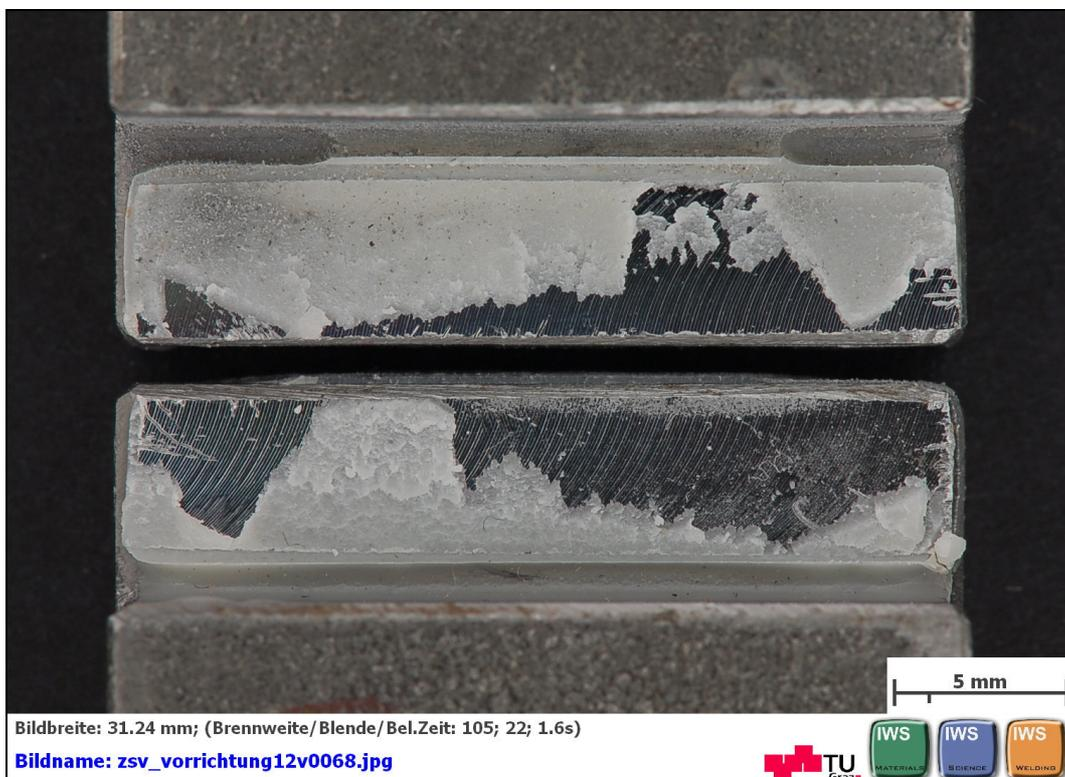
**Abbildung C 68: geklebte Flächen nach dem Zugscherversuch nach EN 14869-2 mit DELO: DELOMONOPOX® AD295 Rautiefe Ra1,6 Probe 4 von 5**
