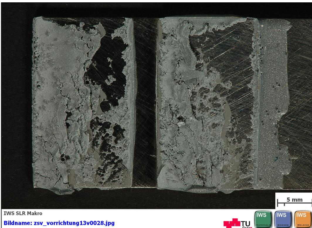
**Abbildung B 106: geklebte Flächen nach dem Zugscherversuch nach EN 1465 mit DELO: DELOMONOPOX® 1197 mit Glaskugeln und Stahlscheiben zur Einhaltung des Klebspaltes Probe 3 von 5**
