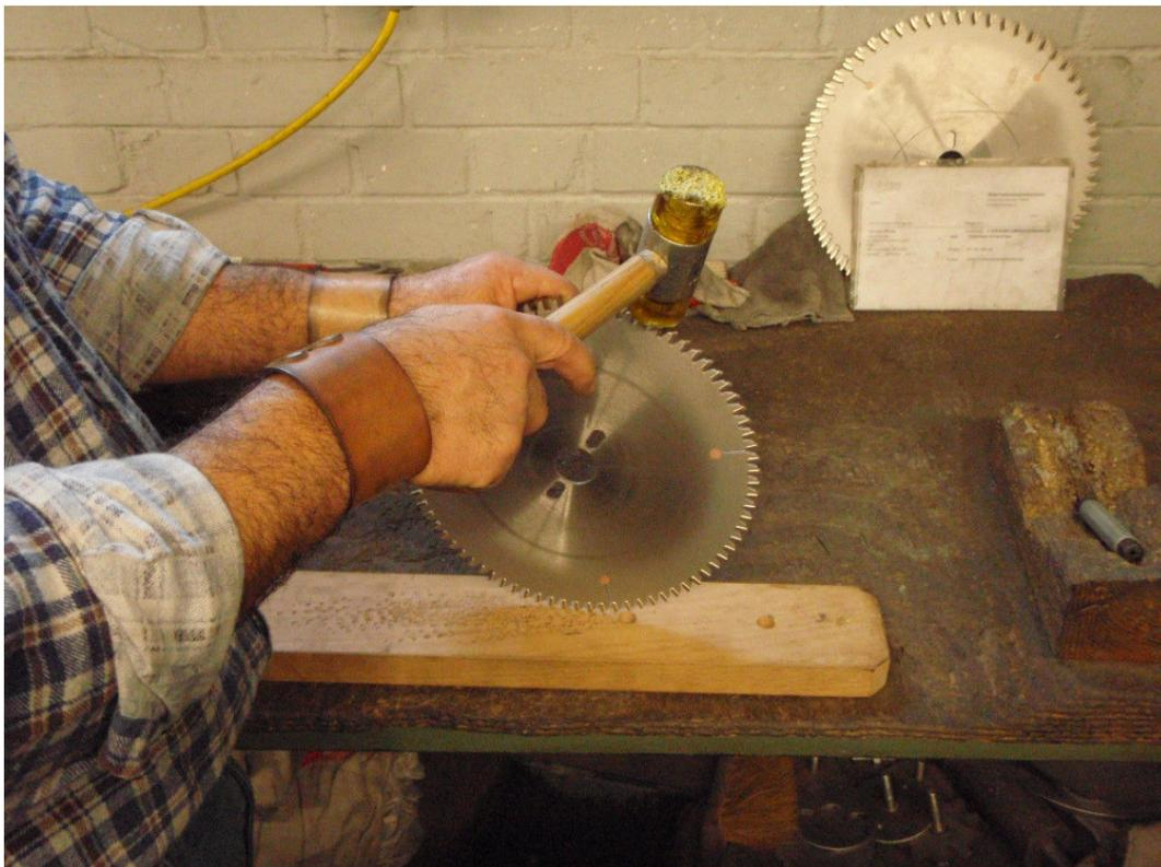
Abbildung 79: Festigkeitsprüfung eines Sägeblattes mittels Kunststoffhammer<sup>65</sup>
