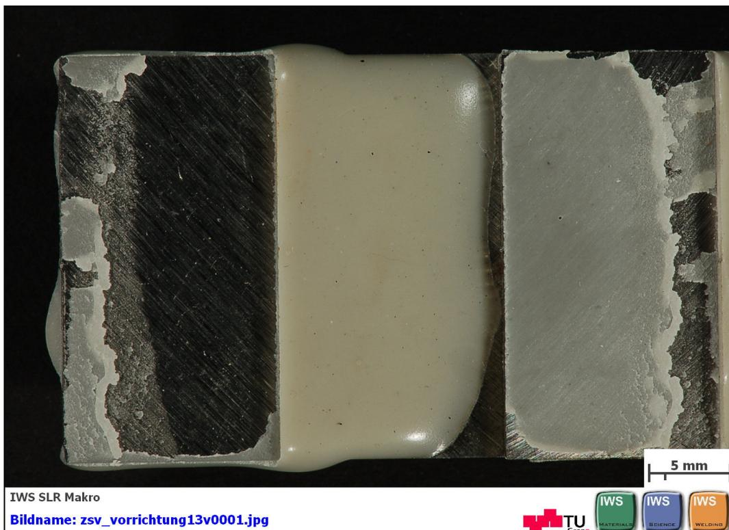
**Abbildung B 52: geklebte Flächen nach dem Zugscherversuch nach EN 1465 mit DELO: DELOMONOPOX® AD295 Probe 1 von 5**
