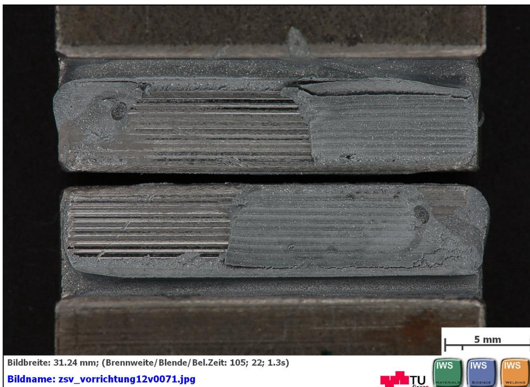
**Abbildung C 74: geklebte Flächen nach dem Zugscherversuch nach EN 14869-2 mit DELO: DELOMONOPOX® 1197 Rautiefe Ra6,3 Probe 2 von 5**
