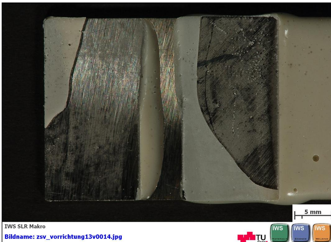
**Abbildung B 78: geklebte Flächen nach dem Zugscherversuch nach EN 1465
