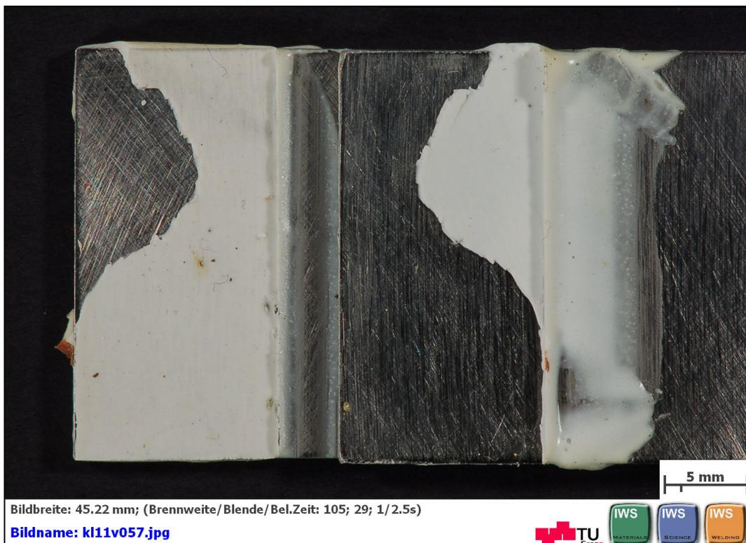
**Abbildung B 14: geklebte Flächen nach dem Zugscherversuch nach EN 1465
