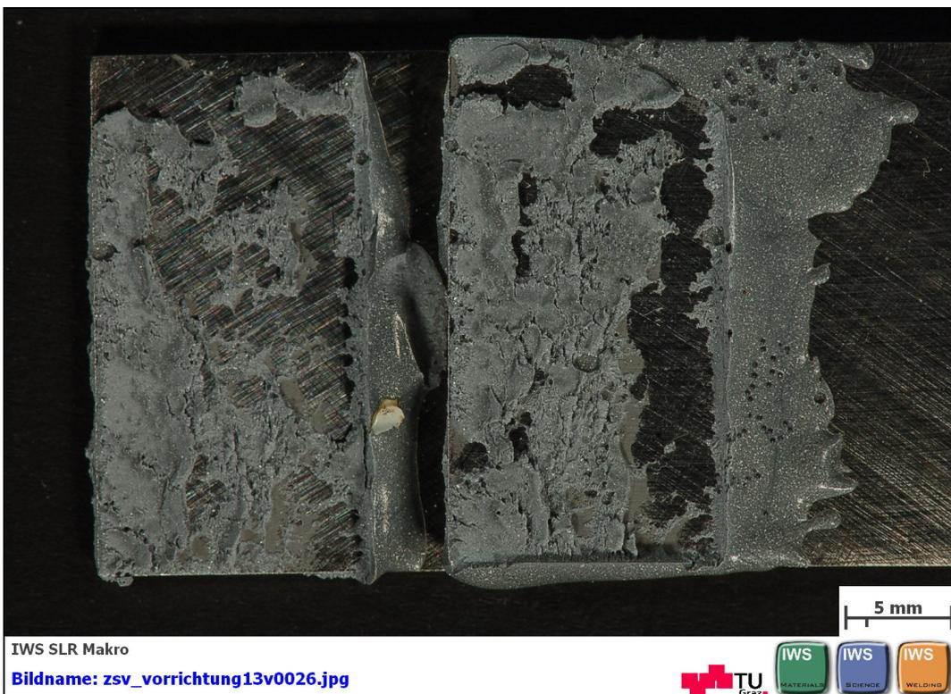
**Abbildung B 102: geklebte Flächen nach dem Zugscherversuch nach EN 1465 mit DELO: DELOMONOPOX® 1197 mit Glaskugeln und Stahlscheiben zur Einhaltung des Klebspaltes Probe 1 von 5**
