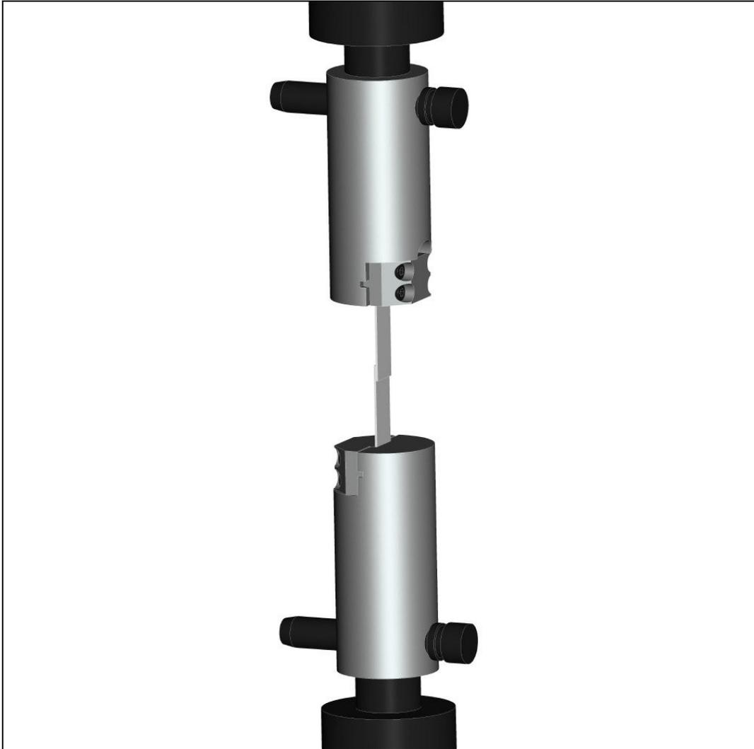
**Abbildung 37: komplette Vorrichtung eingebaut in der Prüfmaschine Zwick/Roell am IWS TU Graz**
