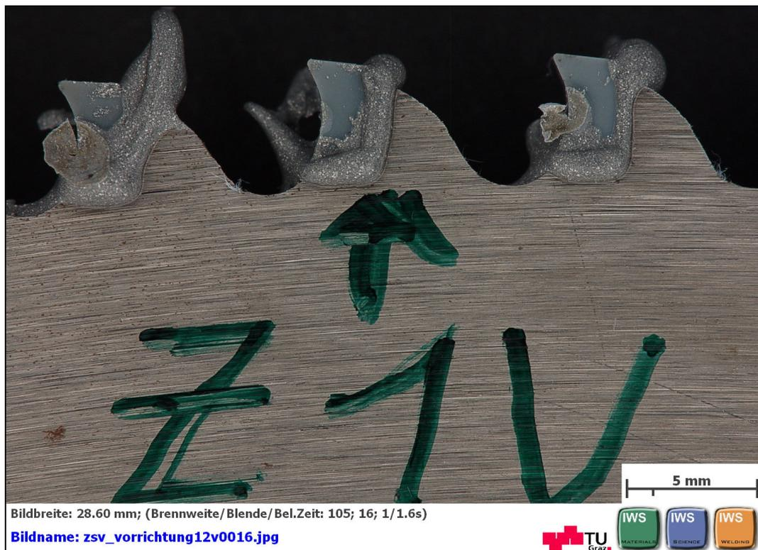
Abbildung 77: Oberseite eines mit Keramikzähnen bestückten Sägeblattes, geklebt mit DELOMONOPX<sup>®</sup> 1197
