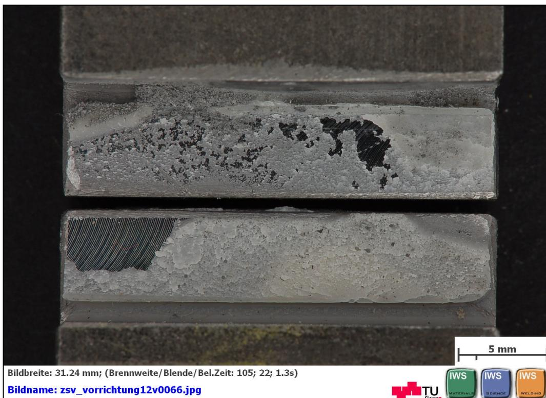
**Abbildung C 64: geklebte Flächen nach dem Zugscherversuch nach EN 14869-2
