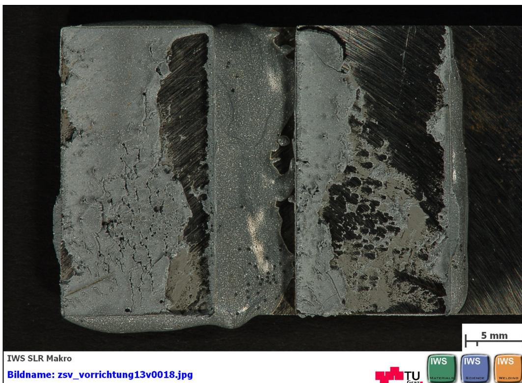
**Abbildung B 86: geklebte Flächen nach dem Zugscherversuch nach EN 1465 mit DELO: DELOMONOPOX® 1197 mit Glaskugeln zur Einhaltung des Klebespaltes Probe 3 von 5**
