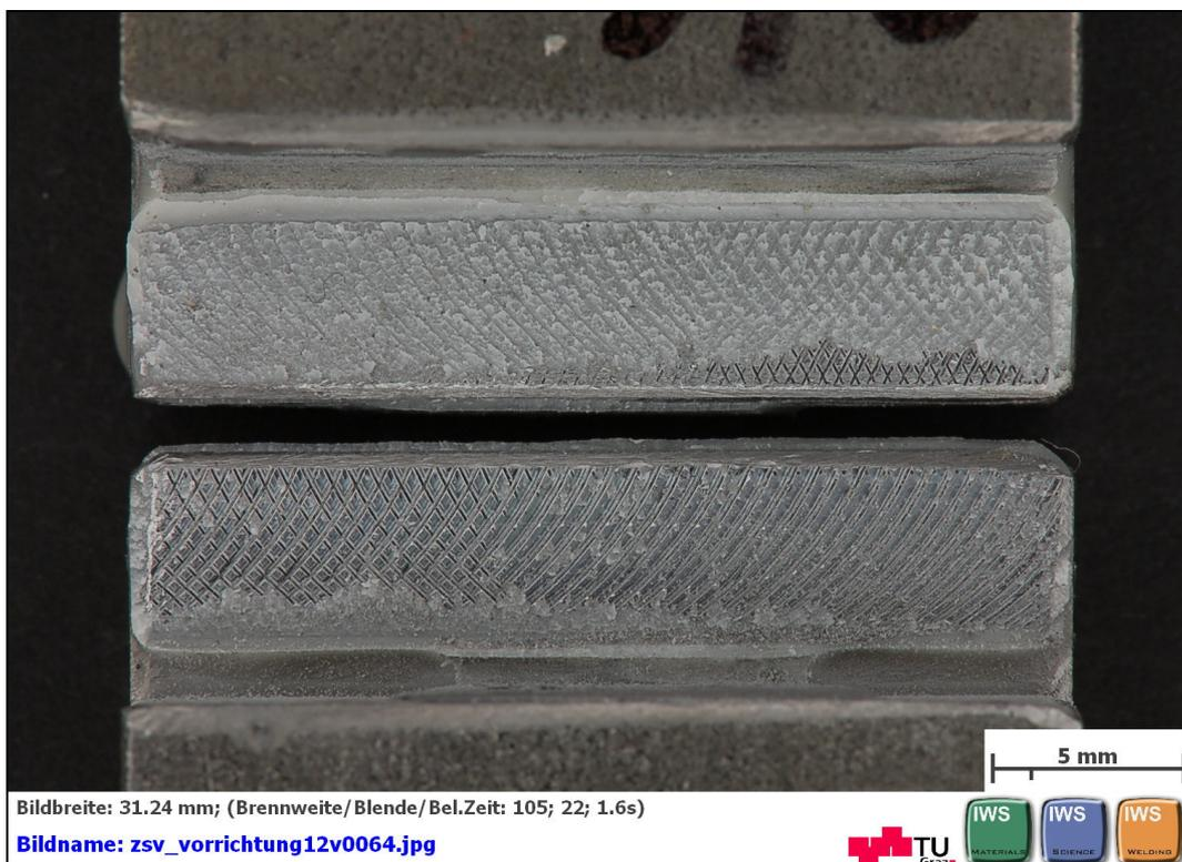
**Abbildung C 60: geklebte Flächen nach dem Zugscherversuch nach EN 14869-2
