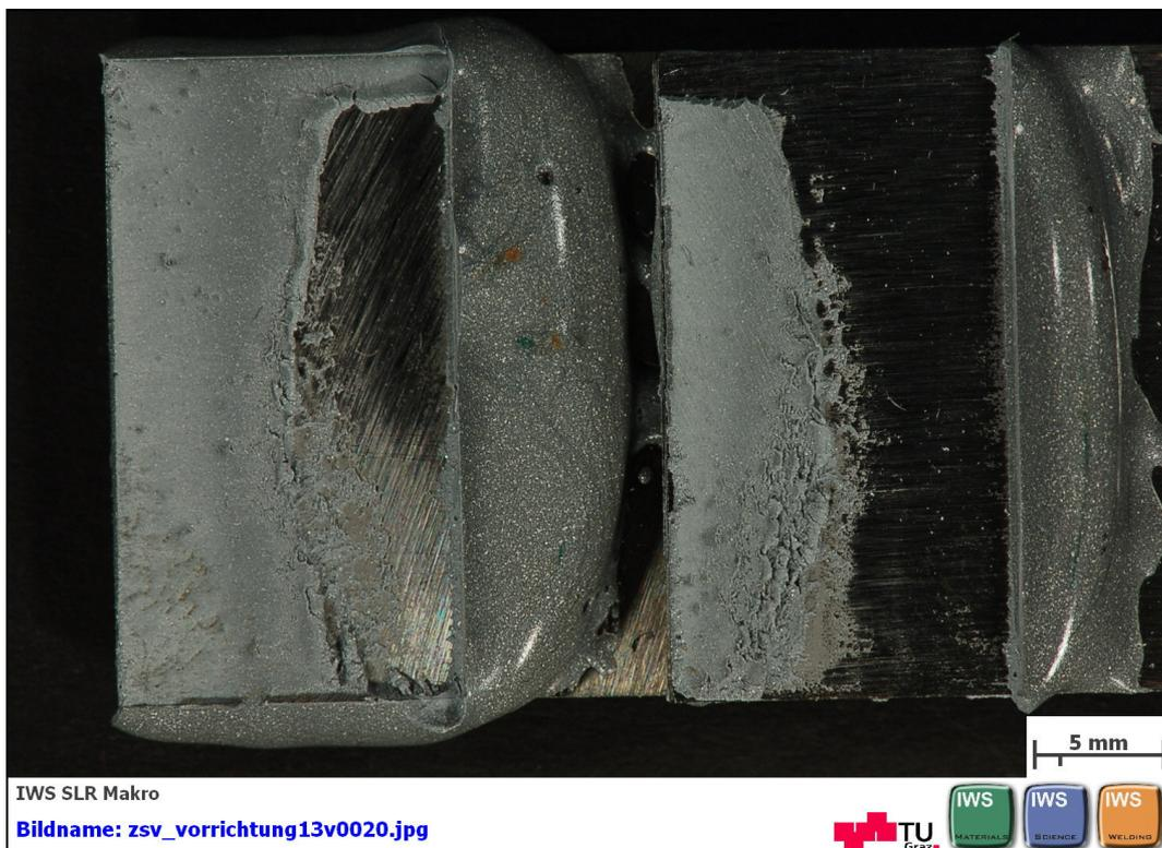
**Abbildung B 90: geklebte Flächen nach dem Zugscherversuch nach EN 1465
