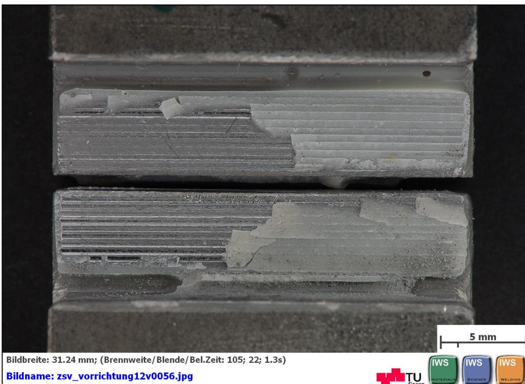
**Abbildung C 44: geklebte Flächen nach dem Zugscherversuch nach EN 14869-2 mit DELO: DELOMONOPOX® AD295 Rautiefe Ra6,3 Probe 2 von 5**
