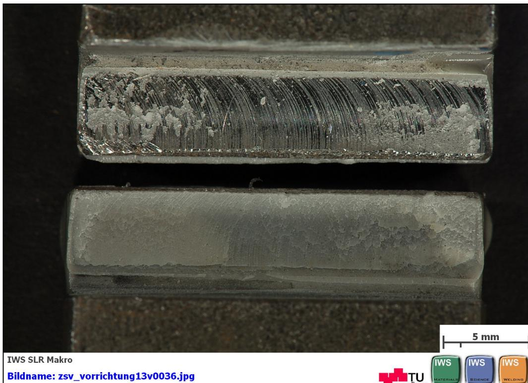
**Abbildung C 12: geklebte Flächen nach dem Zugscherversuch nach EN 14869-2 mit DELO: DELOMONOPOX® AD295 Probe 1 von 5**
