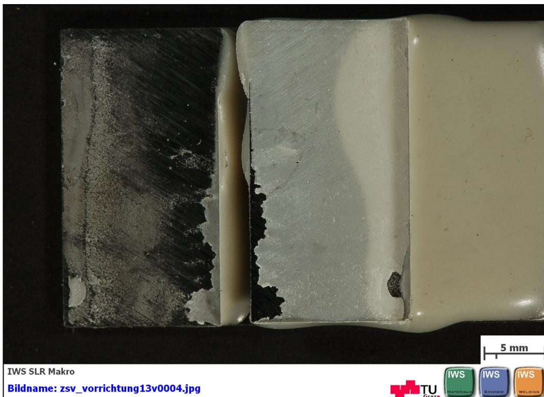
**Abbildung B 58: geklebte Flächen nach dem Zugscherversuch nach EN 1465 mit DELO: DELOMONOPOX® AD295 Probe 4 von 5**
