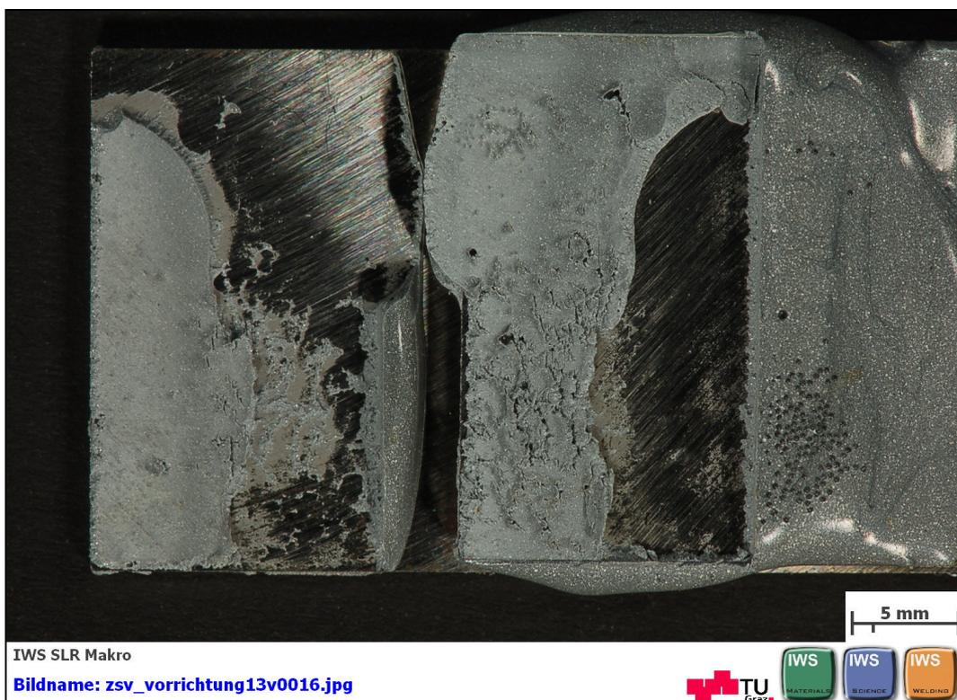
**Abbildung B 82: geklebte Flächen nach dem Zugscherversuch nach EN 1465
