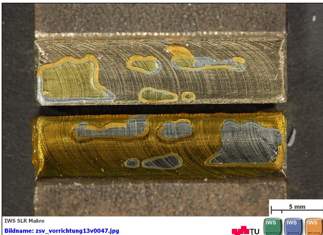
**Abbildung C 34: geklebte Flächen nach dem Zugscherversuch nach EN 14869-2
