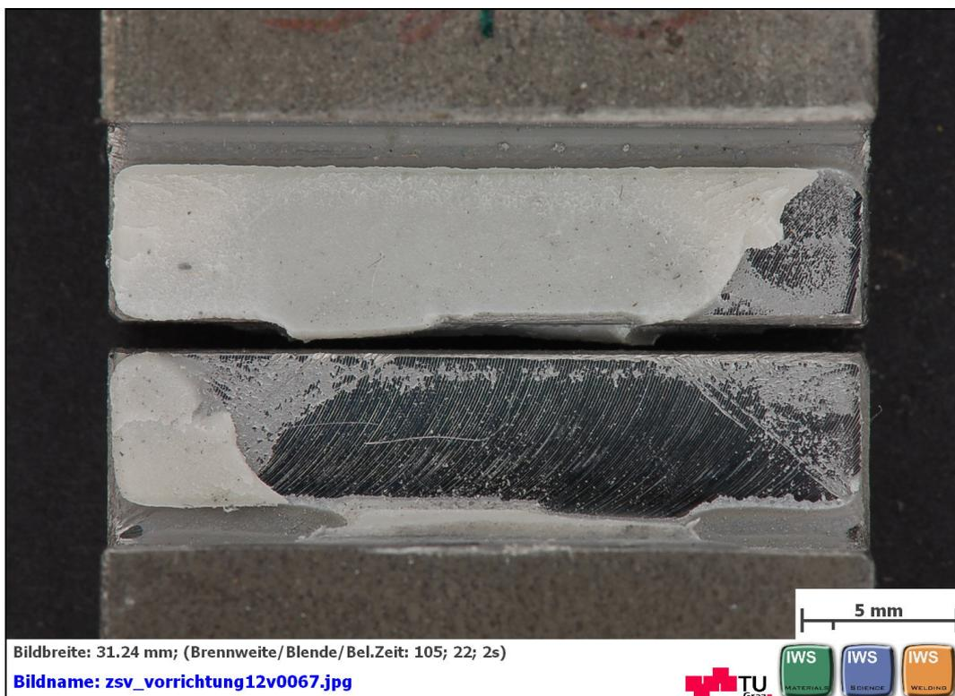
**Abbildung C 66: geklebte Flächen nach dem Zugscherversuch nach EN 14869-2 mit DELO: DELOMONOPOX® AD295 Rautiefe Ra1,6 Probe 3 von 5**
