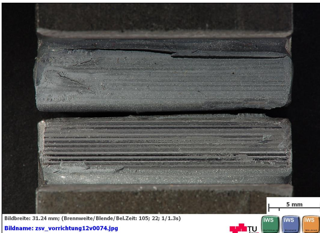
**Abbildung C 80: geklebte Flächen nach dem Zugscherversuch nach EN 14869-2 mit DELO: DELOMONOPOX® 1197 Rautiefe Ra6,3 Probe 5 von 5**
