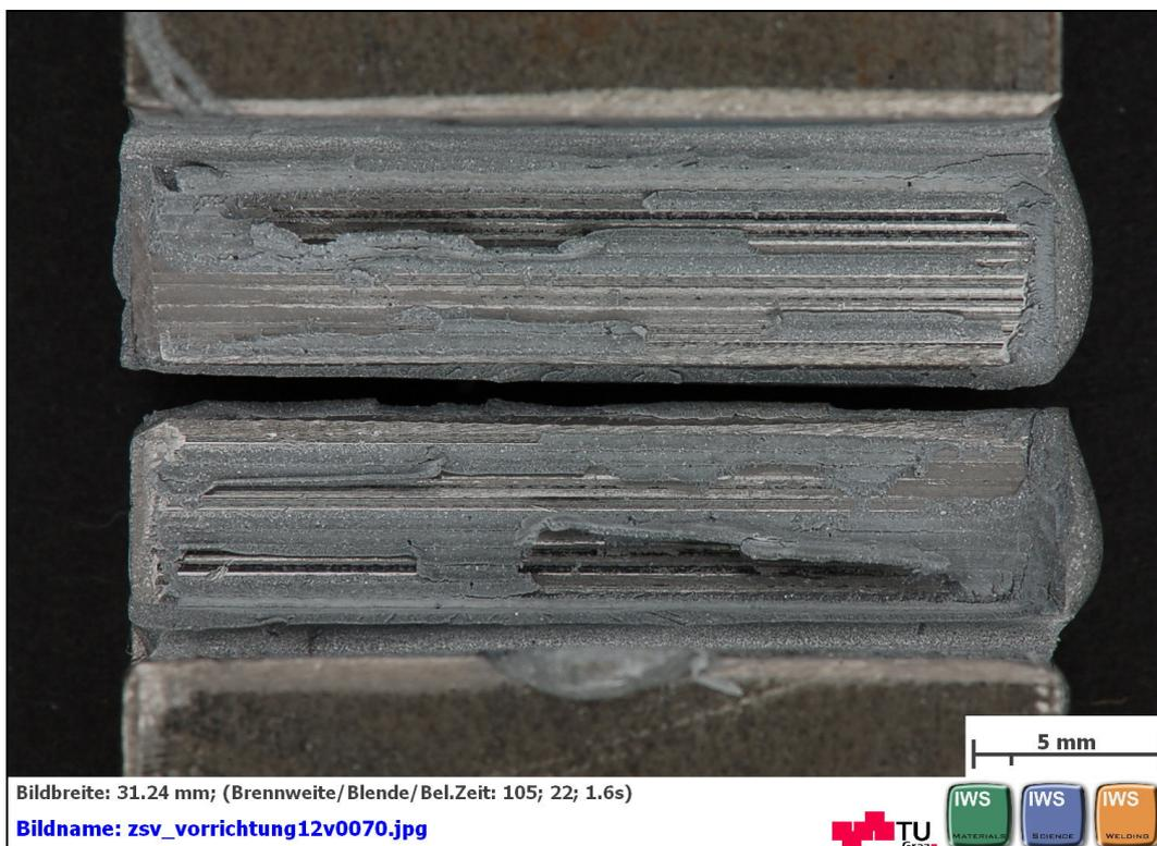
**Abbildung C 72: geklebte Flächen nach dem Zugscherversuch nach EN 14869-2
