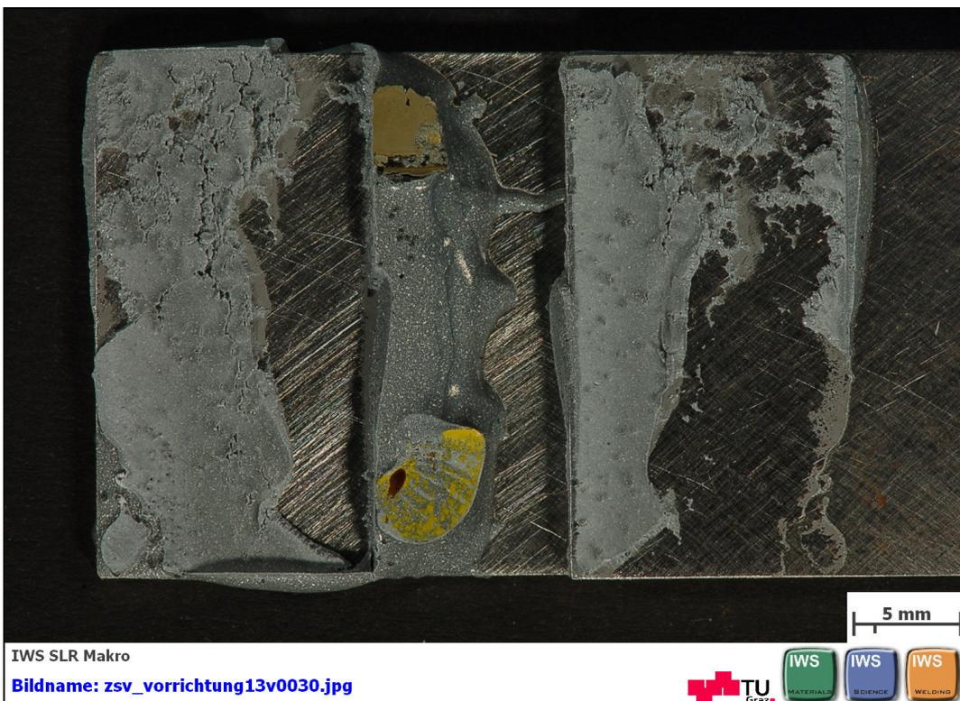
**Abbildung B 110: geklebte Flächen nach dem Zugscherversuch nach EN 1465 mit DELO: DELOMONOPOX® 1197 mit Glaskugeln und Stahlscheiben zur Einhaltung des Klebspaltes Probe 5 von 5**
