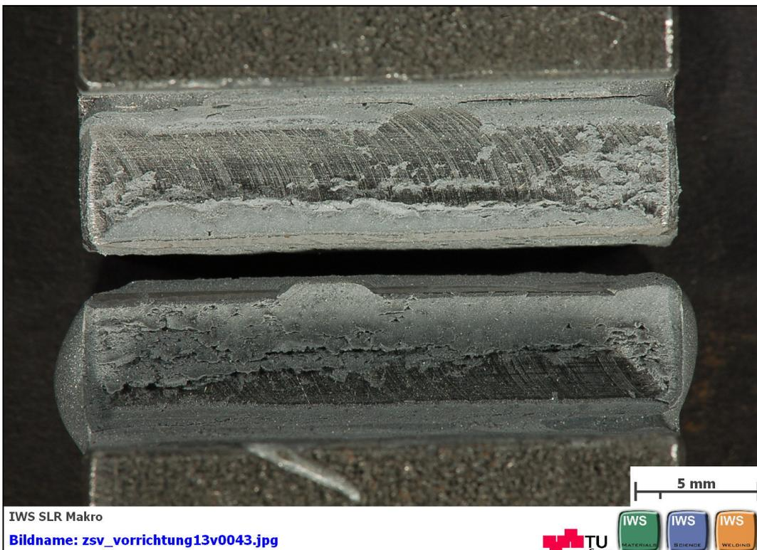
**Abbildung C 26: geklebte Flächen nach dem Zugscherversuch nach EN 14869-2 mit DELO: DELOMONOPOX® 1197 Probe 3 von 5**
