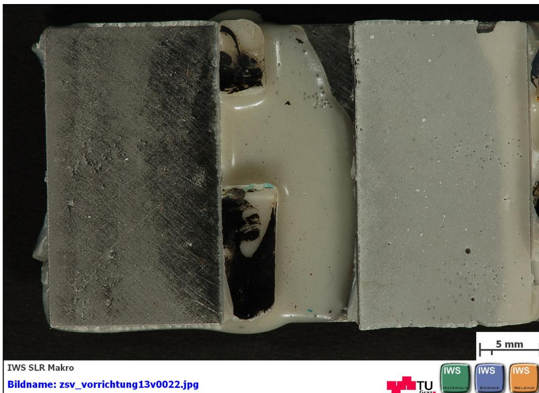
**Abbildung B 94: geklebte Flächen nach dem Zugscherversuch nach EN 1465
