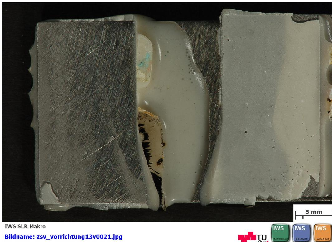
**Abbildung B 92: geklebte Flächen nach dem Zugscherversuch nach EN 1465
