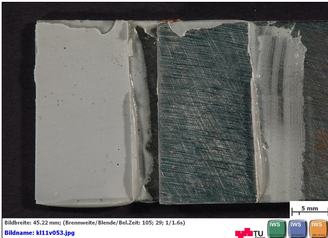
**Abbildung B 6: geklebte Flächen nach dem Zugscherversuch nach EN 1465 mit HENKEL: HYSOL® 9497™ Probe 3 von 5**
