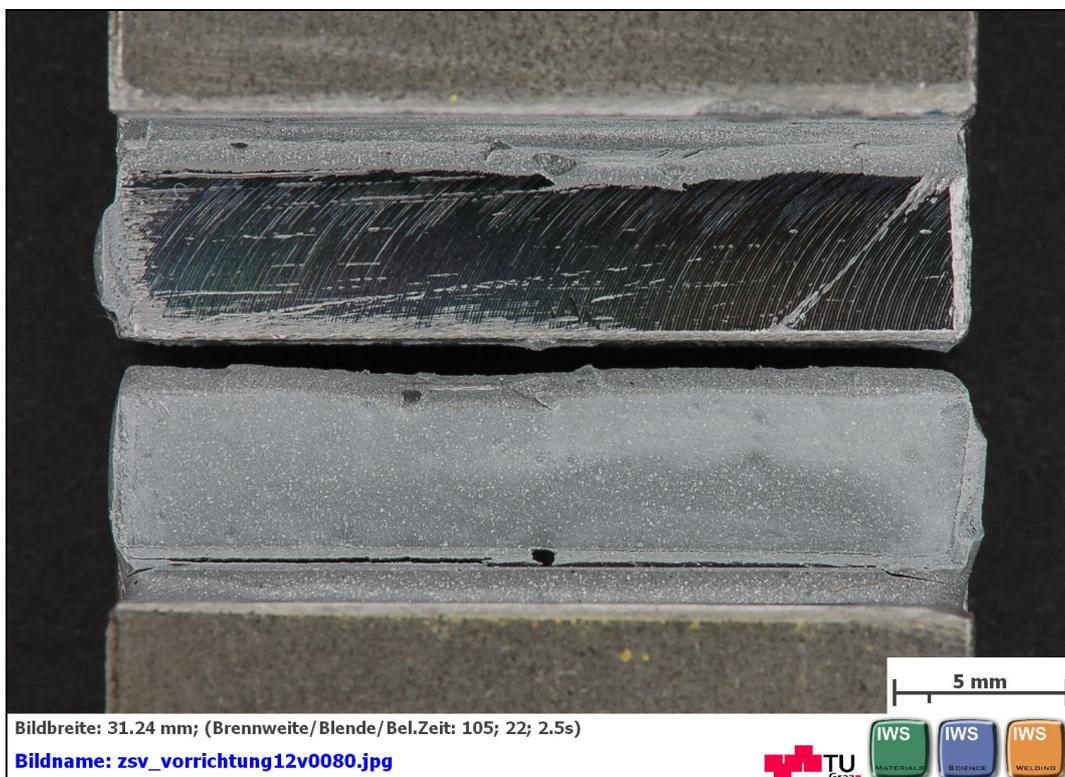
**Abbildung C 92: geklebte Flächen nach dem Zugscherversuch nach EN 14869-2 mit DELO: DELOMONOPOX® 1197 Rautiefe Ra1,6 Probe 1 von 5**
