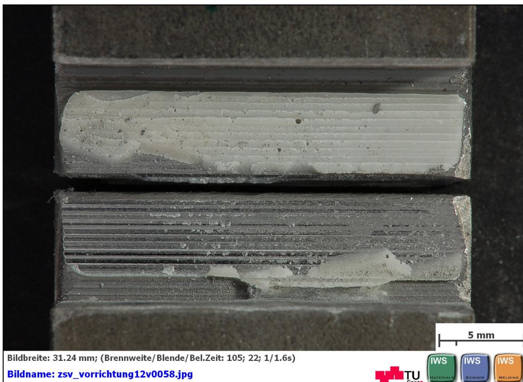
**Abbildung C 48: geklebte Flächen nach dem Zugscherversuch nach EN 14869-2
