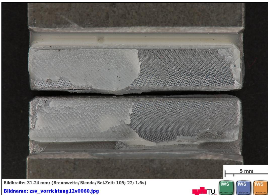
**Abbildung C 52: geklebte Flächen nach dem Zugscherversuch nach EN 14869-2 mit DELO: DELOMONOPOX® AD295 Rautiefe Ra3,2 Probe 1 von 5**
