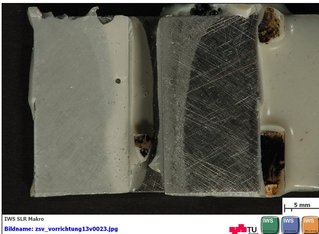
**Abbildung B 96: geklebte Flächen nach dem Zugscherversuch nach EN 1465 mit DELO: DELOMONOPOX® AD295 mit Glaskugeln und Stahlscheiben zur Einhaltung des Klebspaltes Probe 3 von 5**
