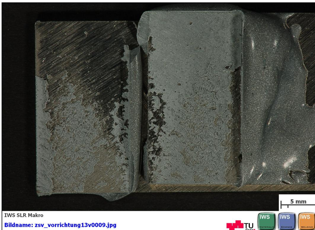
**Abbildung B 68: geklebte Flächen nach dem Zugscherversuch nach EN 1465 mit DELO: DELOMONOPOX® 1197 Probe 4 von 5**
