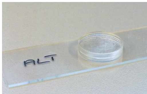
Bild 6.2: FTIR-Probe aus zwei \text{CaF}_2 -Plättchen die das Basisgemisch einschließen
