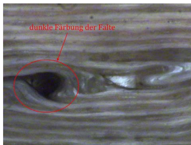
Bild 6.9: Feinschnitt RI 3 - dunkel gefärbte Falte in der Hauptisolierung
