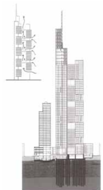
008 Commerzbank Frankfurt: Schema Lüftungssystem; Schnitt; typischer Bürogrundriss [Campi 2000, 181.]
