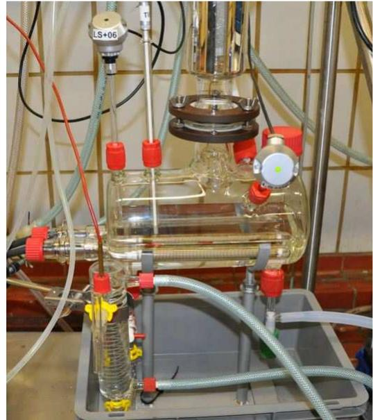
Abbildung 3-1: Sumpfverdampfer der Kolonne
