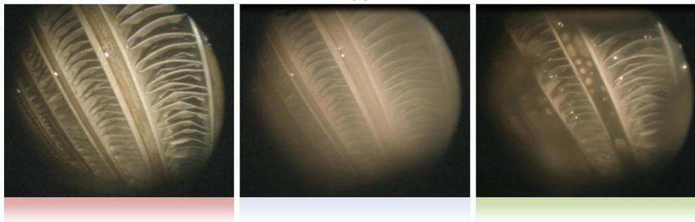
**Abbildung 6.2:** Zustand am Ladungskühleraustritt im FTP-75 bis 750 Sekunden
