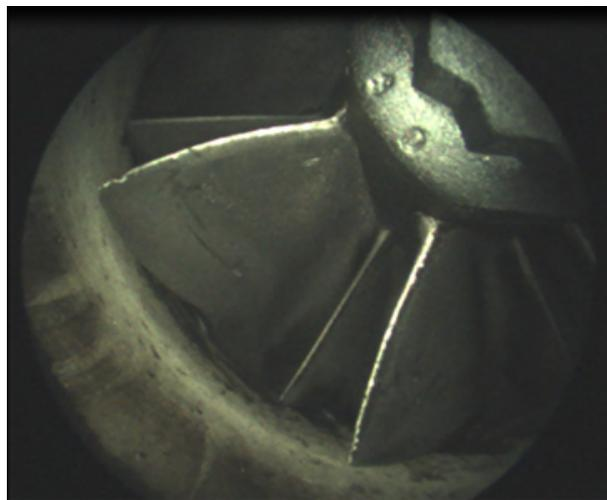
**Abbildung 8.2:** Zustand des Verdichterlaufrads am GTB1752V bei der Kennfeldvermessung
