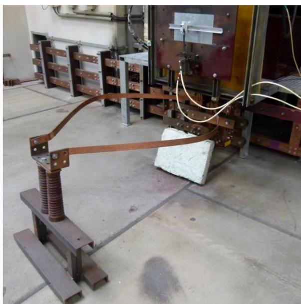
**Abbildung 5.3: Verformte Stromschiene nach einem 25 kA-Kurzschluss [45]**
