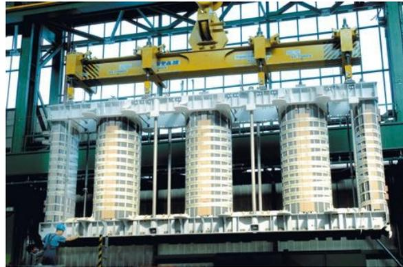
Abbildung 2.14: Eisenkern eines Fünfschenkeltransformators [41]
