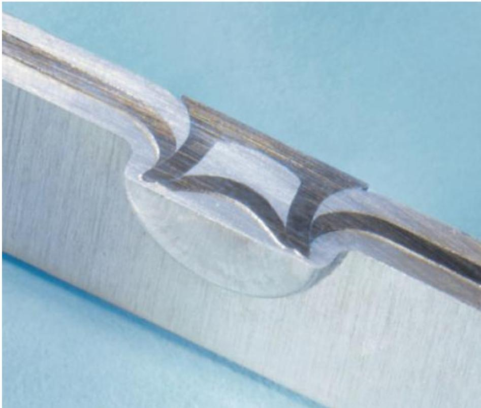
Abbildung 19 Stanznietverbindung [42]
