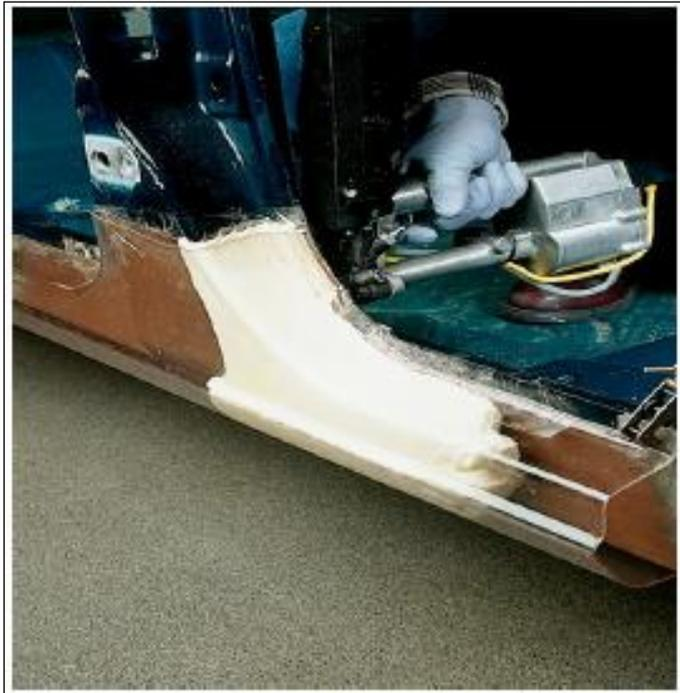
Abbildung 59 Einbringen von Strukturschaum in den Schwellerbereich [57]
