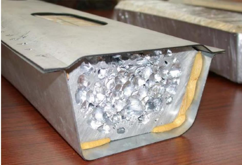
Abbildung 35 Schaumkörper in B-Säule [56]
