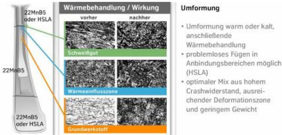
Abbildung 26 Tailored Blanks zur Kalt- und Warmumformung [49]
