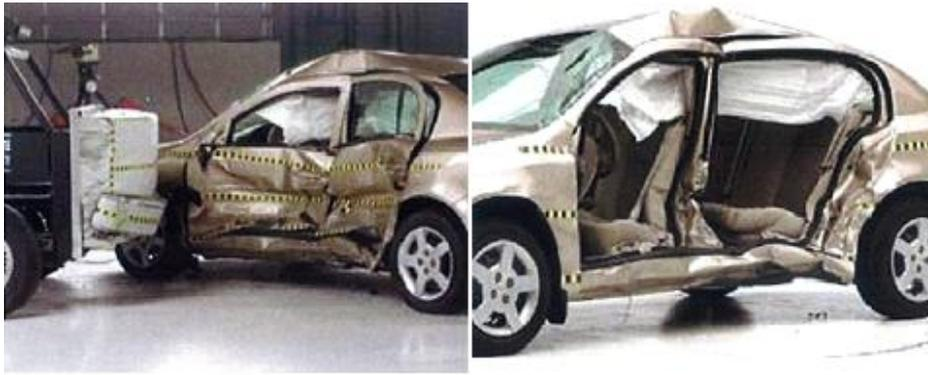
Abbildung 3 Crashtestergebnis nach Seitenaufprall mit einer Barriere mit hohem Angriffspunkt [5]
