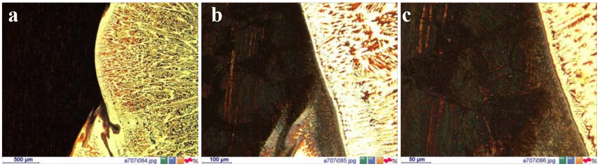
Abbildung 111 a-c) HSDX-MC Ma35 zweilagige Kehlnaht, Detail 2 Schmelzlinie aus Abbildung 109a
