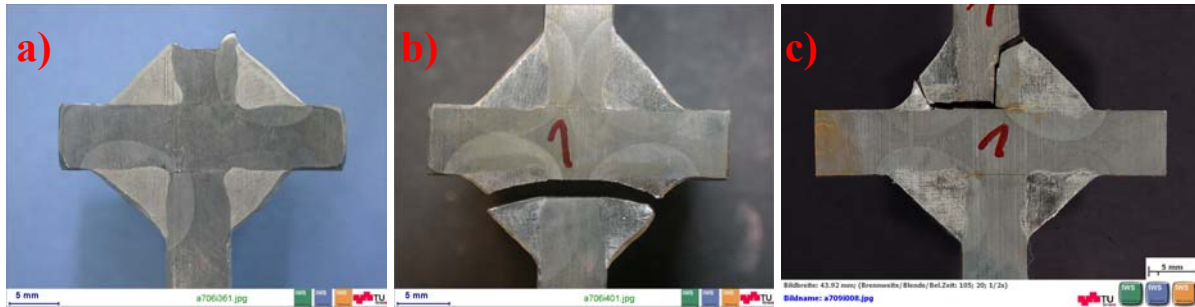
Abbildung 222 Stellen der Risseinleitung; a) Nahtflanke Serie 0 A7-MC, b) Wurzel Serie A ESAB OK Tubrod 15.34, c) Wurzel mit Nahtflanke Serie E HSDX-MC Ma40
