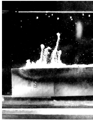
Abbildung 157 Effundierender Wasserstoff aus Schweißnaht 237
