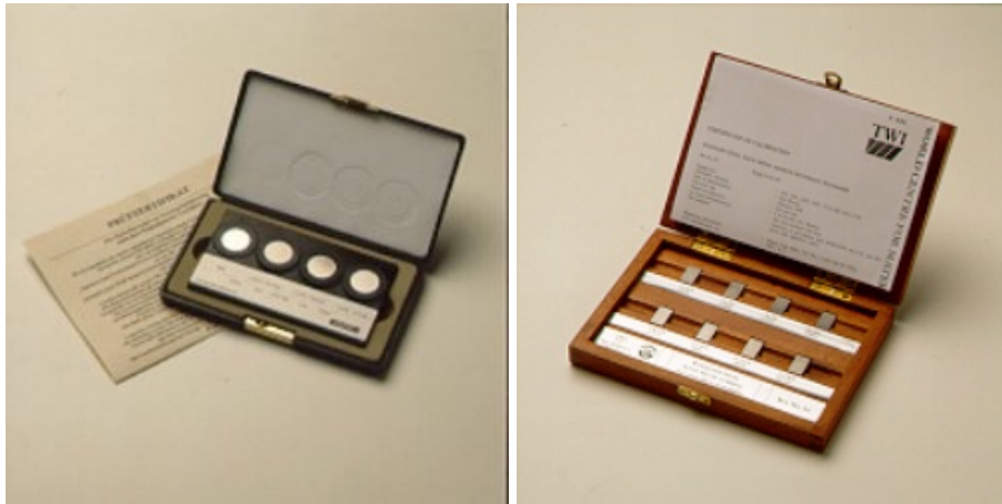
Abbildung 142 Kalibrierplatten für FERITSCOPE® der Fa. Fischer inklusive Zertifikat 214
