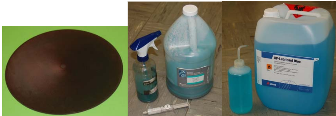
Abbildung 80 NAP-Tuch, Polierpaste und Kühlmedium (Diamantsuspension), von links nach rechts
