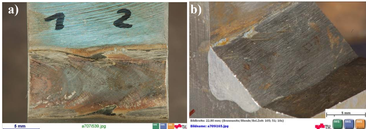
Abbildung 218 Kehlnahtoberflächen: a) nicht verschliffen Serie 0, A, B, C, D; b) verschliffen Serie E
