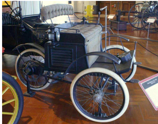
Abbildung 5.5: Riker Electric Tricycle, 1896. Der am Heck angebrachte Elektromotor mit einer Leistung von 3 kW wird von einem unter dem Sitz befindlichen Bleibatteriepaket gespeist. Die Reichweite beträgt etwa 25 km. Quelle: http://www.remarkablecars.com/main/riker/riker.html
