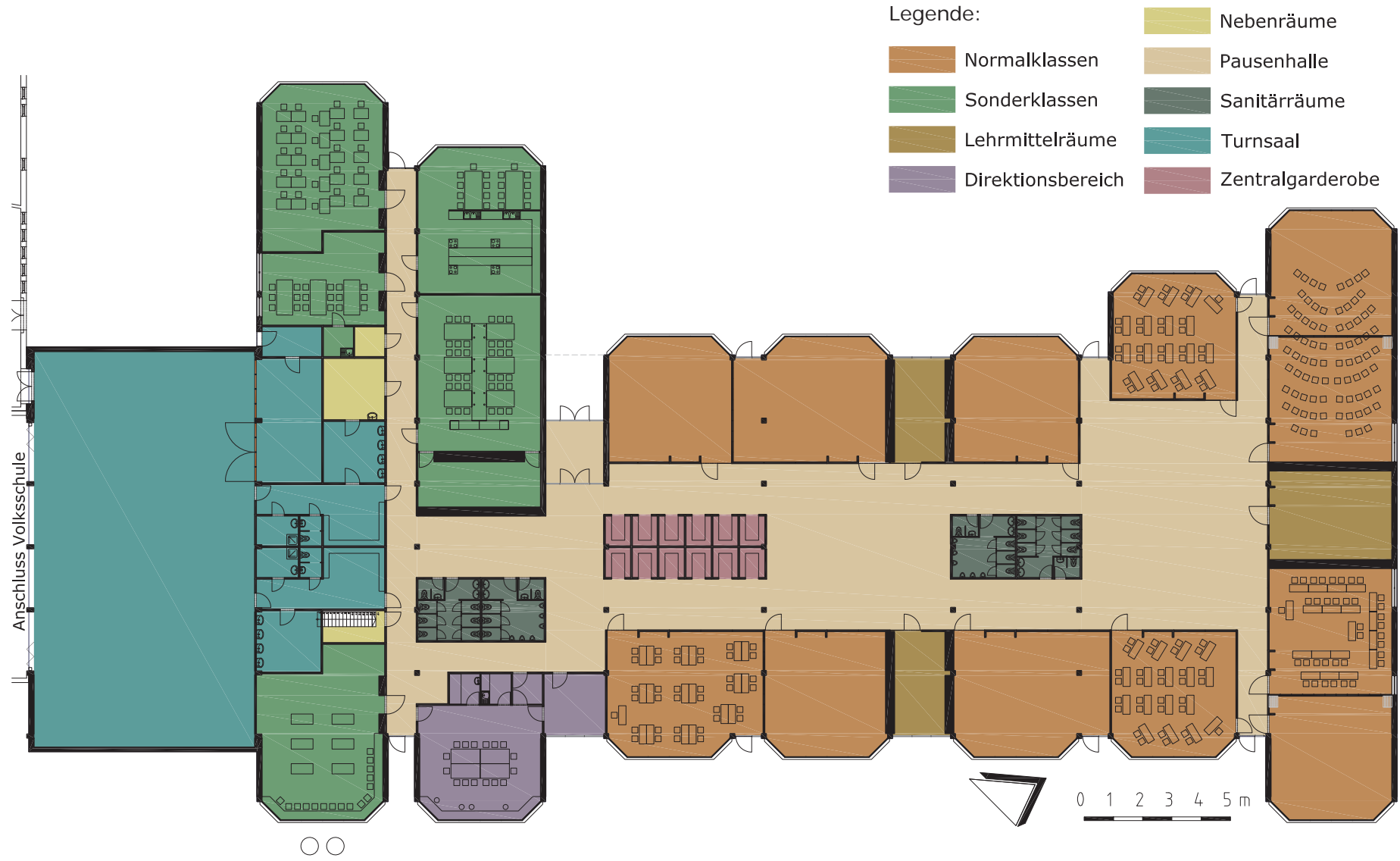
Abbildung 3-12: Grundriss Erdgeschoss, Zonierung - Hauptschule Mitterdorf i. M.
