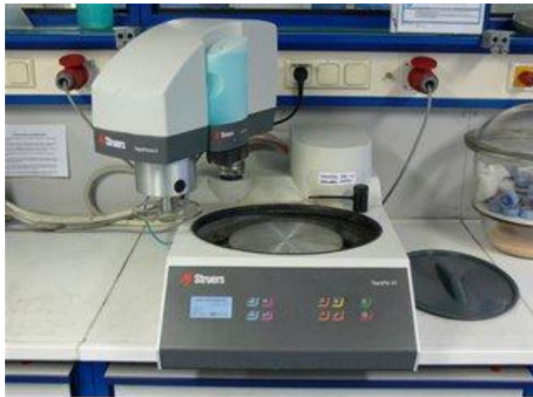
Abbildung 4.57: Poliersystem Typ Struers Tegrapol-21, Tegraforce-5 . Programmierbare Präparationsparameter, Andruckkraft 5-300 N, Drehteller Ø 250 mm, Probenhalter für 6 Einzelproben.
