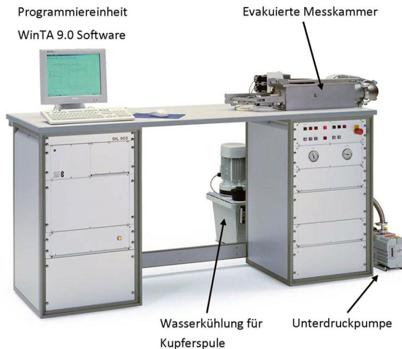
Abbildung 4.53: Eingesetztes Abschreck- und Umformdilatometer (Typ: Bähr 805 AD [36]).
