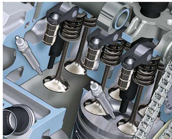
**Abbildung 3.1:** Geometrische Auslegung des Brennraums [21]
