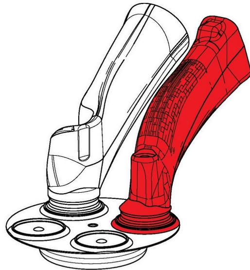
**Abbildung 4.14:** AGR-Führung über Tangentialkanal (rot)
