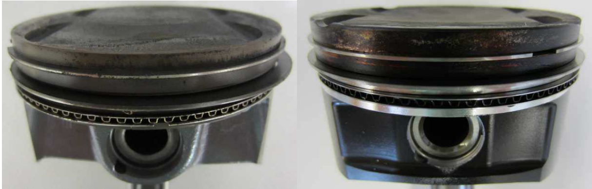
Abbildung 4-5: Serienkolben (links) und Rennkolben (rechts)
