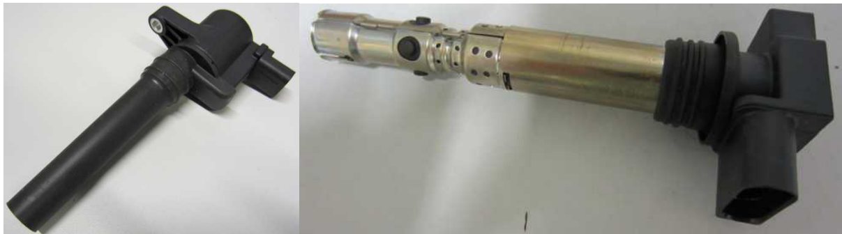
Abbildung 4-7: Serienzündspule (links) und nachgerüstete Zündspule (rechts)
