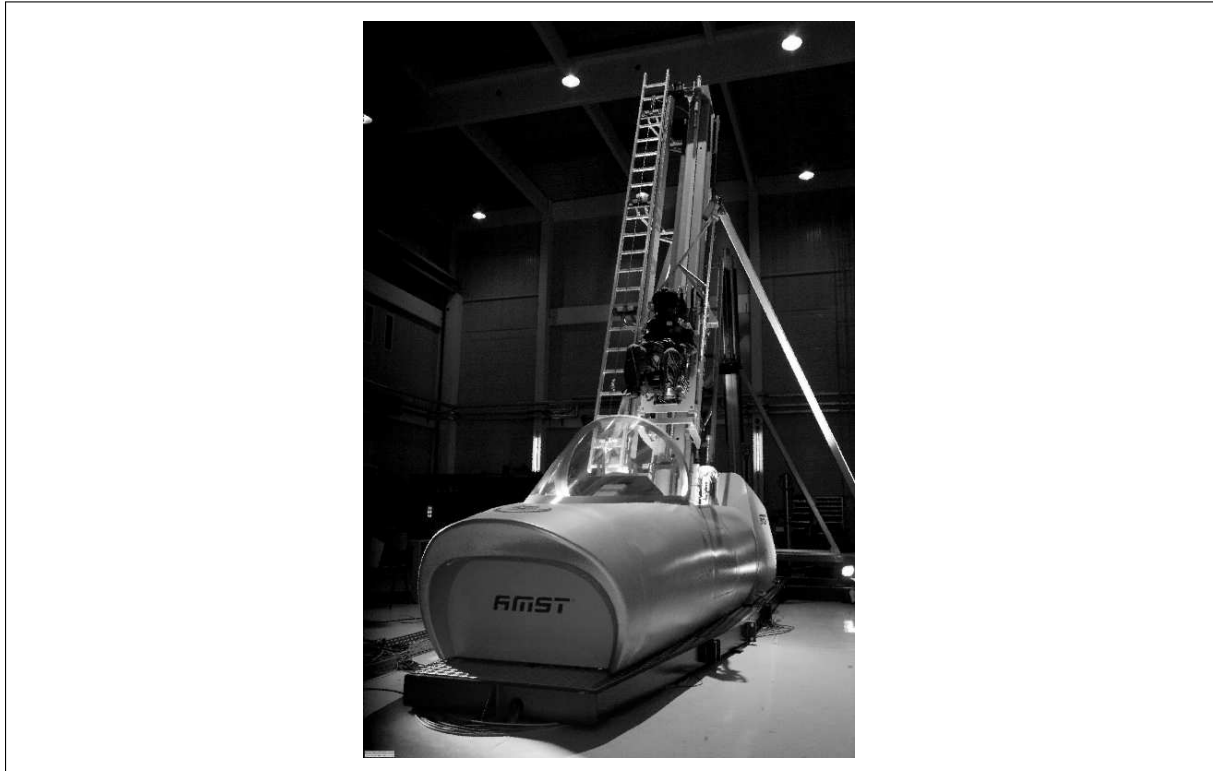
Abbildung 17: Der Schleudersitzsimulator der Firma AMST-Systemtechnik GmbH 93
