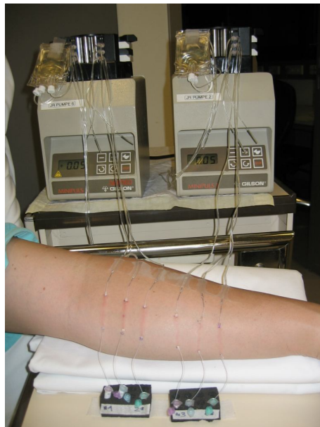
Abb. 23 Versuchsaufbau „Schwerkraft“-Samplingsystem zur Durchführung des in vivo Flussratentests
