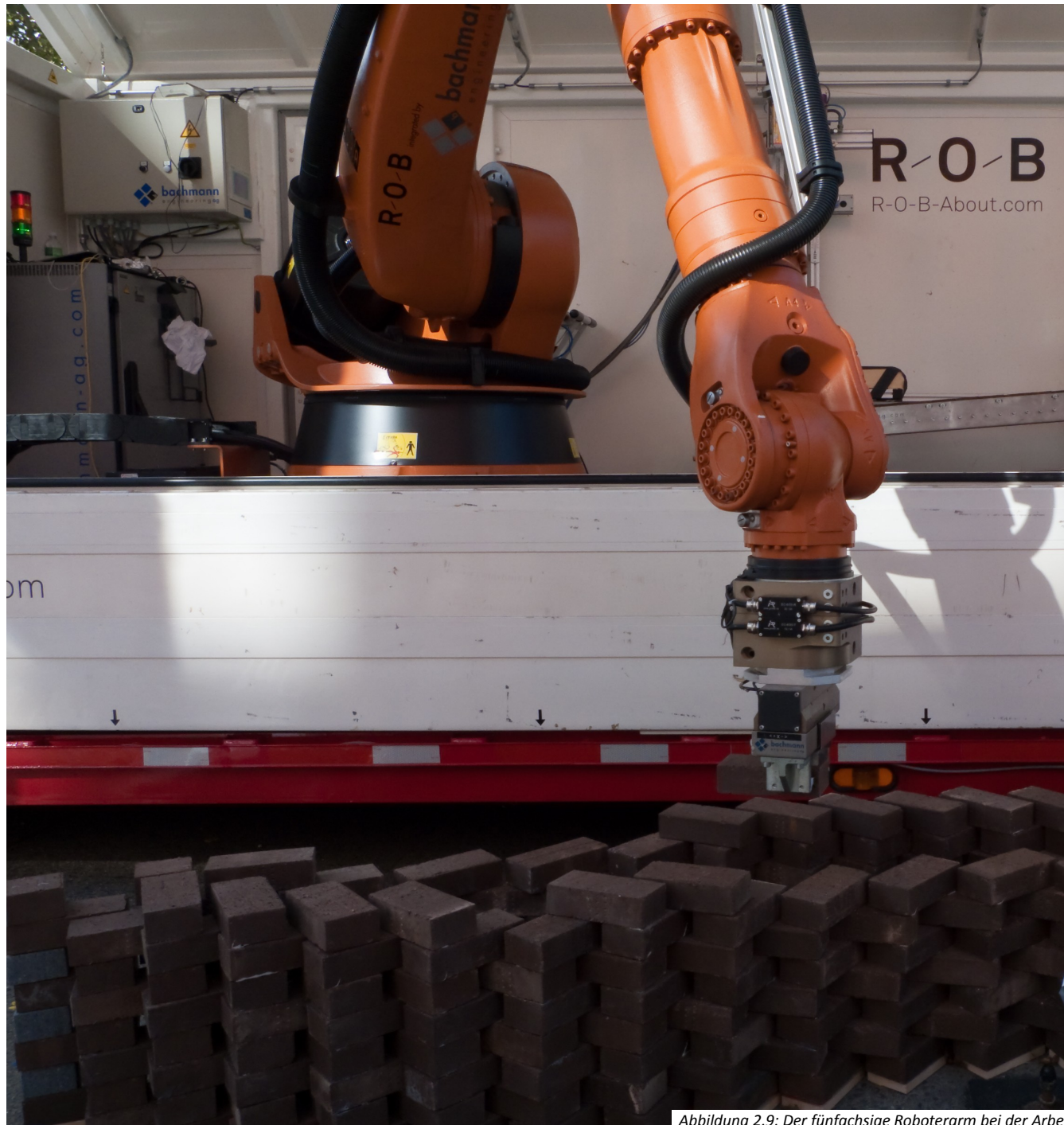
Abbildung 2.9: Der fünfachsigse Roboterarm bei der Arbeit
