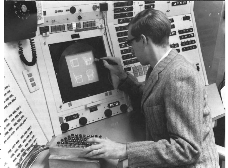
Abbildung 2.4: Ivan Sutherland bei der Präsentation seines Sketchpad Programmes auf dem TX-2 Rechner des MIT. Das System war mit einem CRT-Bildschirm, einem Lichtstift und einer Schalterkonsole für die Bedienung des Programmes ausgestattet.
