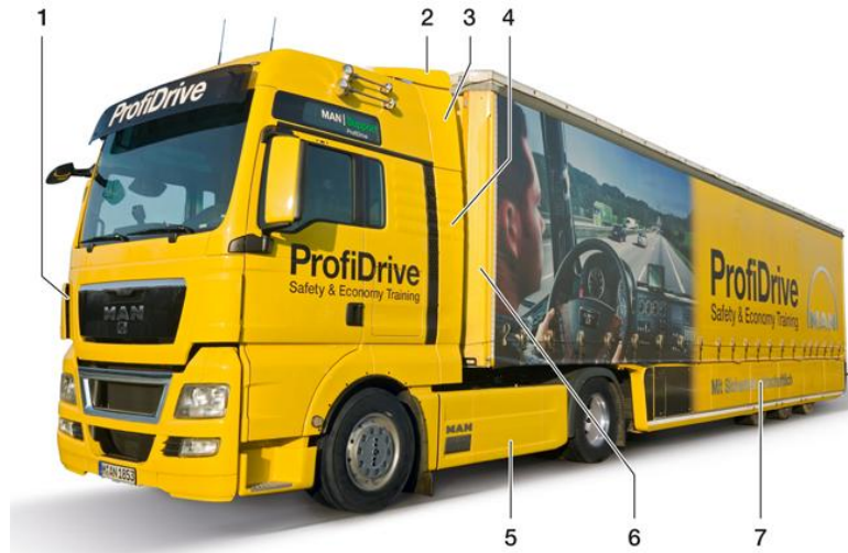
Abbildung 3.8: Aerodynamisch relevante Bauteile an einem vollverkleideten Sattelzug [7]
