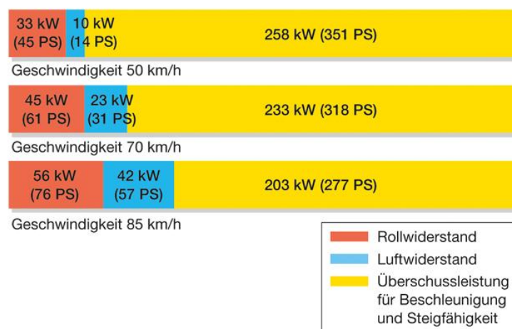
Abbildung 3.4: Anteile von Rollwiderstand, Luftwiderstand und Überschussleistung eines 40t Sattelzugs [3]
