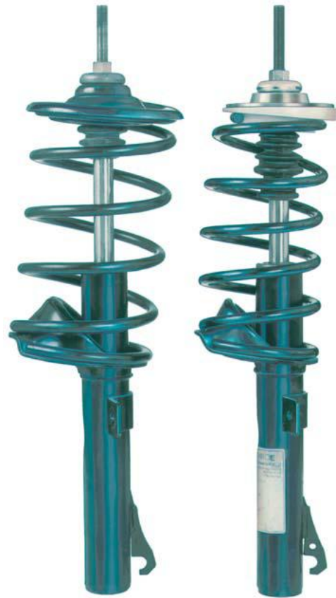
Bild 2.29: Konventionelles Federbein (links) und Side-Load-Feder (rechts) [5]
