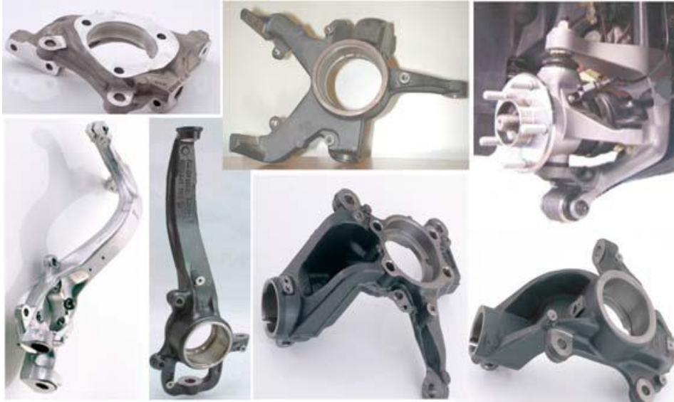
Bild 2.7: Ausführungsbeispiele von Radträgern angetriebener Vorderachsen [5]
