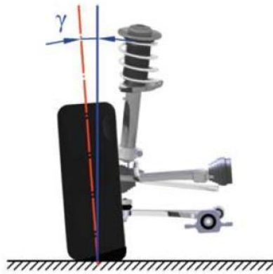
Bild 2.15: Radsturz \gamma nach ISO 612/DIN 70000 [5]
