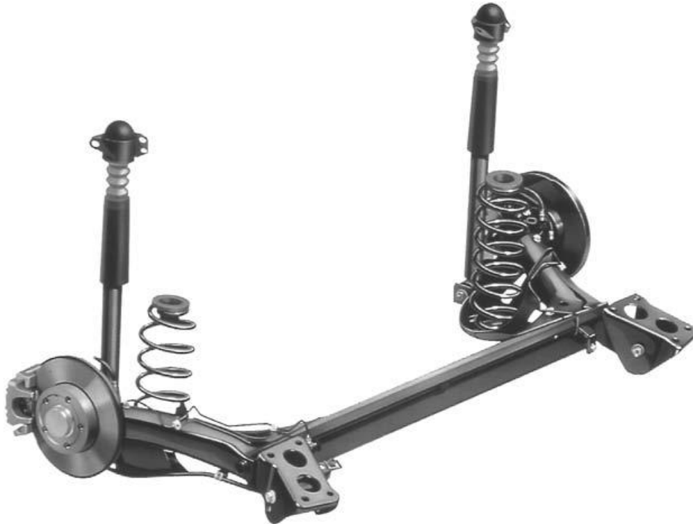
Bild 2.25: Ausführungsbeispiel einer Verbundlenkerachse [16]
