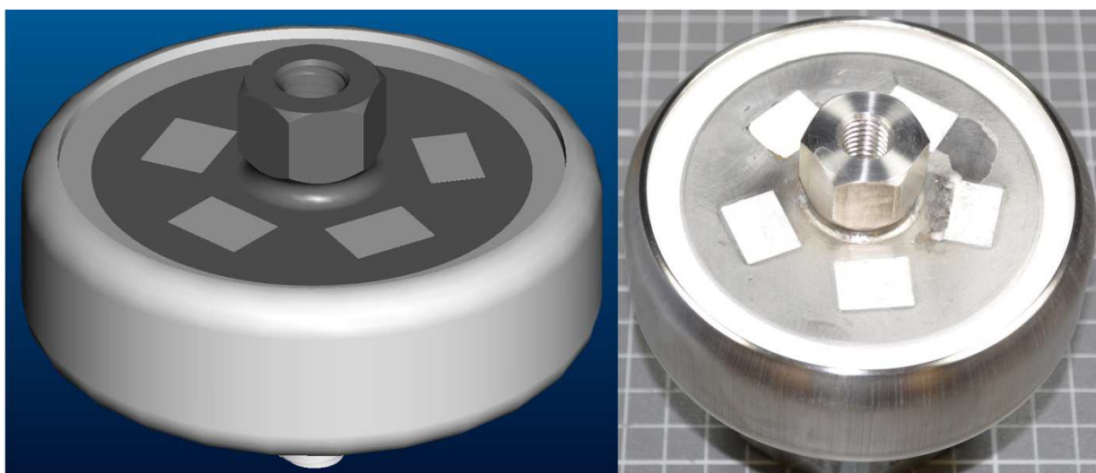
Abb. 33 Die Vergussmasse aus Aluminiumoxid wurde eingebracht
