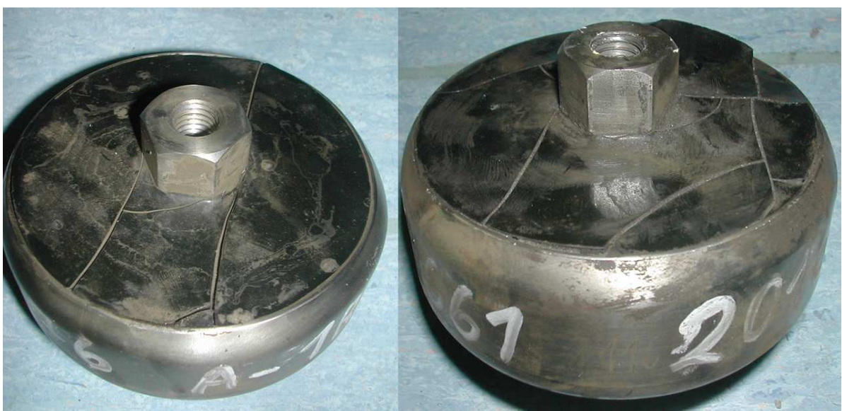
Abb. 71: Risse in der Deckmasse der Schutzwiderstände
