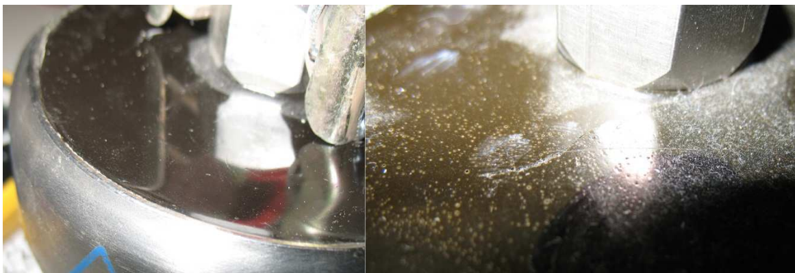
Abb. 70: linke Seite: neuwertige Deckmasse - rechte Seite: Blasen und Risse in identischer Deckmasse nach 5h/170 °C
