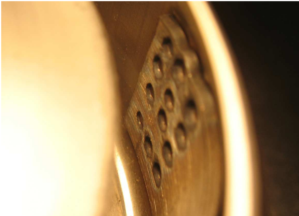
Abb. 76: Stelle des Schweißpunktes der Wendel im Gehäuse (20 mm x 15 mm)
