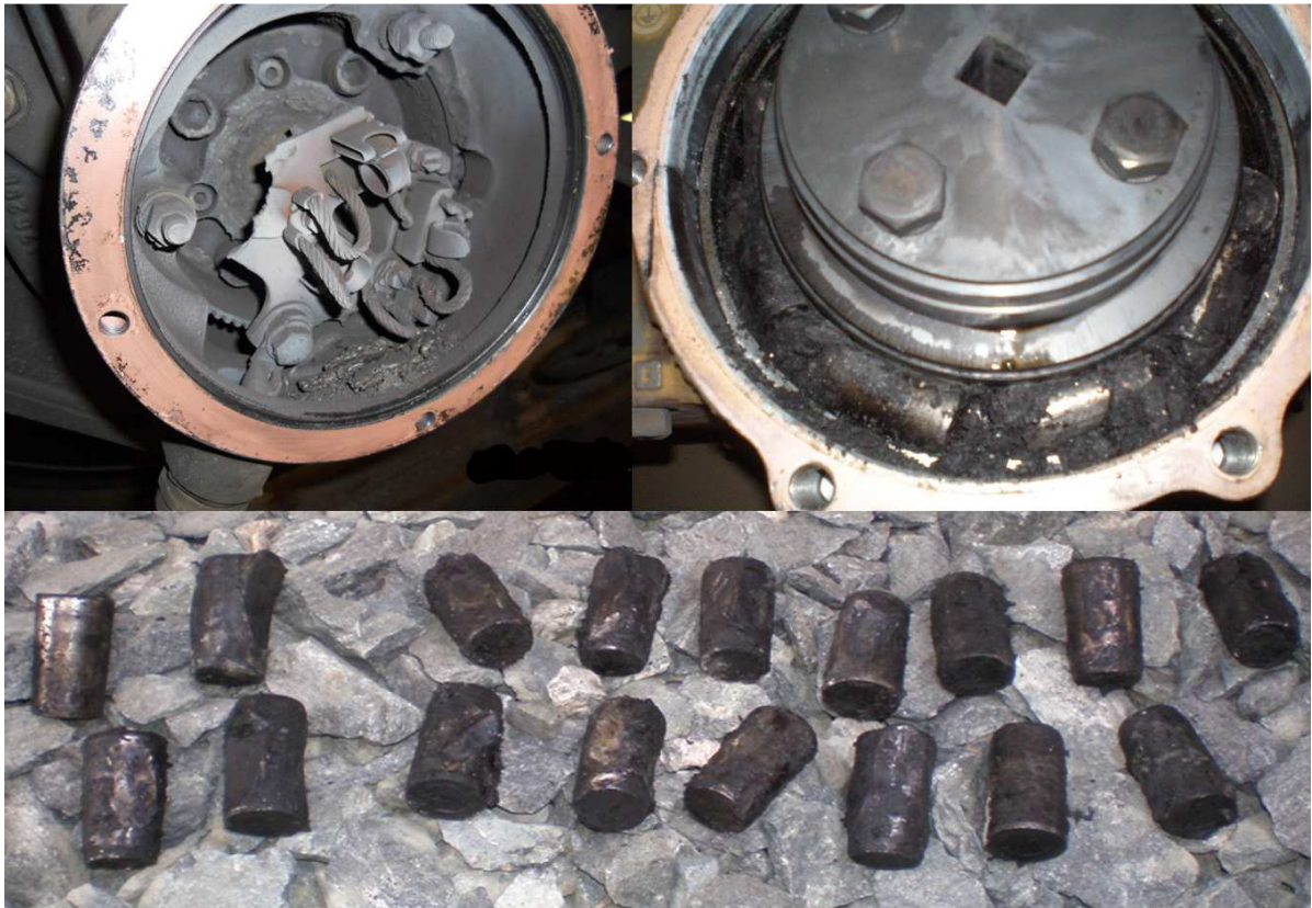
Abb. 13: Ein durch Strom zerstörter Erdungskontakt (li) und ein zerstörtes Lager mit Wälzkörpern (re)
