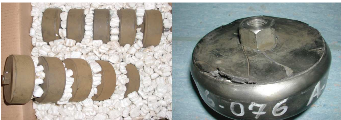
Abb. 30: Defekte Schutzwiderstände - links: Typ A / rechts: Typ B
