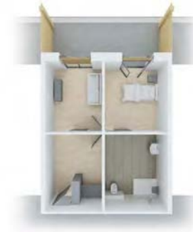
Barrierefreies Wohnmodul mit Loggia im Erdgeschoss
