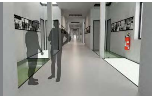
Erschließungsbereich vor den Mannschaftsunterkünften im 1. Obergeschoss mit den Glasbodenelementen zur natürlichen Belichtung der Gangzone
