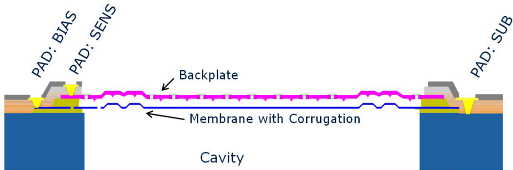
Abbildung 3.2.: Schematischer Aufbau eines MEMS Mikrofons
