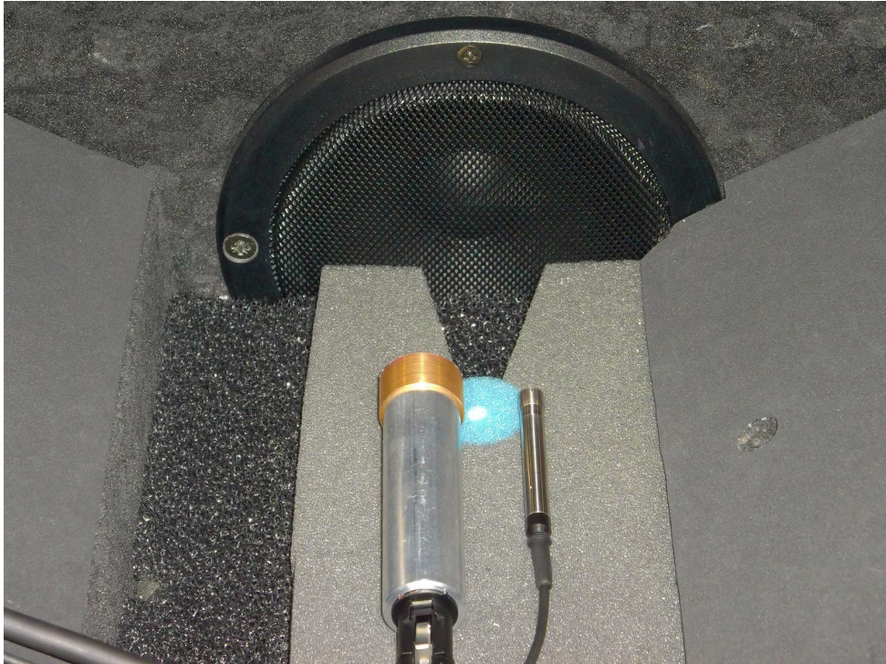
Abbildung 5.21.: Anordnung der Messmikrofone
