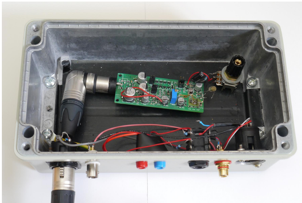
Abbildung 4.12.: Versuchsaufbau zur Rauschmessung
