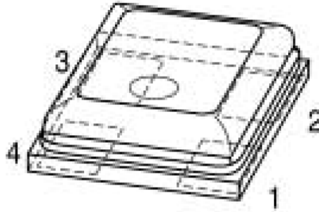
Abbildung 3.6.: MEMS mit ASIC im gemeinsamen Package
