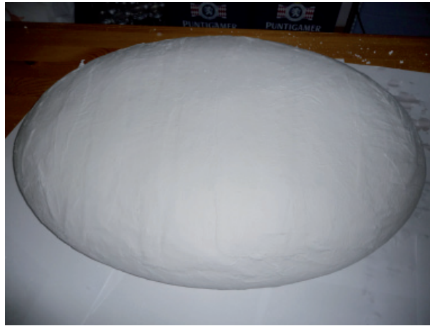
Abb. 124: Mit Gipsbandagen eine Hülle bilden
