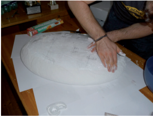
Abb. 123: Form mit Frischhaltefolie einwickeln, damit dem Gips kein Wasser entzogen wird
