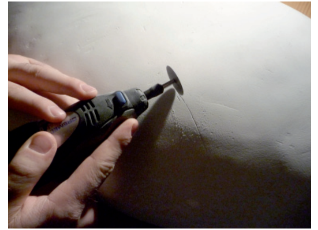
Abb. 134: Einfräsen der Eisspuren
