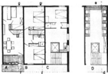
A-planta inferior de la vivenda. B-planta superior de la vivenda. C-escala i vivenda porters D-safrerixos
