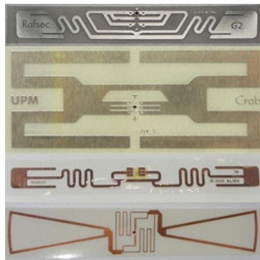
Abbildung 3.4: UHF Antengeometrie [22]
