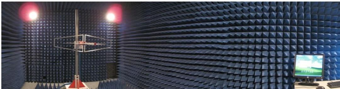
Abbildung 3.9: Absorberkammer (Anechoic chamber) [20]
