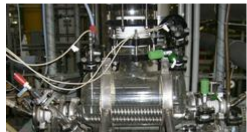
Abbildung 3.2: Praktikumskolonne Kettle Reboiler [16]
