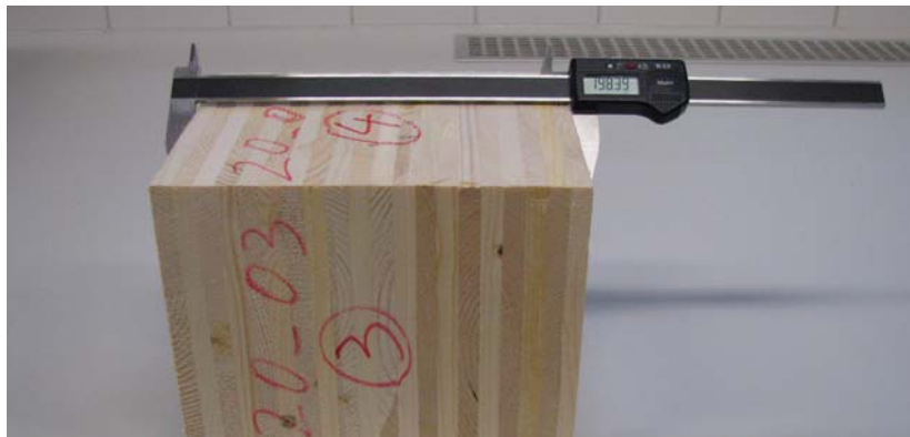
Abb. 4.2 Digitale Schiebelehre des Lignum Test Centers der Technischen Universität Graz.
