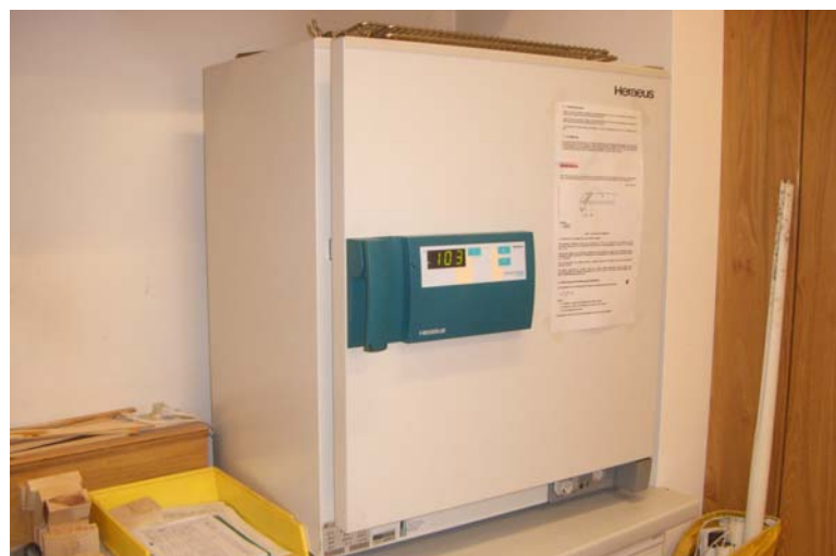
Abb. 4.12 Darrschrank des Lignum Test Centers der Technischen Universität Graz.
