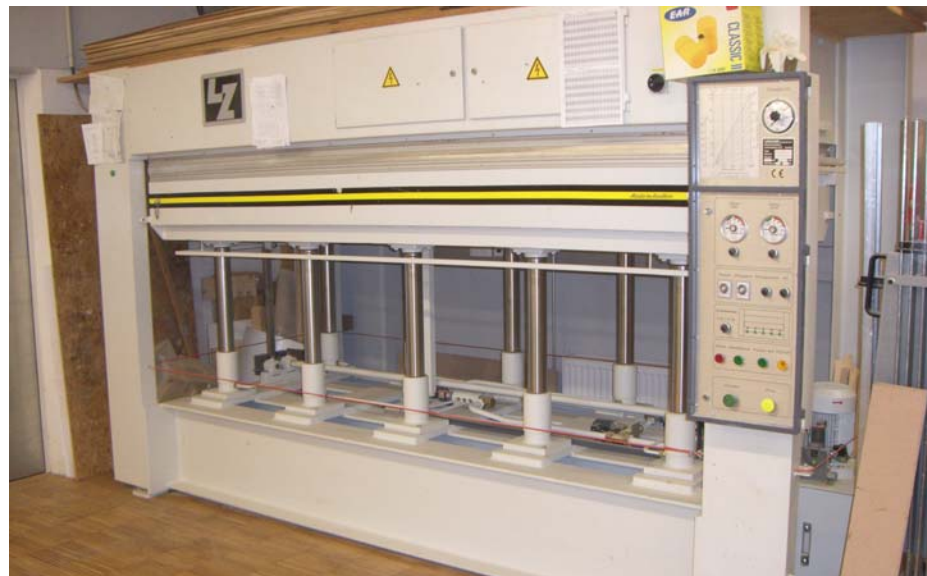
Abb. 4.9 Hydraulische Heizplattenpresse des Lignum Test Centers der Technischen Universität Graz.
