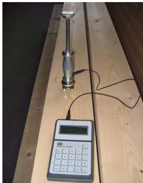
Abb. 4.5 Holzfeuchtemessgerät des Lignum Test Centers der Technischen Universität Graz.
