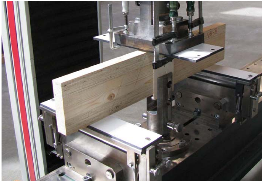
Abb. 3.6 eingebauter Prüfkörper; Prüfgerät: Universalprüfmaschine Lignum_uni_275, Lignum Test Center, Institut für Holzbau und Holztechnologie, Technischen Universität Graz
