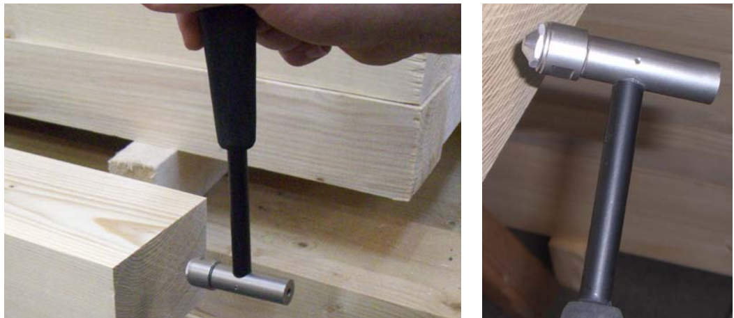
Abb. 4.6 Für die Frequenzmessung eingesetzter Impulshammer.
