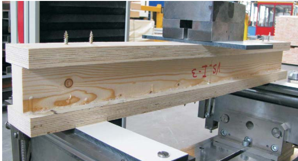
Abb. 3.11 I-Träger (Vorversuchsreihe II), eingebaut im Prüfgerät Universalprüfmaschine Lignum_uni_275, Lignum Test Center, Institut für Holzbau und Holztechnologie, Technischen Universität Graz
