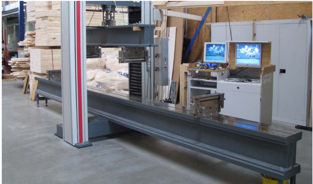
Abb. 4.11 Universalprüfmaschine des Lignum Test Centers der Technischen Universität Graz.
