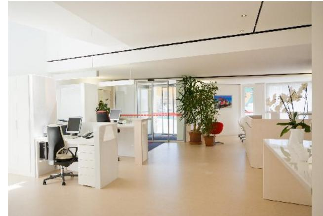
Abbildung 110: Über die Schattenfugen wird die Zuluft in den Raum eingebracht.
