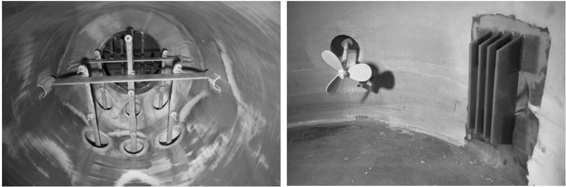
Abbildung 4-14: Prozesswasserdüsen des sauren Wäschers (links) und Wäschersumpf des SO 2 -Wäschers mit Rührwerk und Strömungsbrechern (rechts) des Wirbelschichtofens 4 der FWW
